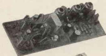
**Ricevitore a transistori per la gamma dei 10 metri**
