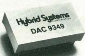
ingressi binari, offset binari o BCD. Il funzionamento può avvenire o con un riferimento interno di precisione o con una sorgente esterna a -10V. Il settling time nel peggiore dei casi è 15 $\mu$ s, e la linearità entro  $\pm 0,0125\%$  viene conservata in tutto il range di temperatura da 0 a +70°C. Il DAC 9349 richiede  $\pm 15V$  come alimentazione e ha un consumo massimo di 300 mW.
