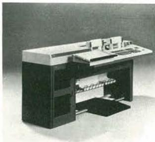
peculiari del modello P312. La capacità di memoria è pari a 16 o 32 Kbytes, la lunghezza delle parole è variabile e il sistema di programmazione è il PHOCAL.
