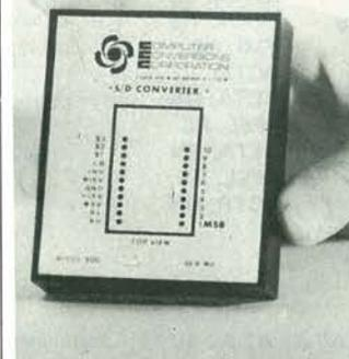
Hz, che possono seguire velocità di ingresso di 36.000/s senza aumento dell'errore introdotto. I moduli SDC 410 ST misurano 66 x 79 x 11 mm e sono stati realizzati in modo da essere adatti per il montaggio su schede a circuito stampato. Essi convertono ingressi sincro o
