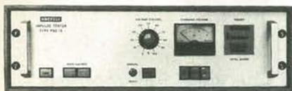
Proprio per indagare sugli effetti di questi transistori la Haefely ha messo a punto un tester standard, il generatore PSD 15, le cui caratteristiche possono essere modificate entro certi limiti secondo le esigenze di prova dell'utente.
