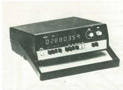
frequenze di impulsi che si ripetono con tempi dell'ordine di 15  $\mu$ s. Un'opzione Digital "input/output" rende inoltre lo strumento comandabile a distanza e può presentare sull'uscita tutti i dati in BCD.
