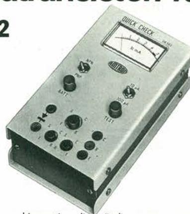
Un apparecchio pratico, di facile uso, leggero, portatile. Misura il beta dei transistori NPN e PNP, e fornisce una chiara indicazione della funzionalità di transistori e
