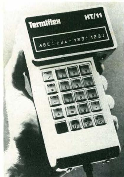
I terminali sono forniti muniti di cavo con connettore standard da permettere il plug-in da parte dell'operatore, ottenere la richiesta informazione, inviare l'eventuale messaggio e procedere verso una diversa locazione portando con se il terminale. Tra le sue applicazioni tipiche ci sono i sistemi di test, magazzino, controllo di processo, lettura di dati di consumo di energia, training su simulatori, ecc...
