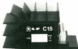
Il circuito amplificatore è affogato in una speciale resina protettiva e incapsulato in un dissipatore che lo rende compatto e robusto, come tutti i prodotti audio ILP.
