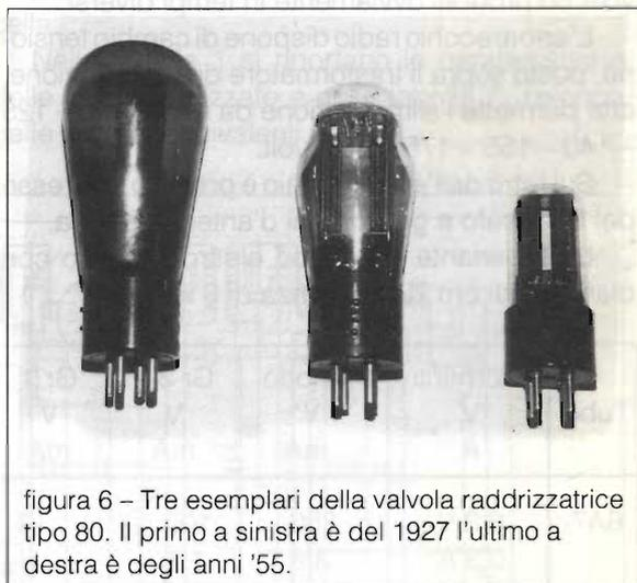
figura 6 – Tre esemplari della valvola raddrizzatrice tipo 80. Il primo a sinistra è del 1927 l'ultimo a destra è degli anni '55.
