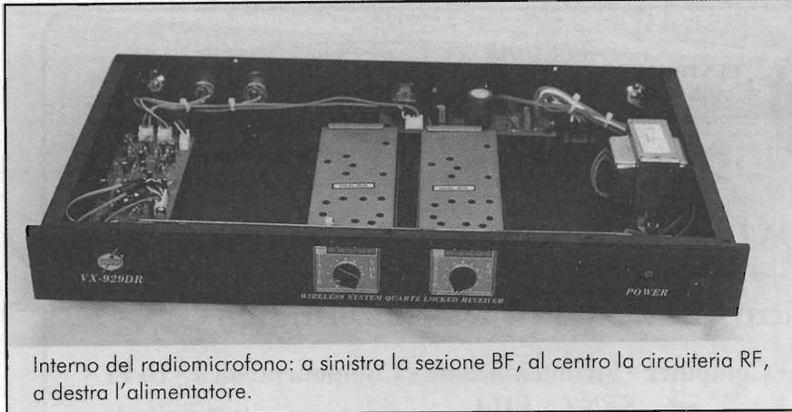
Interno del radiomicrofono: a sinistra la sezione BF, al centro la circuiteria RF, a destra l'alimentatore.
