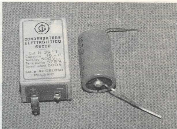
Foto 4 - Condensatore elettrolitico a pacchetto GeloSO anni '35/60, del quale si recupera il contenitore per inserirci dentro il nuovo elettrolitico.
