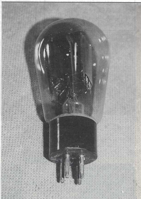
Foto 6 - Valvola raddrizzatrice Philips WE 54 anni '30.
