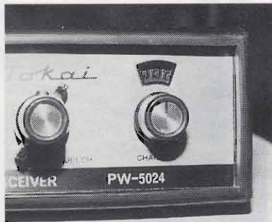
Foto 2 - Tokai PW5024: particolare dell'indicatore del canale con i numeri in rilievo.
