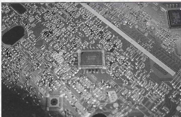
Foto 4 - Il processore video LA 71594M.
