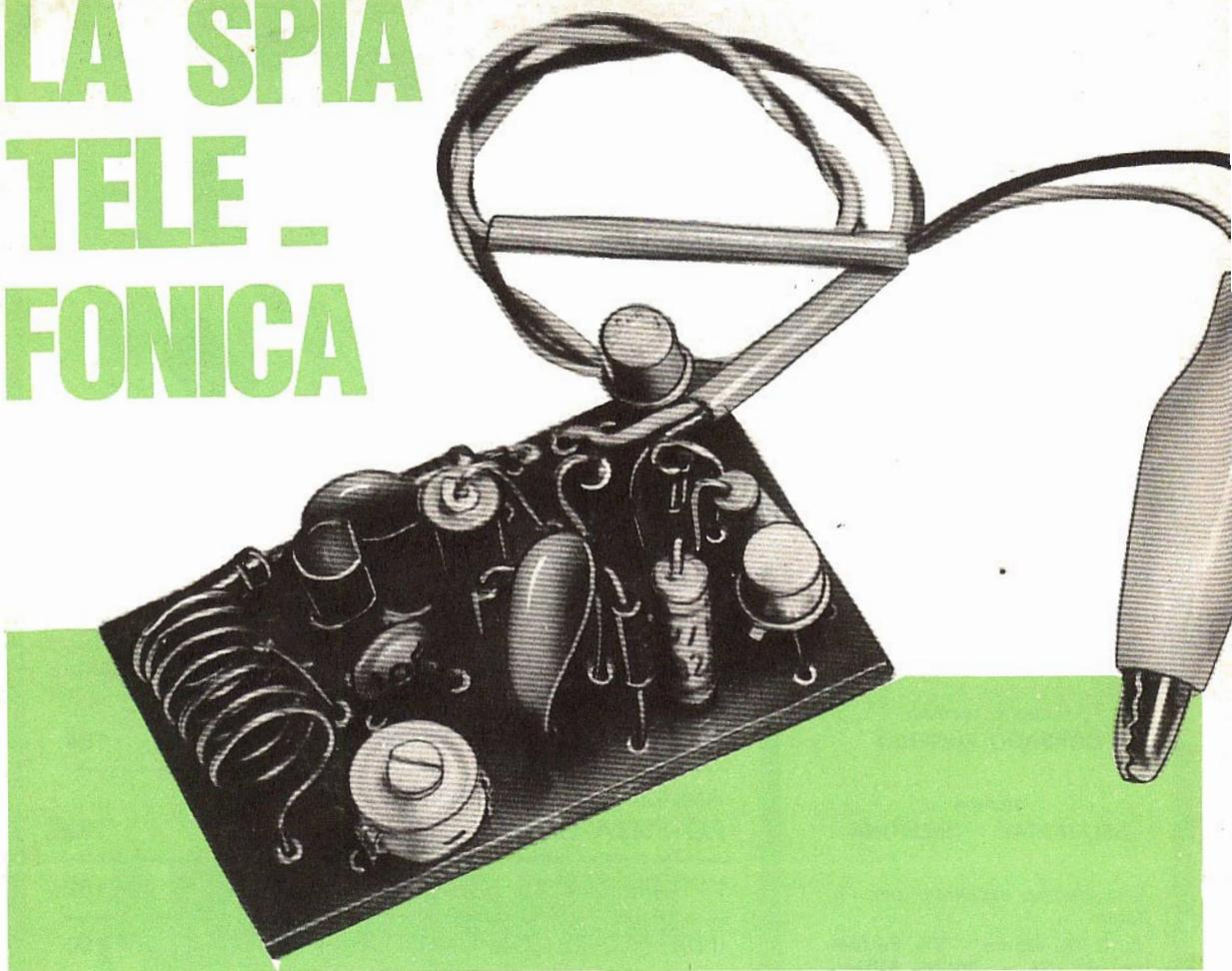
**Su una superficie di dieci centimetri quadrati, appena, abbiamo concentrato il circuito di una microtrasmittente e quello di un interruttore elettronico che fa entrare in funzione l'apparato soltanto quando è in atto una conversazione telefonica.**
