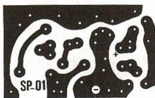
Fig. 6 - Circuito stampato della spia telefonica riprodotto in dimensioni naturali, cioè in scala 1/1.
