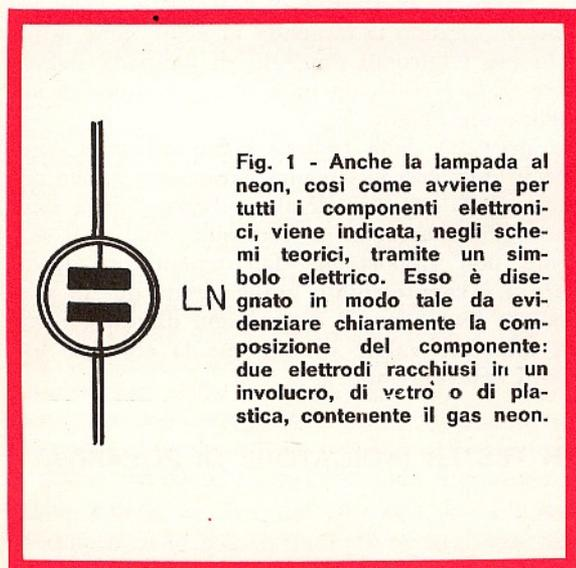
Fig. 1 - Anche la lampada al neon, così come avviene per tutti i componenti elettronici, viene indicata, negli schemi teorici, tramite un simbolo elettrico. Esso è disegnato in modo tale da evidenziare chiaramente la composizione del componente: due elettrodi racchiusi in un involucro, di vetro o di plastica, contenente il gas neon.
