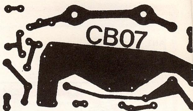
Fig. 3 - Circuito stampato, riprodotto in grandezza naturale, necessario per la realizzazione del sintonizzatore CB.
