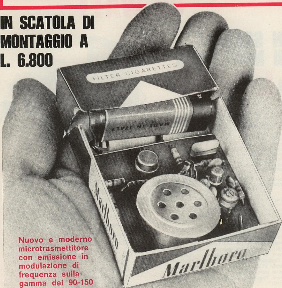
**Nuovo e moderno microtrasmettitore con emissione in modulazione di frequenza sulla gamma dei 90-150 MHz. Sensibilità regolabile per le due diverse condizioni d'uso dell'apparato: per captare suoni deboli e lontani dal microfono, oppure suoni forti in prossimità del microfono. Alimentazione con pila a 9 V. Dimensioni pari a quelle di un normale pacchetto di sigarette. Facilità di montaggio e di messa a punto.**
