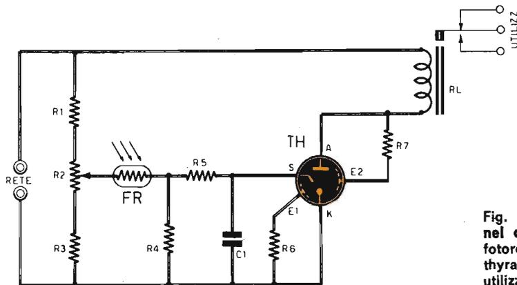
Fig. 7 - Questo progetto, nel quale si fa uso della fotoresistenza FR e del thyatron TH, può essere utilizzato come elemento di controllo di fiamma; il relé RL pilota la valvola di afflusso di combustibile in un bruciatore.
