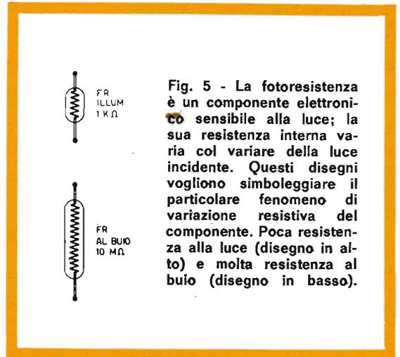
Fig. 5 - La fotoresistenza è un componente elettronico sensibile alla luce; la sua resistenza interna varia col variare della luce incidente. Questi disegni vogliono simboleggiare il particolare fenomeno di variazione resistiva del componente. Poca resistenza alla luce (disegno in alto) e molta resistenza al buio (disegno in basso).
