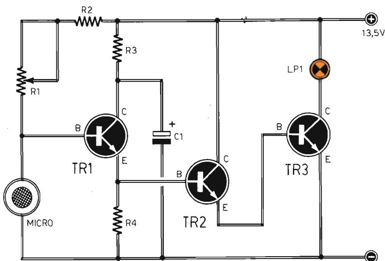
Fig. 6 - Schema elettrico dell'apparato trasmettitore. L'entrata del circuito è rappresentata da un microfono di tipo piezoelettrico; l'uscita è rappresentata da una lampada per auto (LP1) da 12 V - 20 W. L'alimentazione in tensione continua da 13,5 V, deve essere in grado di erogare la corrente massima di 3 A; a tale scopo è necessario servirsi di un accumulatore per auto o di un apposito alimentatore da rete.
