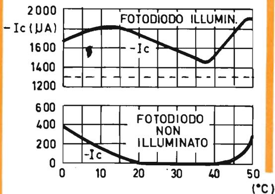
Fig. 11 - I diagrammi qui riportati interpretano il fenomeno di variazione della corrente che attraversa il fotodiode al variare della temperatura.
