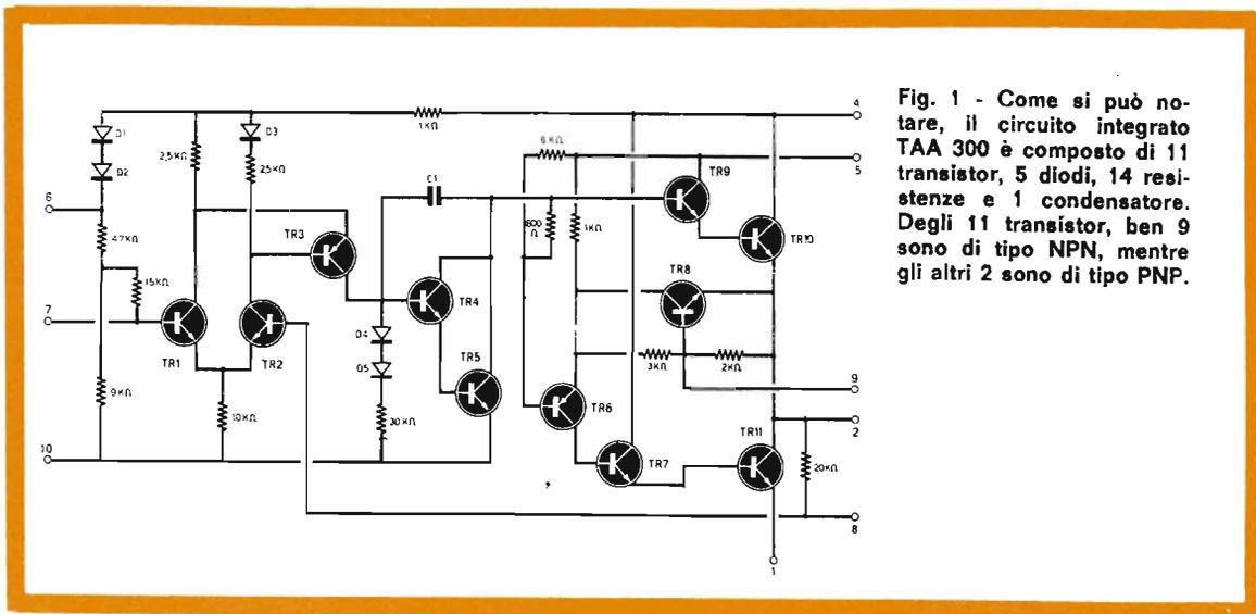
Fig. 1 - Come si può notare, il circuito integrato TAA 300 è composto di 11 transistor, 5 diodi, 14 resistenze e 1 condensatore. Degli 11 transistor, ben 9 sono di tipo NPN, mentre gli altri 2 sono di tipo PNP.
