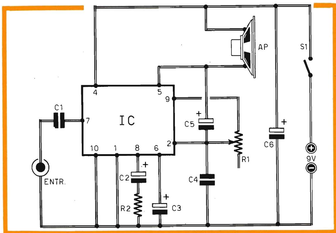
Fig. 2 - Schema elettrico del circuito di applicazione dell'integrato TAA 300, che permette di realizzare un amplificatore di bassa frequenza con potenza di uscita di 1 W. L'alimentazione è di tipo a pila da 9 V.
