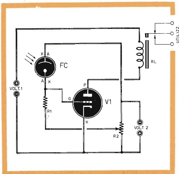
Fig. 3 - Questo secondo tipo di circuito di impiego della fotocellula può essere utilizzato come interruttore automatico crepuscolare. Lo schema e il funzionamento sono analoghi a quelli del progetto di figura 2. L'unica variante consiste nella diversa polarizzazione della fotocellula FC.
