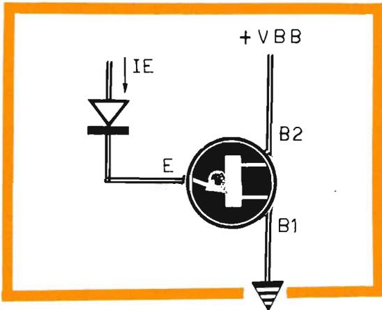
Fig. 2 - Per comodità interpretativa, conviene disegnare a parte il simbolo del diodo rappresentativo della giunzione PN, come se si trattasse di un elemento esterno all'UJT.
