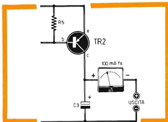
Fig. 5 - Per conferire all'apparecchio di ricarica delle pile al nichel-cadmio un aspetto maggiormente professionale, conviene inserire, in serie con il conduttore d'uscita della tensione positiva, un milliamperometro da 100 mA fondo-scala.
