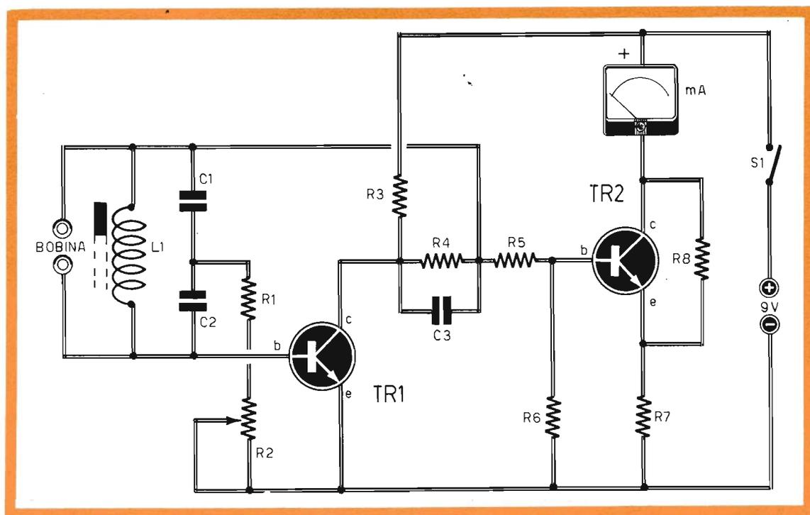
Fig. 1 - L'elemento fondamentale del progetto del circuito di controllo delle bobine è rappresentato dall'oscillatore di Colpitt, che fa uso di una bobina di deviazione orizzontale di televisore (L1).
