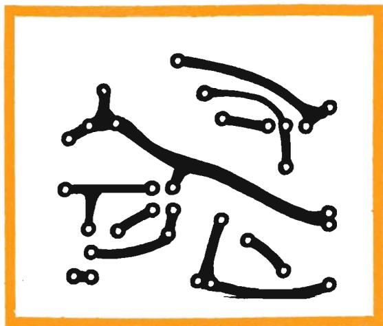
Fig. 3 - Circuito stampato a grandezza naturale necessario per la composizione del cablaggio del generatore di frequenza.
