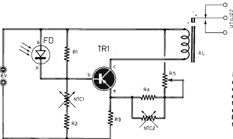
Fig. 10 - Questo progetto utilizza il fotodiode FD e due resistenze NTC, cioè due resistenze a coefficiente negativo, il cui valore resistivo diminuisce con l'aumentare della temperatura.
