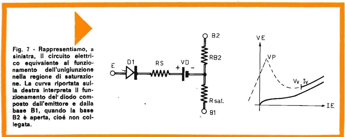
Fig. 7 - Rappresentiamo, a sinistra, il circuito elettrico equivalente al funzionamento dell'unigiunzione nella regione di saturazione. La curva riportata sulla destra interpreta il funzionamento del diodo composto dall'emittore e dalla base B1, quando la base B2 è aperta, cioè non collegata.
