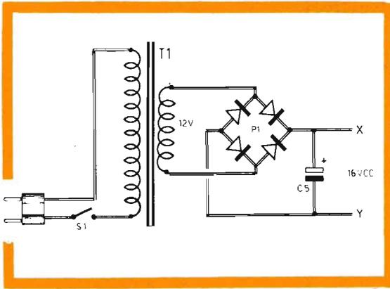
Fig. 4 - Coloro che non fossero in possesso di un alimentatore in continua, adatto per alimentare il circuito di ricarica il cui progetto è riportato in figura 2, dovranno realizzare questo circuito. Il trasformatore T1 deve avere una potenza di 15-20 W. Il ponte raddrizzatore è composto da quattro diodi di tipo 10D4. Il condensatore elettrolitico C5 ha un valore di 1.000  $\mu\text{F}$  - 36 V.
