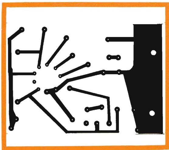
Fig. 4 - Circuito stampato, a grandezza naturale, necessario per realizzare l'amplificatore di bassa frequenza da 1 W.
