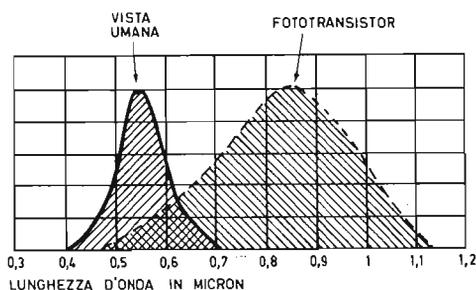
Fig. 3 - L'occhio umano risulta maggiormente sensibile alle lunghezze d'onda che si aggirano intorno al 0,55 micron e che corrispondono alla luce verde. Il fototransistor invece risulta maggiormente sensibile alla lunghezza d'onda di 0,8 - 0,9 micron, in corrispondenza dell'infrarosso.
