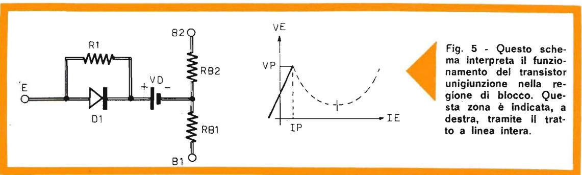
Fig. 5 - Questo schema interpreta il funzionamento del transistor unigiunzione nella regione di blocco. Questa zona è indicata, a destra, tramite il tratto a linea intera.
