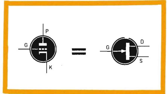
Fig. 4 - Il tubo elettronico, montato nei progetti delle figure 2-3, può essere sostituito con componenti elettronici di tipo moderno, come ad esempio il transistor FET di cui in questo disegno viene riportato il simbolo e l'equivalenza di questo con il simbolo del tubo elettronico.
