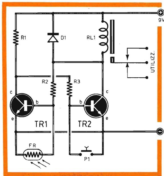
mente con il buon funzionamento del relé, in modo da ottenere la massima sensibilità. Con relé di resistenza compresa fra i 200 e i 600 ohm il valore della resistenza R2 si aggira intorno agli 8.200 ohm; quello della resistenza R3 si aggira intorno ai 15.000 ohm.
