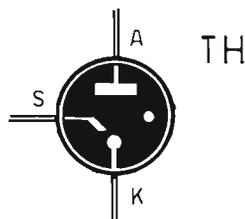
Fig. 8 - Simbolo teorico della valvola a gas thyatron.
