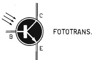
Fig. 1 - Anche il fototransistor, così come avviene per tutti i componenti elettronici, è dotato di simbolo teorico: quello qui riportato che assomiglia molto al transistor.
