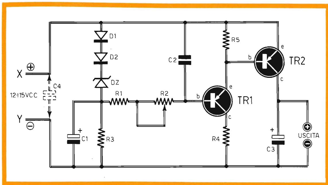
Fig. 2 - Circuito di ricarica per pile al nichel-cadmio. Il condensatore elettrolitico C4 deve essere inserito soltanto nel caso in cui l'apparato venga destinato ad altri usi. Con il potenziometro R2 si regola il valore dell'intensità della corrente di uscita. Sui terminali contrassegnati con le lettere X Y deve essere inserita una sorgente elettrica con tensione continua di 12-15 V. I due transistor TR1-TR2 sono montati nella classica configurazione Darlington.
