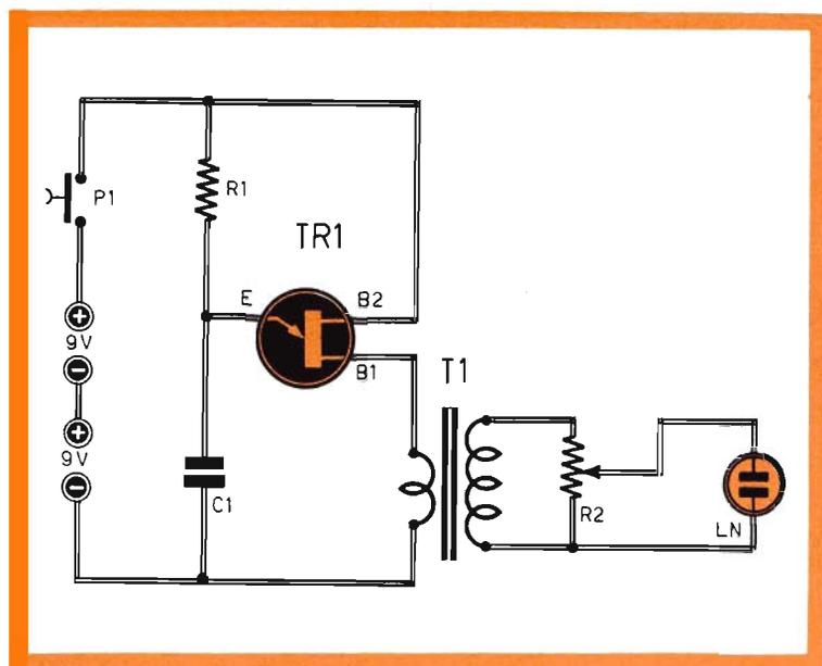
Fig. 1 - Gli impulsi generati dall'oscillatore, pilotato dal transistor unigiunzione TR1, vengono elevati dal trasformatore T1 ed applicati alla
