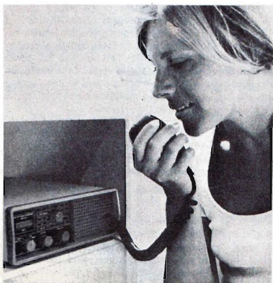
Molti nostri amici, già in possesso dell'autoradio nella loro autovettura, hanno montato anche il ricetrasmittitore **CB**, dopo aver ovviamente risolto il problema dell'antenna. Perché l'antenna che serve a far funzionare l'autoradio non può essere utilizzata per le ricetrasmissioni sulla gamma dei 27 MHz. Il disadattamento di impedenza sarebbe tanto grande da provocare la bruciatura del transistor finale di radiofrequenza in pochi istanti.
