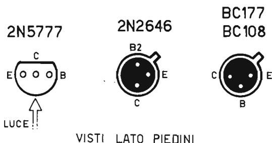
Fig. 3 - Abbiamo riportato in questo disegno la piedinatura dei semiconduttori montati nel circuito del fotocomando. Il primo disegno, a sinistra, si riferisce al fototransistor, quello al centro interpreta la distribuzione degli elettrodi sull'unigiunzione, mentre sulla destra è riprodotta la zoccolatura degli altri due transistor.
