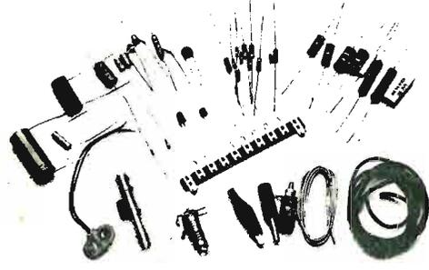
Il pacco-dono 1978 contiene un gran numero di condensatori e resistori di tipi e valori diversi, alcuni semiconduttori e una certa quantità di materiale vario (filo-stagno, filo per collegamenti, lampada e portalam-pada, presa polarizzata, spinotto, pinza a bocca di coccodrillo, boccia, morsettiera, diodo Led, ecc.).
