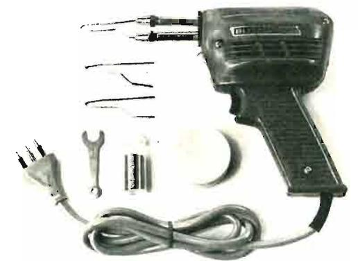
Il kit contiene: 1 saldatore istantaneo (220 V - 100 W) - 2 punte rame di ricambio - 1 scatola pasta saldante - 90 cm di stagno preparato in tubetto - 1 chiave per operazioni ricambio - punta saldatore
