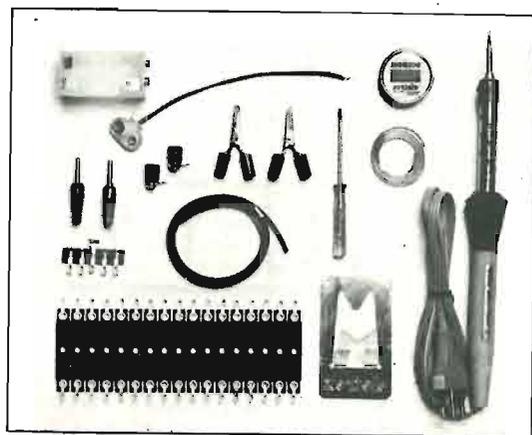
Il kit contiene: N° 1 saldatore (220 V - 25 W) - N° 1 spirulina di filo-stagno - N° 1 scatola di pasta saldante - N° 1 poggia-saldatore - N° 2 boccole isolate - N° 2 spinotti - N° 2 morsetti-coccodrillo - N° 1 ancoraggio - N° 1 basetta per montaggi sperimentali - N° 1 contenitore pile-stilo - N° 1 presa polarizzata per pila 9 V - N° 1 cacciavite miniatura - N° 1 spezzone filo multiplo multicolore.
