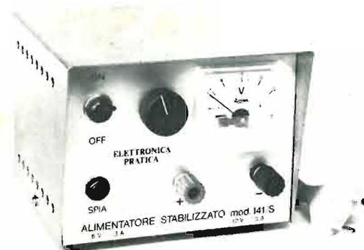
Di facilissima costruzione e di grande utilità nel laboratorio dilettantistico, l'alimentatore stabilizzato è dotato di una moderna protezione elettronica, che permette di tollerare ogni eventuale errore d'impiego del dispositivo, perché la massima corrente d'uscita viene limitata automaticamente in modo da proteggere l'alimentatore da eventuali cortocircuiti.
