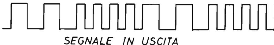
Fig. 7 - Questo diagramma interpreta la composizione del segnale audio uscente dal circuito della sirena bitonale. La forma d'onda è quadra e la frequenza assume, alternativamente due valori diversi.
