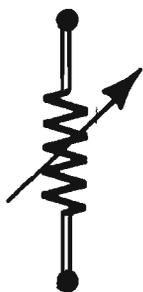
Fig. 8 - Simbolo elettrico del trimmer resistivo, che si differenzia dal comune potenziometro per il solo motivo che la regolazione, anziché manualmente, viene ottenuta mediante cacciavite od altro utensile.
