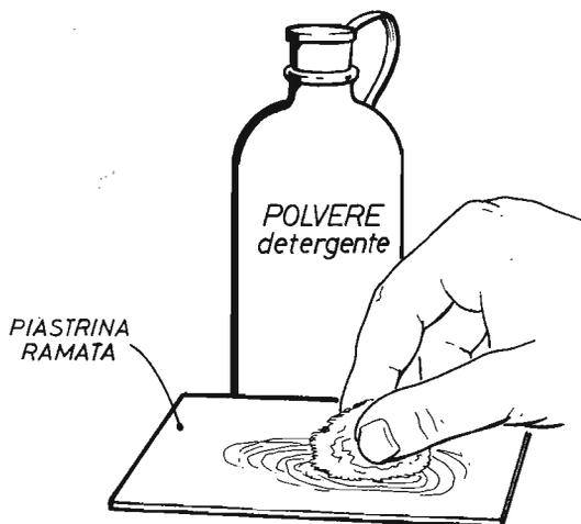
Fig. 4 - La piastrina deve essere accuratamente pulita, sulla superficie ramata, per mezzo di polvere detergente.
