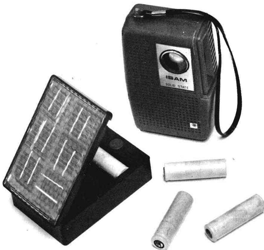
taiche, collegate in serie fra loro, che debbono rimanere esposte ai raggi di luce, allo scopo di generare tensione elettrica. Che può essere principalmente utilizzata per la ricarica di piccoli accumulatori e, secondariamente, per alimentare un ricevitore radio miniaturizzato, svariati circuiti elettronici e, in modo particolare, per realizzare alcuni esperimenti di contenuto didattico, mirati ad ampliare le conoscenze dei principianti di elettronica.
