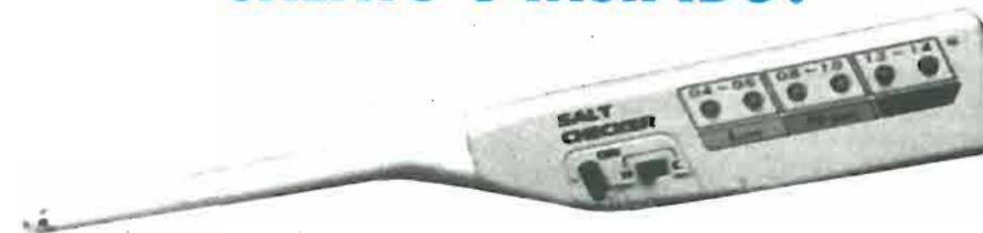
L'acqua distillata, si sa, non conduce elettricità; se ad essa aggiungiamo una certa quantità di un qualsiasi tipo di sale, la conducibilità elettrica aumenta in proporzione. Questo fenomeno fisico è opportunamente sfruttato dallo strumento qui presentato per misurare la corrente che attraversa un qualsiasi liquido o fluido e determinarne così il grado di salinità.
