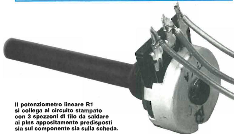
Il potenziometro lineare R1 si collega al circuito stampato con 3 spezzone di filo da saldare ai pins appositamente predisposti sia sul componente sia sulla scheda.
