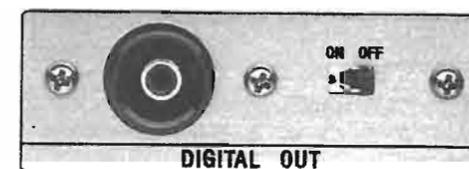
I lettori più sofisticati sono dotati dell'uscita per il collegamento all'amplificatore tramite cavetto a fibre ottiche. In questo modo la qualità del suono si trasmette integralmente.
