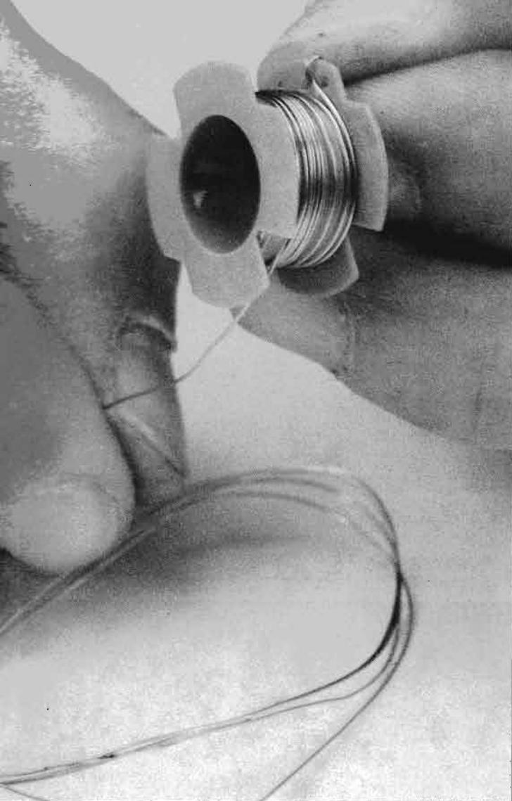
**T1 si realizza avvolgendo su un nucleo in ferrite del filo di rame smaltato con diametro di 0,30 mm. Le spire devono essere 50 per il secondario e 25 per il primario.**
