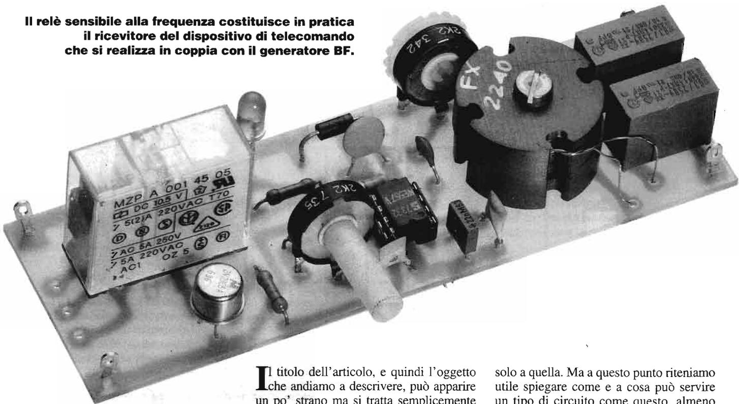
**Esempio elementare di impiego di un sistema di telecomando facente uso del nostro relè sensibile alla frequenza, e convogliato attraverso l'impianto di rete luce, funzionante (nel nostro esemplare) a 62,5 KHz; ai contatti del relè in uscita va ovviamente collegata la specifica utilizzazione, che può essere di qualsiasi tipo.**
