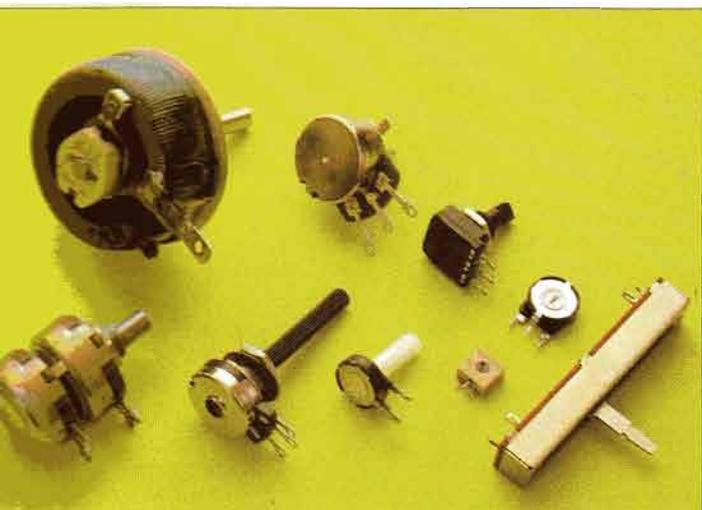
**Trimmer e potenziometri** si presentano in modi molto diversi pur svolgendo tutti la stessa funzione. La regolazione della potenza può avvenire ruotando un alberino, spostando un cursore a slitta o agendo con il cacciavite su una piccola vite a taglio.
