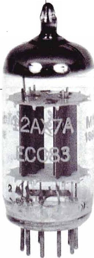
**Un altro produttore di valvole, la FIVRE, ha nel suo catalogo la ECC 83 (o 12 AX7), in questo caso non di tipo selezionato ma normale. La mancanza della famiglia di curve però ne rende possibile l'utilizzo solo con tensioni di alimentazione anodica prefissate (100 e 250 V); quando (purtroppo accade raramente) si può scegliere è meglio optare per una scheda delle caratteristiche che comprenda anche la famiglia di curve.**
