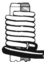
Per montare un circuito con la tecnica del wire wrapping occorrono sulla scheda apposti terminali rigidi.
