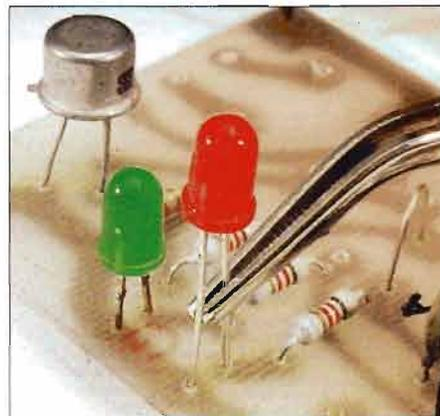
Il selettore S1 consente di mettere in funzione il circuito o lasciarlo in stand-by; su A il dispositivo è pronto per rilevare una presenza, su B è disattivato. Il ponticello si realizza con uno spezzone di reoforo tagliato da qualche componente.
