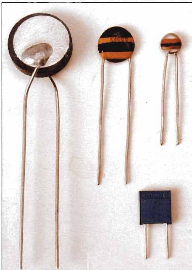
**Il termistore, detto anche NTC (Negative Temperature Coefficient), è una resistenza il cui valore diminuisce al crescere della temperatura. Viene soprattutto usato come stabilizzatore, per compensare gli effetti dell'aumento della temperatura a cui sono soggetti gli altri dispositivi del circuito. Ha forme e dimensioni diverse. Il suo valore può essere riportato per intero sul contenitore oppure va interpretato secondo il medesimo codice colori delle resistenze.**
