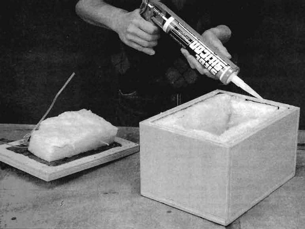
**L'interno della cassa va quasi completamente riempito di lana di vetro di media densità, del tipo comunemente usato in edilizia. L'isolante però non va compresso e non deve toccare la membrana degli altoparlanti.**
