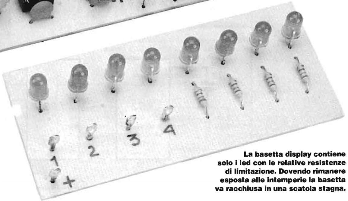
**La bassetta display contiene solo i led con le relative resistenze di limitazione. Dovendo rimanere esposta alle intemperie la bassetta va racchiusa in una scatola stagna.**
