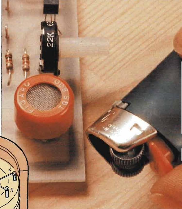
**Il sensore è composto, all'interno, da un filamento periscaldatore avvolto intorno al sensore vero e proprio, in materiale semiconduttore, che deve lavorare ad una precisa temperatura.**
