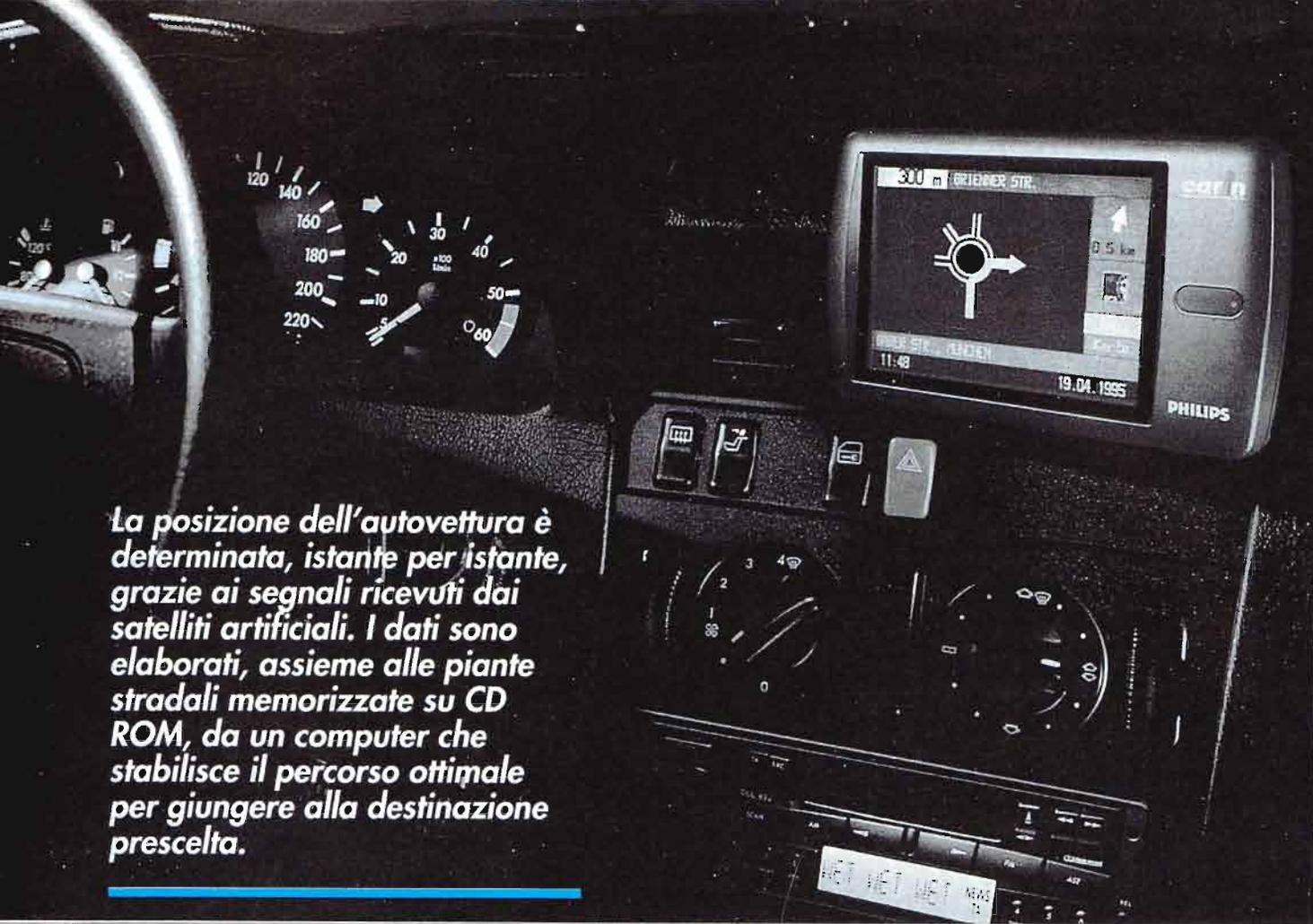
*La posizione dell'autovettura è determinata, istante per istante, grazie ai segnali ricevuti dai satelliti artificiali. I dati sono elaborati, assieme alle piante stradali memorizzate su CD ROM, da un computer che stabilisce il percorso ottimale per giungere alla destinazione prescelta.*
