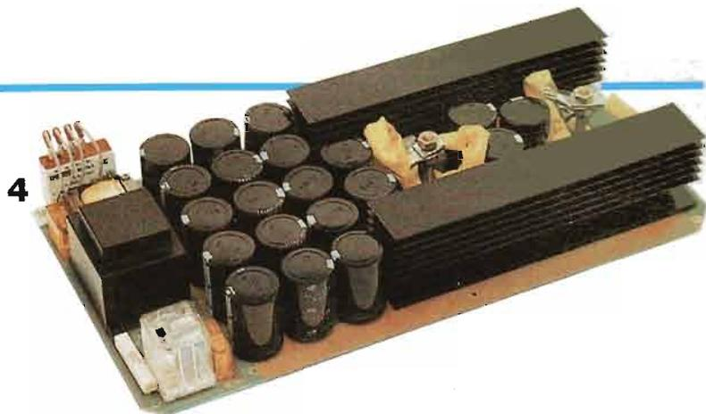
**4: il circuito di accensione della lampada ha il compito di elevare la tensione fornita dall'alimentatore a valori altissimi per innescare il gas contenuto all'interno del bulbo al quarzo della lampada xenon.**
