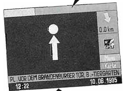
**1:** analogamente ai dispositivi destinati alla navigazione marittima, anche nel sistema Carin l'informazione ottenuta mediante un ricevitore GPS viene integrata con le piante stradali memorizzate in un computer.
