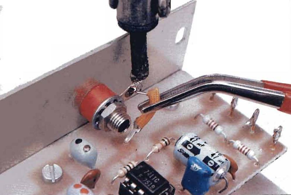
Il collegamento tra la sonda di rilevazione e il circuito stampato si esegue tramite un breve spezzone di filo rigido (quello dei reofori, per intenderci) isolato. Le saldature, da fare con grande cura, si effettuano sul pin 1 dello stampato e sulla paglietta del connettore per il sensore.
