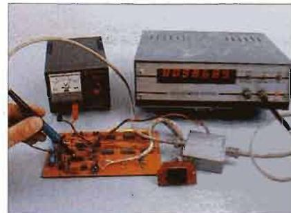
**L'amplificatore lineare** è capace di amplificare i segnali più deboli così da renderli rilevabili con tester od oscilloscopi. Lavora su una larga banda di frequenze.
