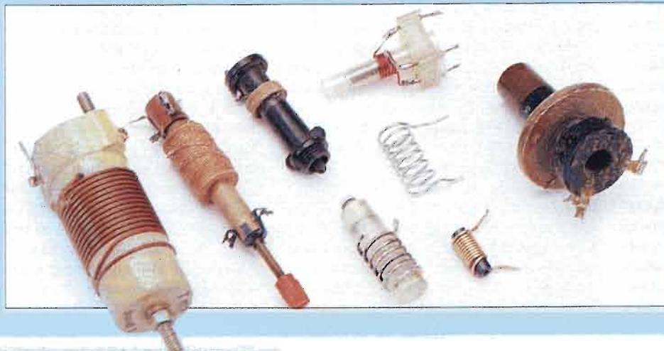
Ecco alcuni tipi di impedenze, con forme e dimensioni diverse a seconda dell'impiego specifico.
