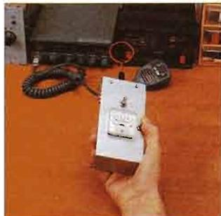
**Il misuratore di fughe RF** consente di individuare guasti o difetti di montaggio in apparecchi radio, segnalando opportunamente la presenza della RF dove non dovrebbe esserci.
