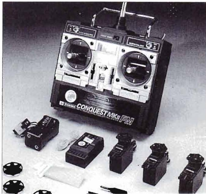
**I radiocomandi sono i più antichi ma rimangono tuttora gli unici che funzionano anche a distanza di parecchi km. Qui una versione da modellismo con tutti gli "attuatori" comandati, da montare sul modellino.**
