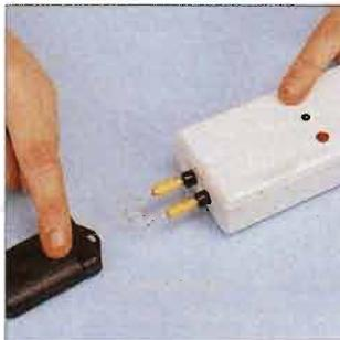
**Il provatelecomandi** permette di individuare se il difetto di funzionamento va ricercato nel trasmettitore o nel ricevitore. La segnalazione è fornita da un led.
