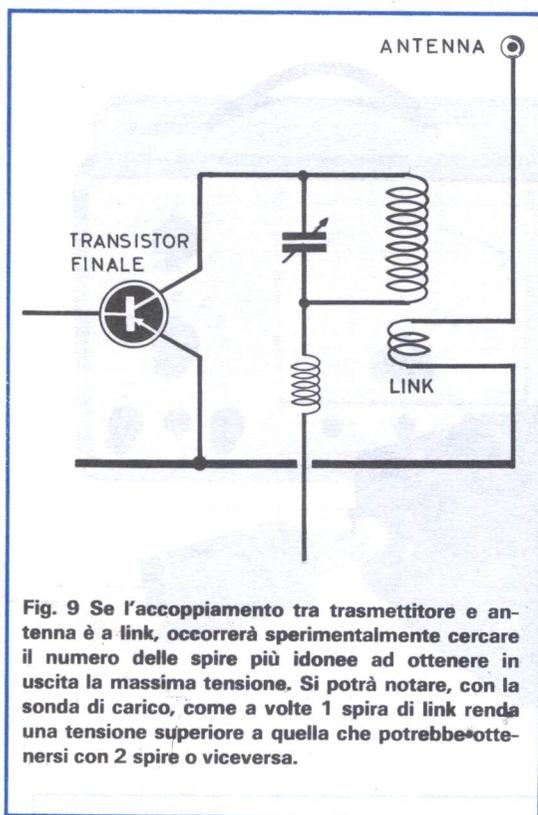
**Fig. 9** Se l'accoppiamento tra trasmettitore e antenna è a link, occorrerà sperimentalmente cercare il numero delle spire più idonee ad ottenere in uscita la massima tensione. Si potrà notare, con la sonda di carico, come a volte 1 spira di link renda una tensione superiore a quella che potrebbe ottenersi con 2 spire o viceversa.
