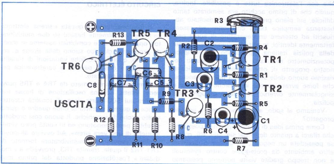
contrario, quando TR3 non conduce è come se noi avessimo al posto di R9 una resistenza di valore molto più elevato; in tal modo il multivibratore modifica la propria frequenza di oscillazione ed, anzi, l'onda prodotta non è più simmetrica.
