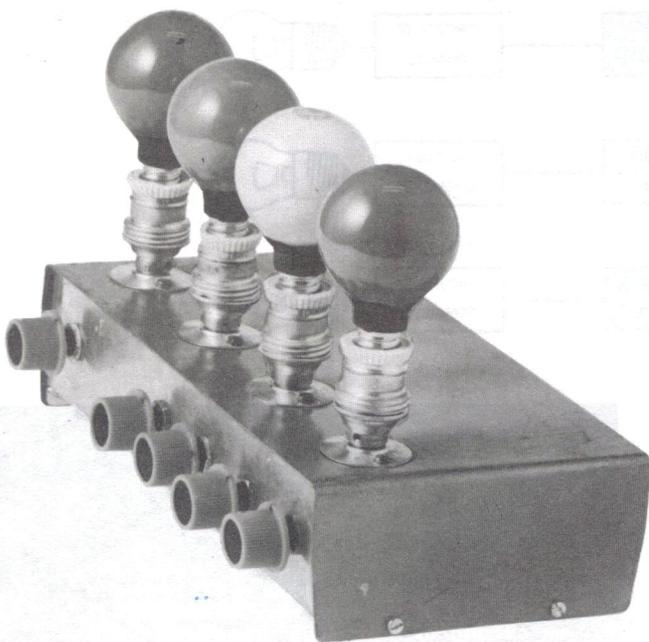
Lo schema che noi proponiamo può essere ampliato per più canali, ad esempio per acuti-medi-medibassi-bassi, oppure ridotto a due soli canali, acuti-bassi, senza eccessiva difficoltà. A lato la fotografia di un prototipo a quattro canali, realizzato con lampade di piccola potenza.
