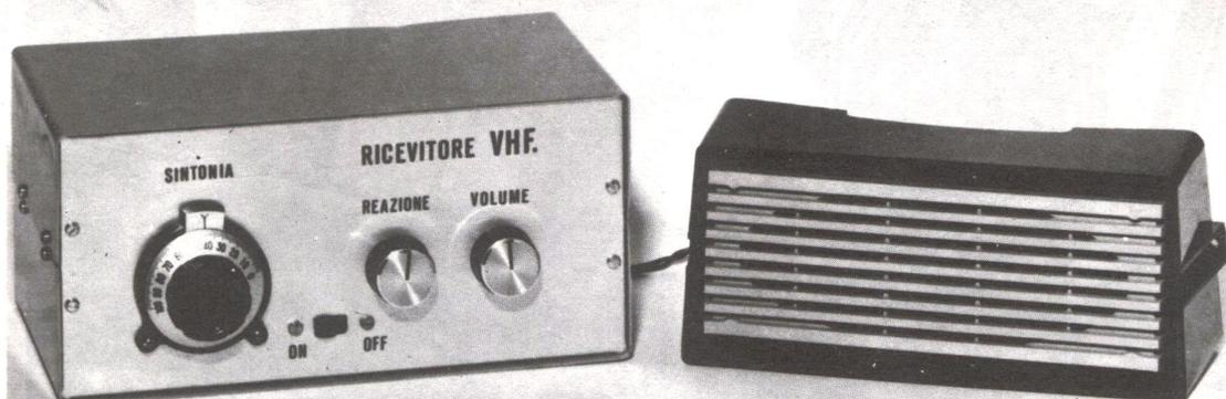
Fig. 7 Coloro che desiderano le cose perfette, potranno come abbiamo fatto noi racchiudere il tutto entro un elegante mobiletto metallico (completandolo con l'altoparlante presentato a pag. 190 del n. 3/69 di nuova Elettronica). Le scritte sul pannello sono state effettuate con lettere autoadesive rintracciabili presso ogni cartoleria. -
