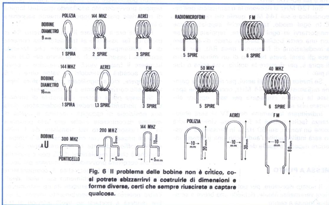
Fig. 6 Il problema delle bobine non è critico, così potrete sbizzarrirvi a costruirle di dimensioni e forme diverse, certi che sempre riuscirete a captare qualcosa.
