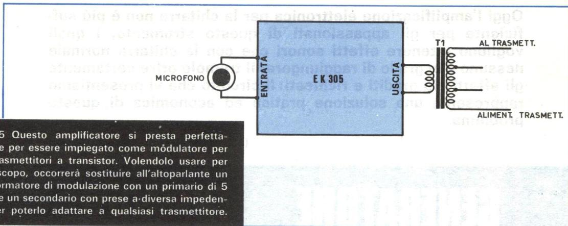
Fig. 5 Questo amplificatore si presta perfettamente per essere impiegato come modulatore per ricetrasmittitori a transistor. Volendolo usare per tale scopo, occorrerà sostituire all'altoparlante un trasformatore di modulazione con un primario di 5 ohm e un secondario con prese a diversa impedenza per poterlo adattare a qualsiasi trasmettitore.
