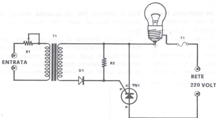
**Fig. 3 - Il piú semplice sistema per ottenere una luce psichedelica, utile per effetti pubblicitari od altro, può essere ottenuto realizzando questo schema. Il segnale di entrata verrà prelevato dall'altoparlante di un amplificatore oppure anche da quello di una radio.**
