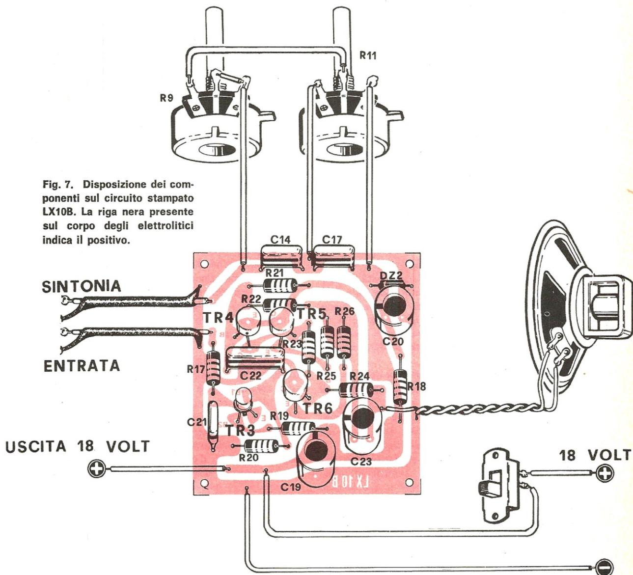
Fig. 7. Disposizione dei componenti sul circuito stampato LX10B. La riga nera presente sul corpo degli elettrolitici indica il positivo.
