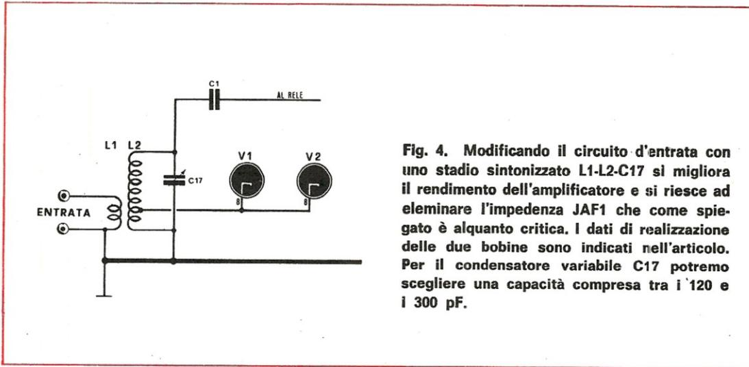
**Fig. 4.** Modificando il circuito d'entrata con uno stadio sintonizzato L1-L2-C17 si migliora il rendimento dell'amplificatore e si riesce ad eliminare l'impedenza JAF1 che come spiegato è alquanto critica. I dati di realizzazione delle due bobine sono indicati nell'articolo. Per il condensatore variabile C17 potremo scegliere una capacità compresa tra i 120 e i 300 pF.
