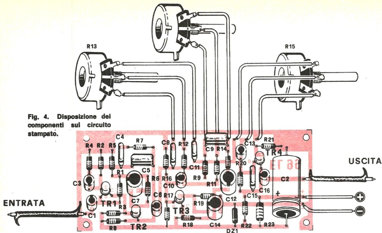
Fig. 4. Disposizione dei componenti sul circuito stampato.
