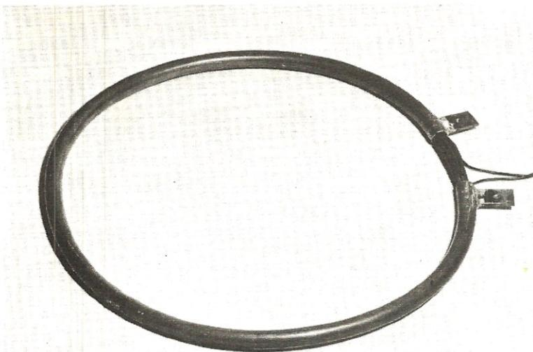
**Fig. 2.** La bobina esploratrice L1 deve risultare avvolta entro un tubo di rame come vedesi in questa foto. Considerata la difficoltà di realizzazione abbiamo provveduto a farci preparare questa sonda esploratrice da industrie del ramo. Il costo della sonda pretrata è di L. 2.500 più spese postali.
