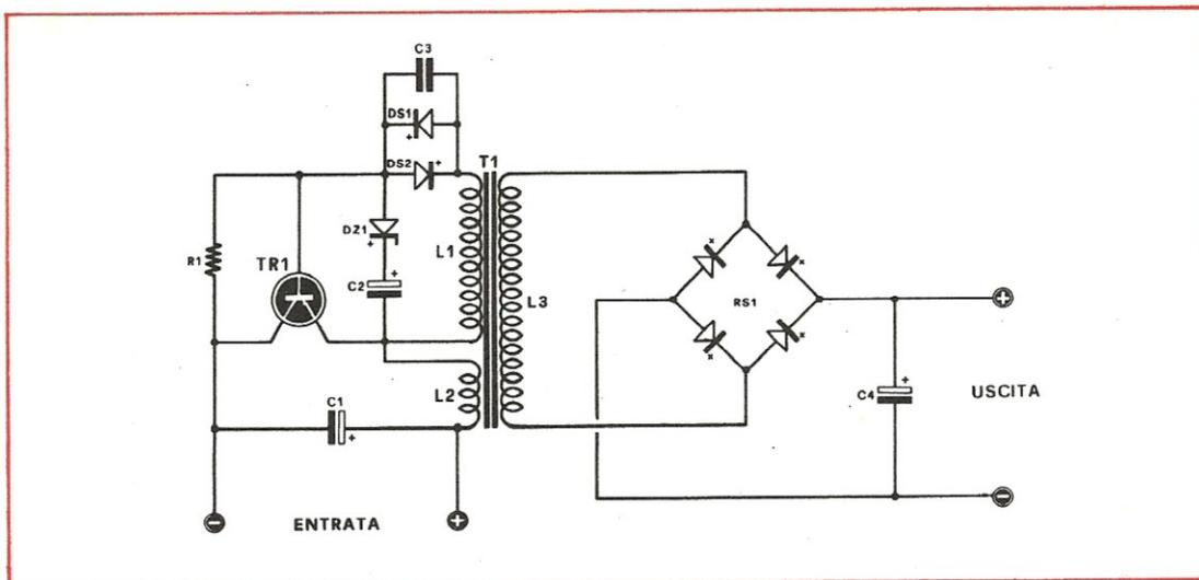
zando sempre del filo da 1 mm.; volendo ottenere ad esempio 12 volt occorrerà avvolgere la metà delle spire. Per ottenere tensioni sull'ordine dei 300-350 volt per L3 sono necessari circa 800 spire, impiegando del filo da 0,20 mm.
