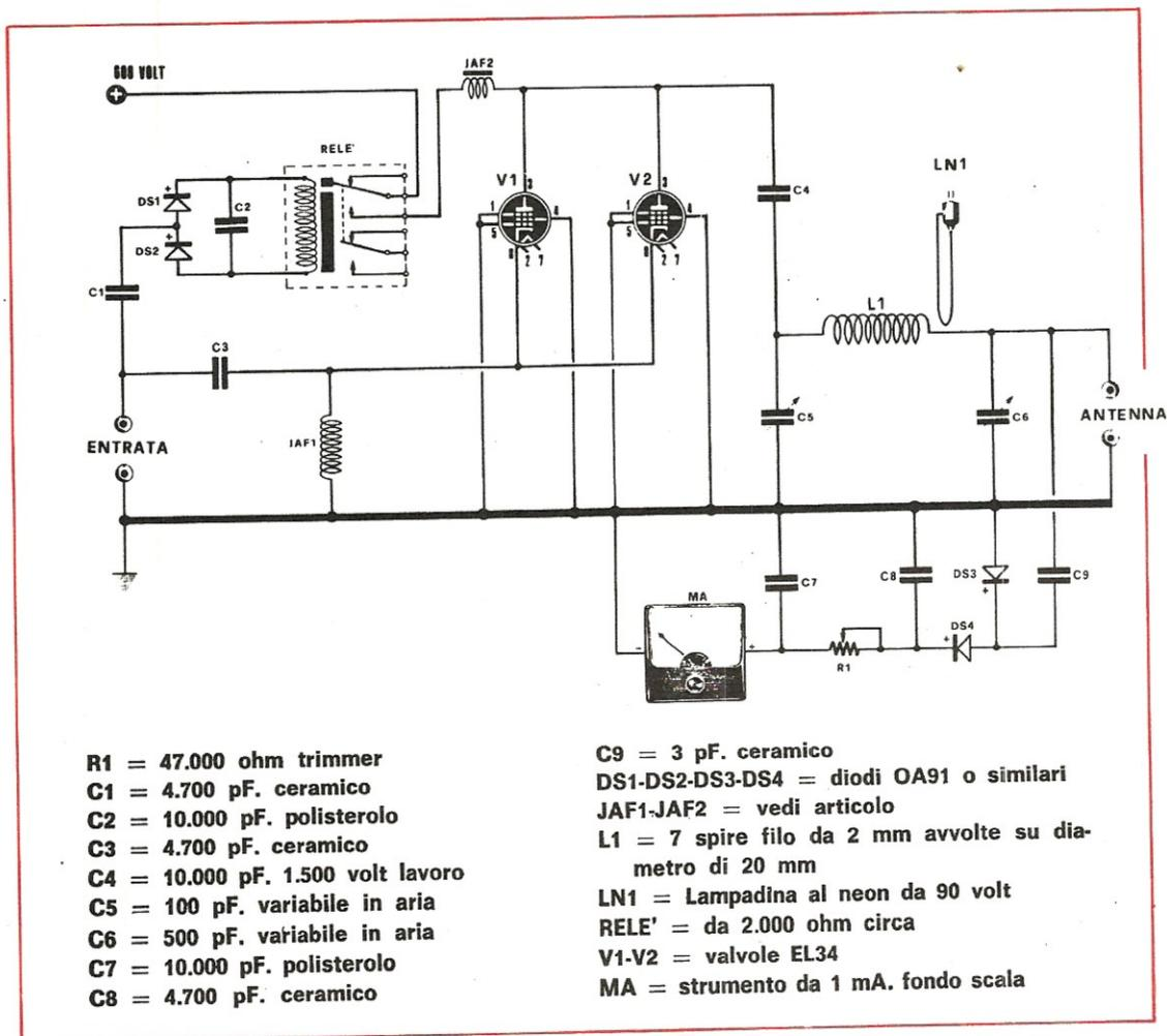
lampadina al neon si illuminerà ugualmente bene. Comunque, oltre a questo semplice circuito-spia, sull'uscita risulta incluso pure uno strumento in grado di indicarci, con maggior precisione, quanta alta frequenza mandiamo in antenna.
