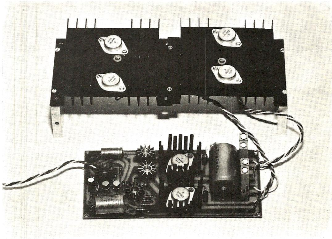
In questa foto, l'amplificatore completo dei quattro transistor finali di potenza. Le alette visibili nella foto sono sufficienti per potenze sull'ordine dei 50-60 Watt, volendo ottenere o superare i 100 Watt sarà necessario raddoppiarne la superficie.
