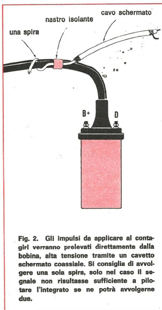
**Fig. 2.** Gli impulsi da applicare al contachilometri verranno prelevati direttamente dalla bobina, alta tensione tramite un cavo schermato coassiale. Si consiglia di avvolgere una sola spira, solo nel caso il segnale non risultasse sufficiente a pilotare l'integrato se ne potrà avvolgerne due.
