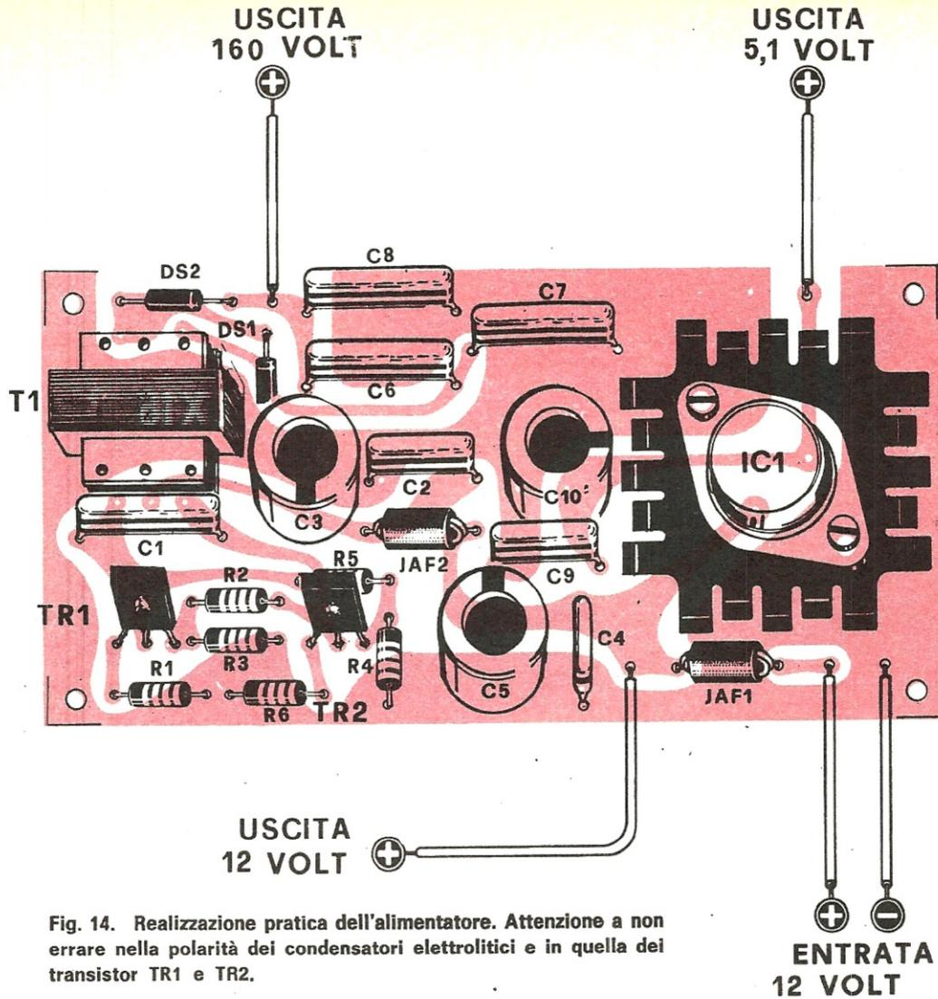
**Fig. 14.** Realizzazione pratica dell'alimentatore. Attenzione a non errare nella polarità dei condensatori elettrolitici e in quella dei transistor TR1 e TR2.
