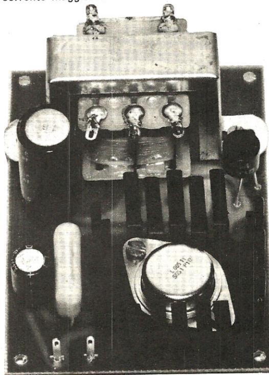
Se dovete realizzare dei semplici alimentatori stabilizzati con valori di tensione fissa, per alimentare circuiti integrati, ricevitori, apparati di misura ecc., vi consigliamo di impiegare questi circuiti: avrete in uscita una tensione perfettamente stabile ed un alimentatore protetto contro i cortocircuiti
