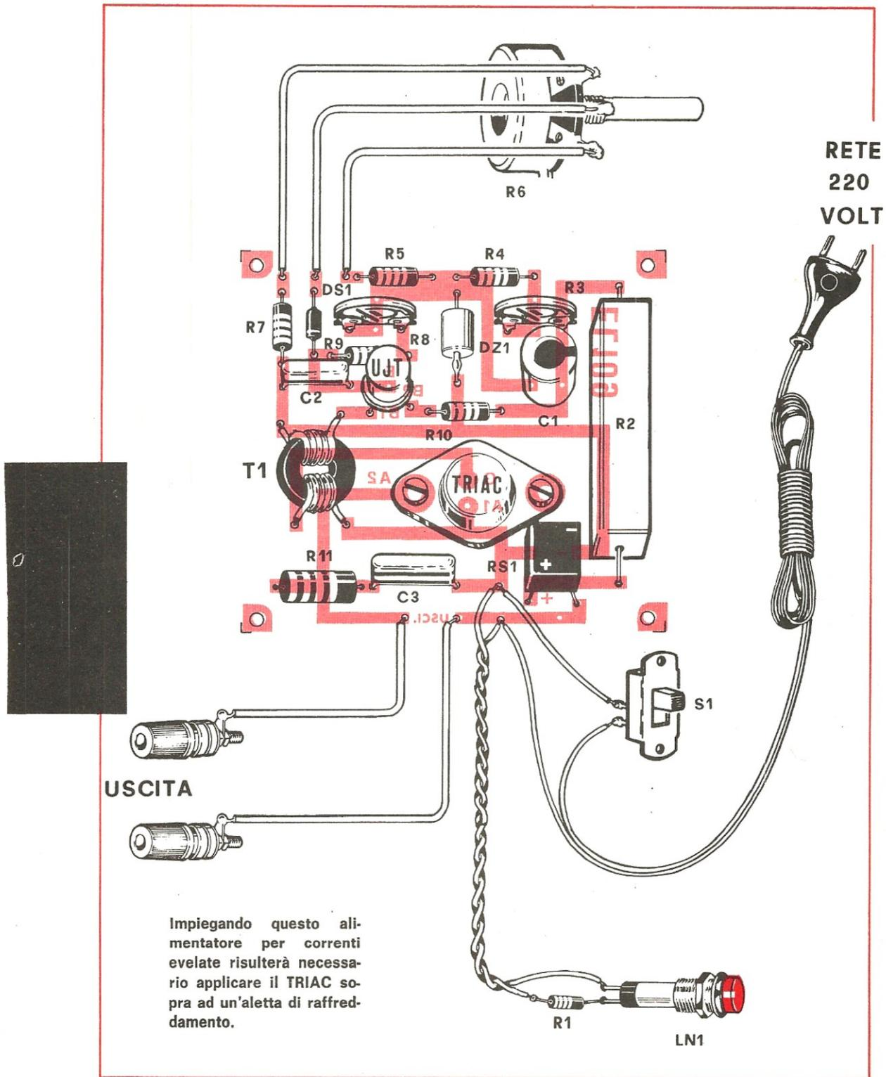
Impiegando questo alimentatore per correnti elevate risulterà necessario applicare il TRIAC sopra ad un'aletta di raffreddamento.
