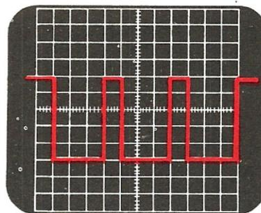
**Fig. 7.** Sul punto D il segnale visto all'oscilloscopio si presenterà come vedesi in figura. La distanza tra i due fronti di salita risulterà sempre di 0,3 secondi (prefissata dall'oscillatore) sia che aumentino o si riducano gli impulsi di conteggio prelevati dalla bobina alta tensione.
