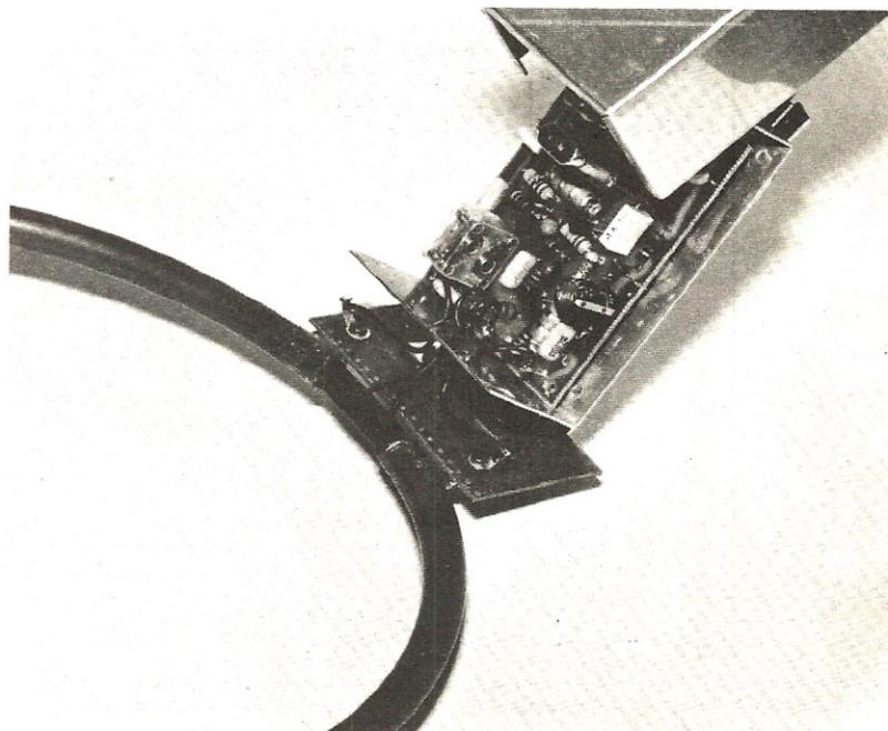
**Fig. 3.** Nella foto si può notare come risulta fissata sull'estremità di un tondino di legno, la bobina sonda e la scatola metallica contenente lo stadio oscillatore di AF il quarzo da 1 MHz e i transistor TR1-TR2.
