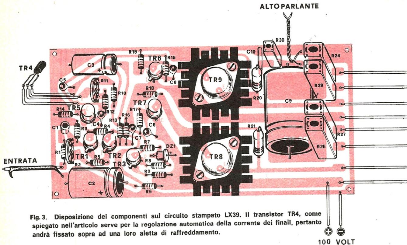
Fig. 3. Disposizione dei componenti sul circuito stampato LX39. Il transistor TR4, come spiegato nell'articolo serve per la regolazione automatica della corrente dei finali, pertanto andrà fissato sopra ad una loro aletta di raffreddamento.
