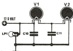
Fig. 2. Se alimentate i filamenti a 12 volt ricordatevi di collegare tra il piedino 2 e la massa di ogni valvola un condensatore (C10-C11) da 4.700 pF. Anche se i due filamenti venissero alimentati in parallelo (6,3 volt) risulta sempre necessario applicare sul terminale di ogni valvola un condensatore da 4.700 pF per fugare a massa eventuali residui di AF.
