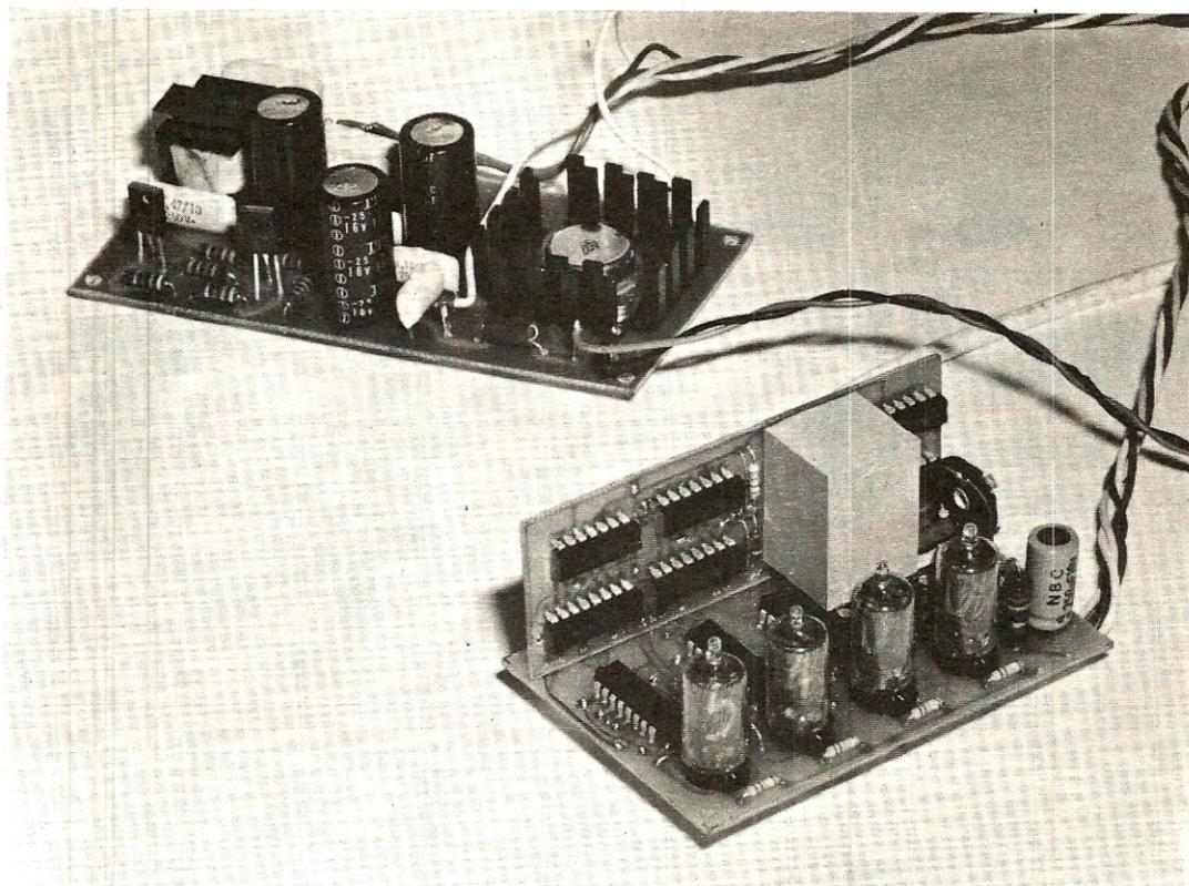
**Fig. 13.** Nella foto il contagiri digitale completo in ogni sua parte. I due telai come spiegato in articolo andranno racchiusi separatamente entro due contenitori metallici, o in legno, applicando frontalmente alle nixie un plexiglass di color rosso scuro.
