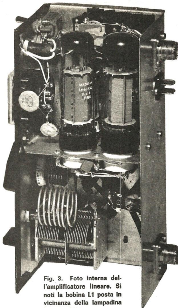
Fig. 3. Foto interna dell'amplificatore lineare. Si noti la bobina L1 posta in vicinanza della lampadina la neon LN1.
