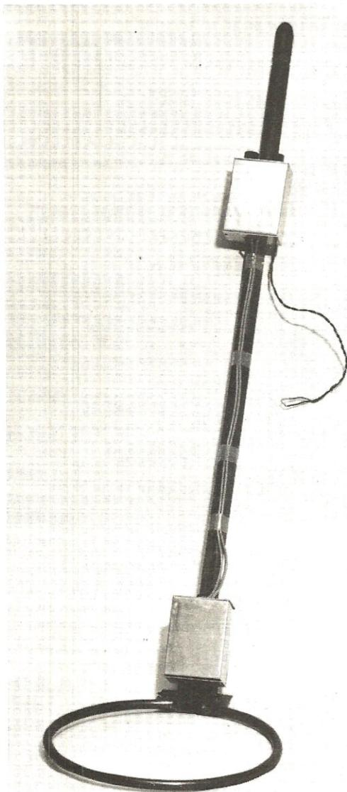
metallica è grande, la bobina esploratrice varia enormemente di frequenza e può superare quindi nel battimento i 15.000 Hz, entrando quindi nella gamma delle frequenze ultrasoniche, anch'esse non rilevabili dal nostro orecchio.
