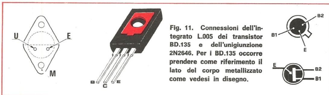
Fig. 11. Connessioni dell'integrato L.005 dei transistor BD.135 e dell'unigiunzione 2N2646. Per i BD.135 occorre prendere come riferimento il lato del corpo metallizzato come vedesi in disegno.
