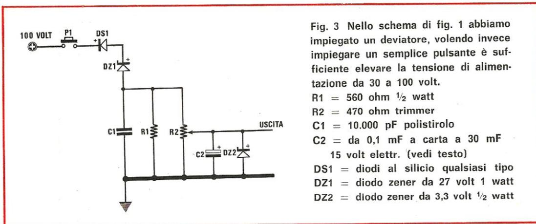
Fig. 3 Nello schema di fig. 1 abbiamo impiegato un deviatore, volendo invece impiegare un semplice pulsante è sufficiente elevare la tensione di alimentazione da 30 a 100 volt.
