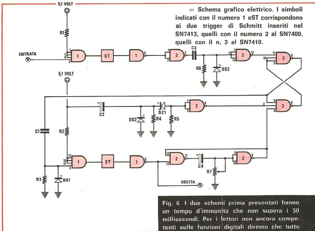
dino « 8 » (uscita 2): collegando l'uscita 2 al contatore noi avremo l'avanzamento della cifra ogniquale volta la fotoresistenza viene a trovarsi nella condizione di oscuramento, mentre se utilizzeremo l'uscita 1 l'avanzamento della cifra avverrà allorché la fotoresistenza viene colpita da un fascio di luce.
