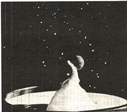
**Fig. 6** Con questo stroboscopio possiamo ottenere dai 15 ai 200 lampi al secondo il che significa fotografare in un secondo 15-200 volte l'oggetto in movimento. In questa foto abbiamo colto una sfera nell'istante in cui sta cadendo in un bicchiere di latte e contemporaneamente lo spruzzo del latte quando la sfera si è già immersa.
