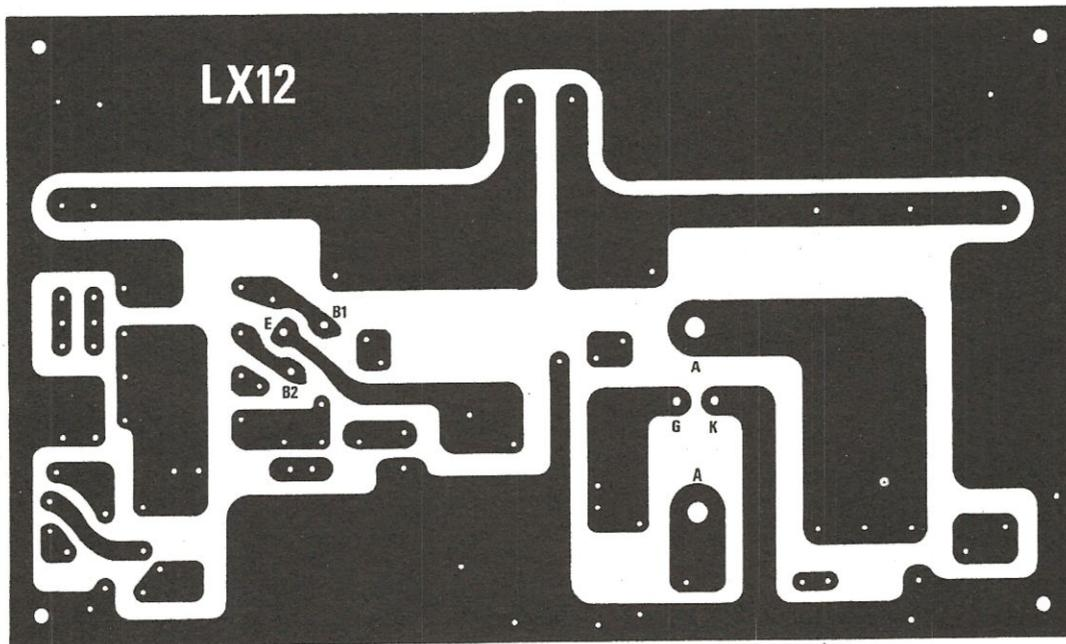
Fig. 4 Circuito stampato a grandezza naturale dello stroboscopio. Per l'ordinazione, tale circuito stampato viene denominato LX12.
