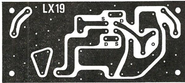
Fig. 2 Circuito stampato a grandezza naturale necessario per la realizzazione di questo preamplificatore AF. Il circuito è in fibra di vetro.
