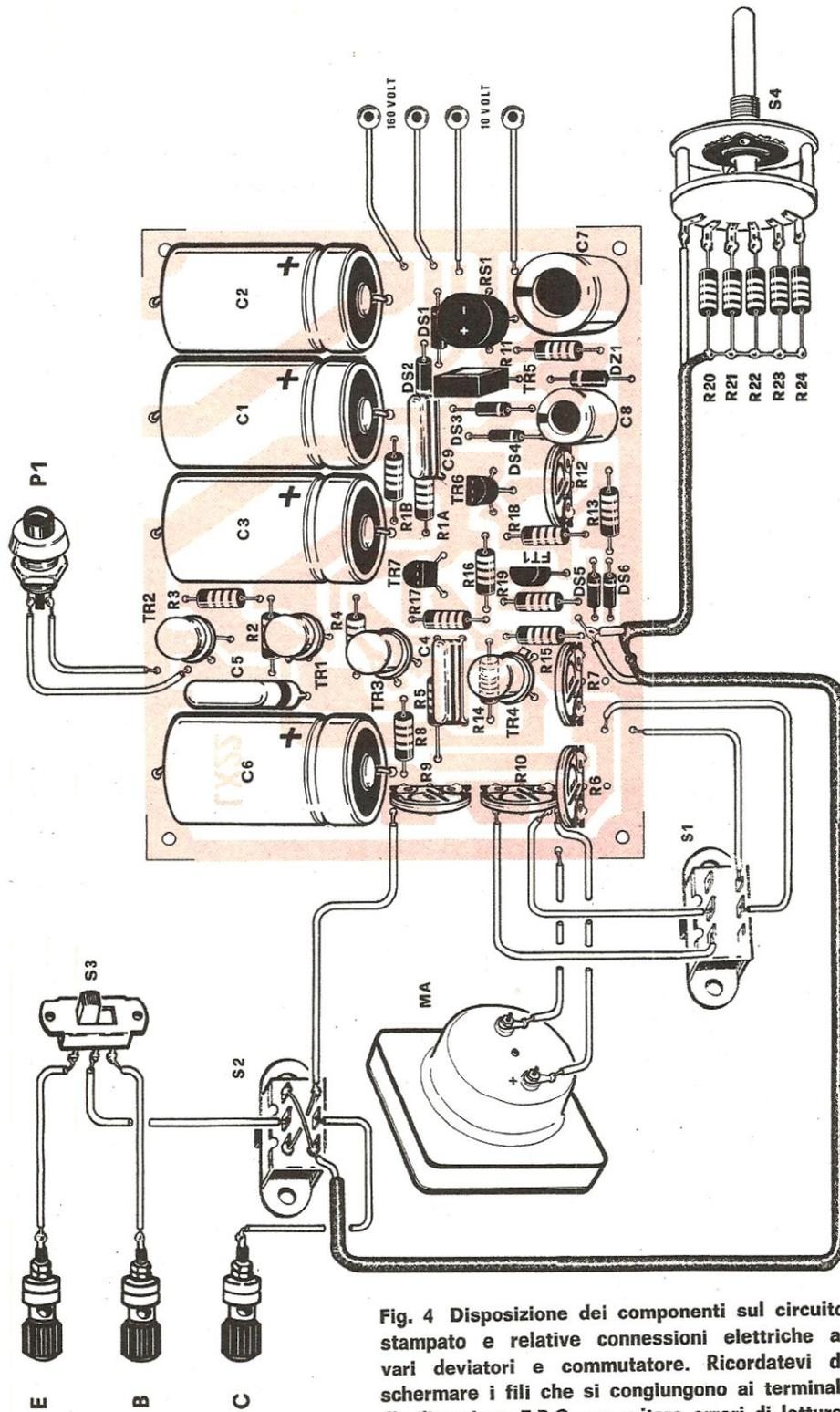
Fig. 4 Disposizione dei componenti sul circuito stampato e relative connessioni elettriche ai vari deviatori e commutatore. Ricordatevi di schermare i fili che si congiungono ai terminali d'utilizzazione E-B-C per evitare errori di lettura.
