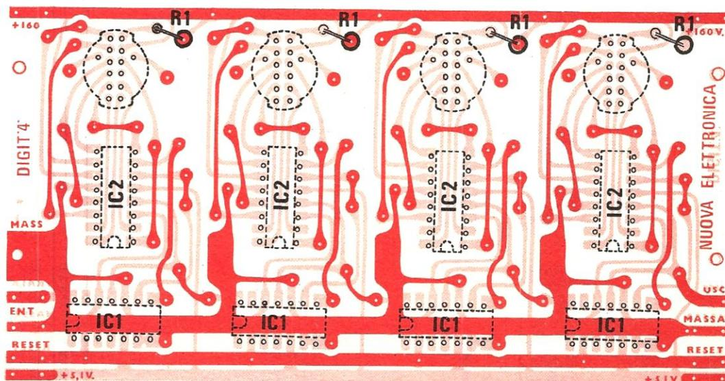
Circuito stampato « digit 4 » cioè composto di quattro nixie. Anche per questo telaio le resistenze R1 occorre sceglierle di un valore ohmico tale da non far assorbire per ogni nixie una corrente superiore ai 2 mA. I valori da utilizzare possono essere compresi tra 5.600 ohm a 12.000 ohm. Tutti gli integrati indicati con IC1 sono dei SN7490 e quelli indicati con IC2 sono dei SN7441 o SN74141.
