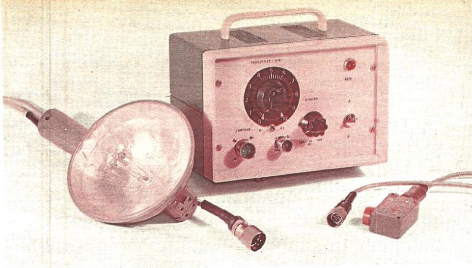
**Con la realizzazione di questo « flash stroboscopico » riuscirete a fissare sulla pellicola le varie fasi di una goccia d'acqua in movimento, vedere evidenziata la caratteristica caduta di un gatto che, pur facendolo cadere « rovesciato », riesce a toccare il suolo sempre in piedi, oppure le deformazioni di una palla durante il rimbalzo, le sequenze di un movimento, di un salto, di un bicchiere che va in frantumi.**
