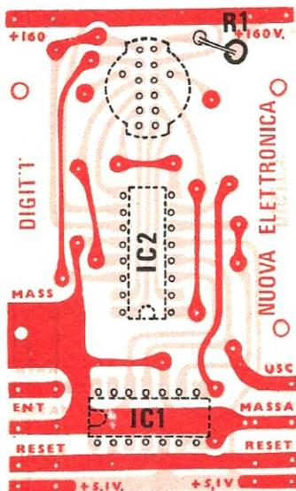
Il circuito stampato a una sola cifra denominato «digit 1». Come spiegato in articolo abbiamo realizzato telai a 2-3-4 cifre. La resistenza R1 può assumere un valore variabile da 5.600 ohm a 12.000 ohm a seconda della tensione di alimentazione. Infatti la corrente per ogni nixie non deve superare i 2 mA. IC1 è un integrato SN7490 e IC2 un SN7441 o SN74141.
