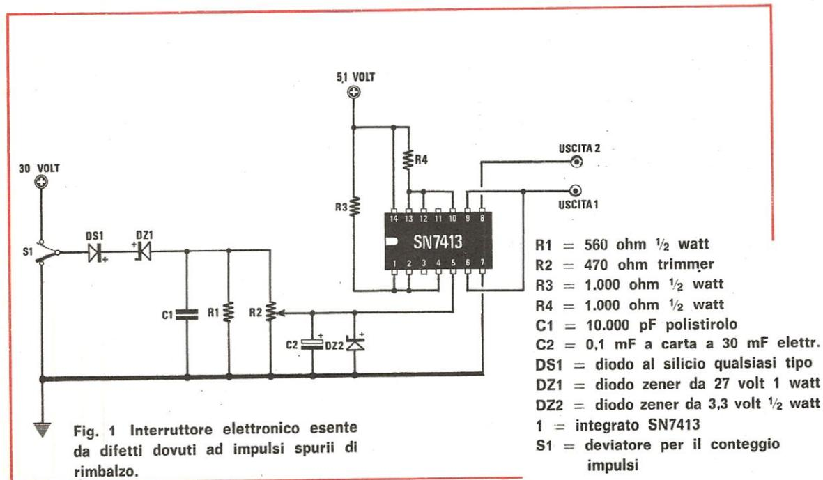
Per il pilotaggio dei contatori digitali non è possibile utilizzare comuni interruttori meccanici, in quanto, alla chiusura e all'apertura dei contatti, non si ha un solo impulso, ma molti di più, con la conseguenza di un conteggio falsato rispetto alla realtà.
