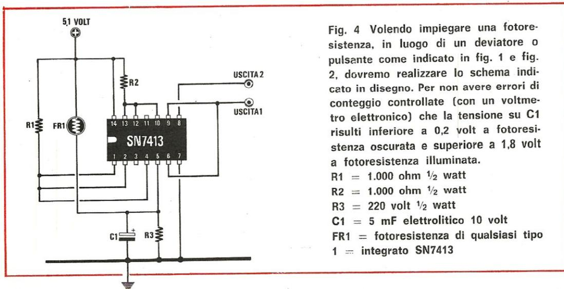
Fig. 4 Volendo impiegare una fotoresistenza, in luogo di un deviatore o pulsante come indicato in fig. 1 e fig. 2, dovremo realizzare lo schema indicato in disegno. Per non avere errori di conteggio controllate (con un voltmetro elettronico) che la tensione su C1 risulti inferiore a 0,2 volt a fotoresistenza oscurata e superiore a 1,8 volt a fotoresistenza illuminata.
