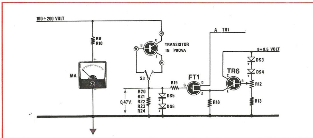
sistors TR7-TR4 in modo da limitare la corrente in uscita dell'alimentatore sui valori prefissati dal commutatore S4.
