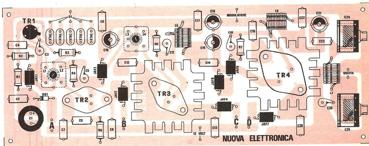
**Fig. 4** Sul circuito stampato del trasmettitore TX15 troverete riportato questo disegno. Sbagliare in simili condizioni risulta praticamente impossibile, e se tarerete i vari circuiti come indicato nell'articolo, vi possiamo assicurare di superare con facilità la potenza massima indicata.
