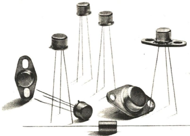
un transistor da 25-26 volt lavoro, perché se il modulatore avesse dei picchi di sovramodulazione tali da superare questo valore, il nostro transistor andrebbe immediatamente fuori uso. In questi casi occorre scegliere transistor che abbiano una tensione di lavoro di almeno 65-70 volt.
