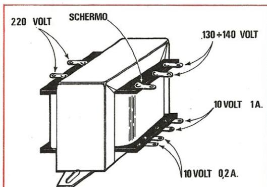
**Fig. 5** Nel disegno vi presentiamo come risultano disposti i terminali del trasformatore T1 impiegato per la realizzazione del nostro strumento. Il terminale dello « schermo » e quello dei 10 volt 0,2 A rimangono inutilizzati.
