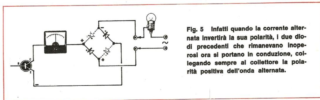
**Fig. 5** Infatti quando la corrente alternata invertirà la sua polarità, i due diodi precedenti che rimanevano inoperosi ora si portano in conduzione, collegando sempre al collettore la polarità positiva dell'onda alternata.
