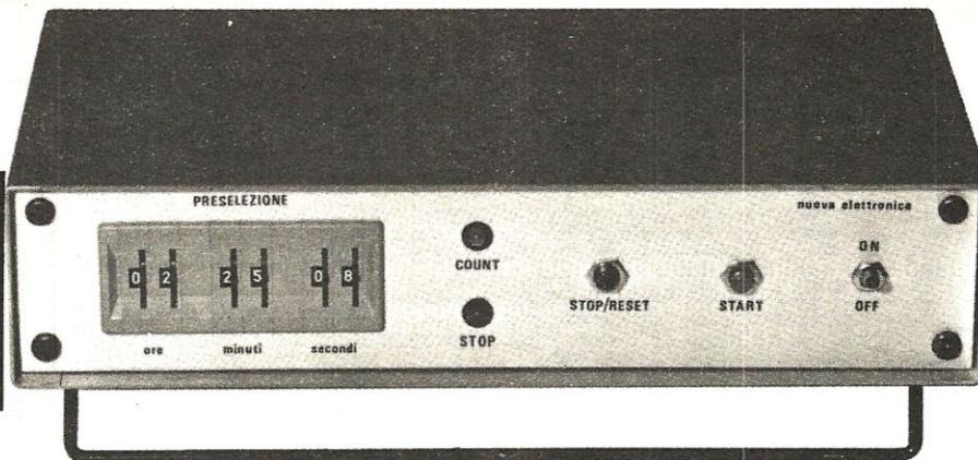
**Lo potrete impiegare sia come un perfetto contasecondi per usi industriali, sia come contaminuti, contaore o contagiorni. In pratica potrete programmarlo per mettere in movimento un motore, per accendere una luce o per azionare qualsiasi altra apparecchiatura elettrica, a distanza di giorni, di ore o di minuti o di secondi.**
