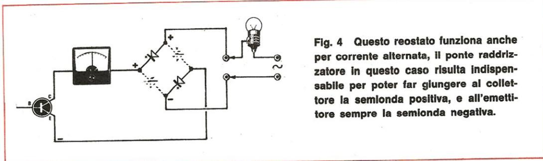
**Fig. 4** Questo reostato funziona anche per corrente alternata, il ponte raddrizzatore in questo caso risulta indispensabile per poter far giungere al collettore la semionda positiva, e all'emettitore sempre la semionda negativa.
