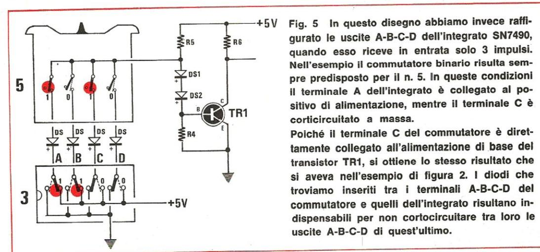
Fig. 5 In questo disegno abbiamo invece raffigurato le uscite A-B-C-D dell'integrato SN7490, quando esso riceve in entrata solo 3 impulsi. Nell'esempio il commutatore binario risulta sempre predisposto per il n. 5. In queste condizioni il terminale A dell'integrato è collegato al positivo di alimentazione, mentre il terminale C è cortocircuitato a massa.
