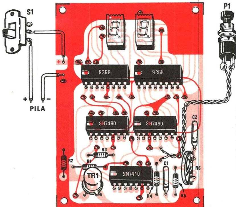
Fig. 4 Schema pratico di montaggio dei componenti sul circuito stampato. Notare, nel circuito, la tacca di riferimento degli integrati e le scanalature superiori dei display FND. 70.
