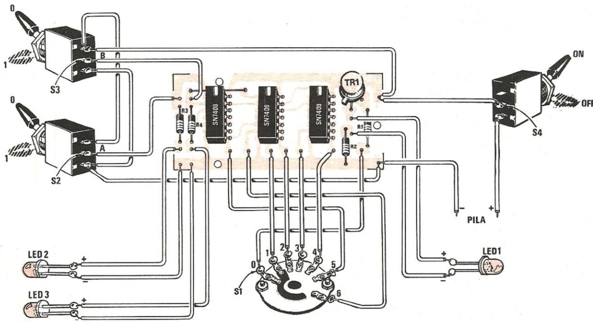
Effettuando il collegamento al commutatore S1 occorrerà controllare che ogni posizione corrisponda alla funzione desiderata, e cioè AND NAND - OR - ecc.
