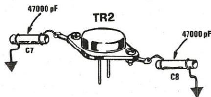
**Fig. 6** Realizzando montaggi an AF è molto importante cercare di fugare a massa residui di AF che potrebbero impedire al transistor amplificatore di funzionare regolarmente. Tanto per fare un esempio, credere di aver eliminato totalmente i residui di AF sul corpo di un transistor, collegando un solo condensatore ad un estremo, o aumentarne la capacità è pura eresia. Occorre, come vedesi in disegno, collegare alle due estremità del corpo, due condensatori da 4.700 o anche da 1.000 pF.
