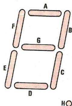
Fig. 1 I sette segmenti inclusi del display risultano contraddistinti dalle lettere A-B-C-D-E-F-G, ognuna delle quali fa capo ad un terminale d'uscita, come spiegato in articolo. Il segmento H corrisponde al punto decimale che, in questo montaggio, rimane inutilizzato.
