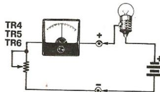
**Fig. 3** Come è possibile intuire da questi due disegni, i transistor di potenza TR4-TR5-TR6 si comportano come una resistenza variabile, posta in serie al circuito di carico, dissipando in calore la corrente in eccesso. Lo strumento amperometro ci indicherà la corrente che scorre attraverso ai transistor e di conseguenza al carico esterno.
