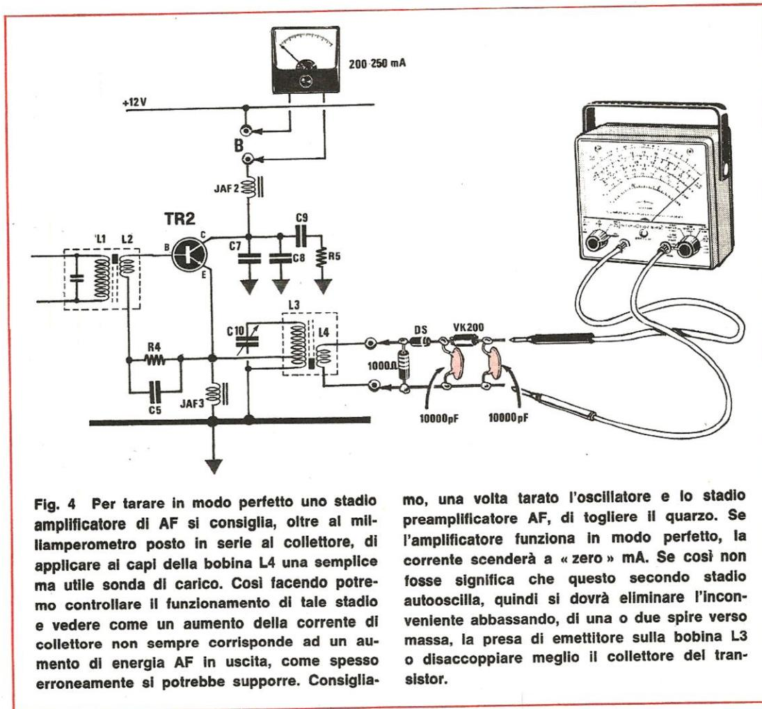
Fig. 4 Per tarare in modo perfetto uno stadio amplificatore di AF si consiglia, oltre al milliamperometro posto in serie al collettore, di applicare ai capi della bobina L4 una semplice ma utile sonda di carico. Così facendo potremo controllare il funzionamento di tale stadio e vedere come un aumento della corrente di collettore non sempre corrisponde ad un aumento di energia AF in uscita, come spesso erroneamente si potrebbe supporre. Consigliamo,
