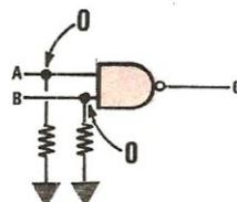
**Fig. 2** Volendo che una delle due entrate A-B di una porta si trovi in condizioni «0», dovremo collegarla a massa. Lo potremo fare tramite una resistenza di basso valore, come vedesi in disegno, nel caso si abbia in seguito necessità di modificare la sua condizione passandola cioè dalla condizione «0» alla condizione «1», oppure direttamente senza alcuna resistenza se si richiede che tale terminale rimanga costantemente sulla condizione «0».
