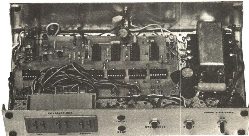
Come si presenta a costruzione ultimata il contatore digitale. In questo prototipo non sono stati utilizzati i «decimi di secondi» per cui i commutatori binari sono solo 6 anziché 7.
