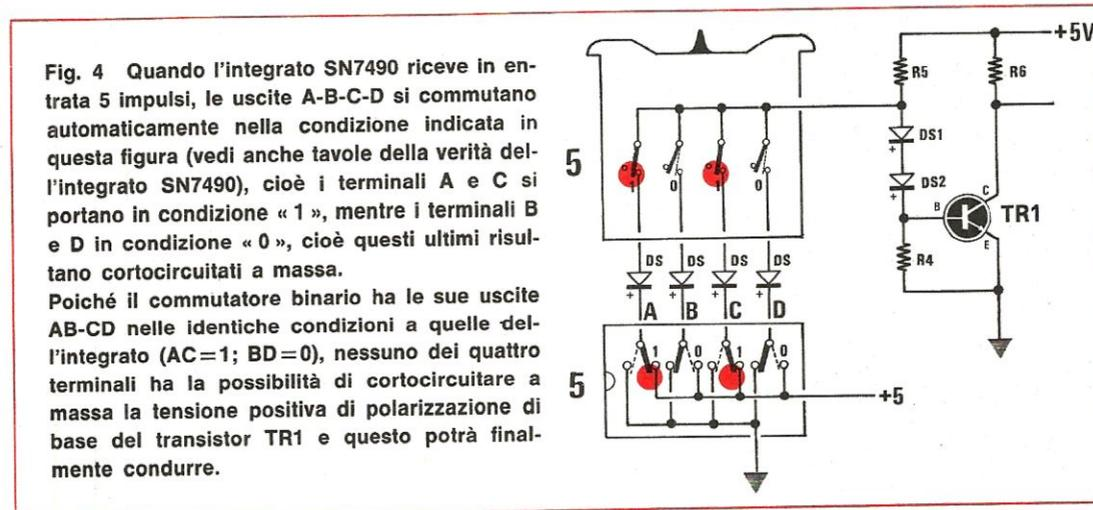
Fig. 4 Quando l'integrato SN7490 riceve in entrata 5 impulsi, le uscite A-B-C-D si commutano automaticamente nella condizione indicata in questa figura (vedi anche tavole della verità dell'integrato SN7490), cioè i terminali A e C si portano in condizione « 1 », mentre i terminali B e D in condizione « 0 », cioè questi ultimi risultano cortocircuitati a massa.
