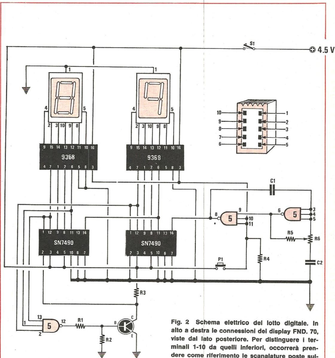
Fig. 2 Schema elettrico del lotto digitale. In alto a destra le connessioni del display FND. 70, viste dal lato posteriore. Per distinguere i terminali 1-10 da quelli inferiori, occorrerà prendere come riferimento le scanalature poste sull'estremo del corpo.
