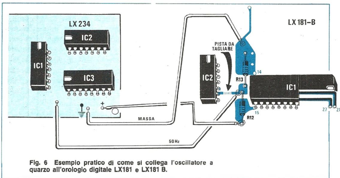
Fig. 6 Esempio pratico di come si collega l'oscillatore a quarzo all'orologio digitale LX181 e LX181 B.
