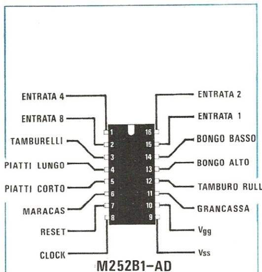
Fig. 1 L'integrato C/Mos M.252 B1-AD si presenta come un normale integrato a 16 piedini. Nel disegno sono visibili i quattro piedini di entrata, 1-2-15-16 e quelli di uscita per i quali abbiamo indicato gli strumenti che questi debbono pilotare il piedino 9 lo dovremo alimentarlo con 5 volt positivi, mentre il piedino 10 con 12 volt negativi, (vedi fig. 2).
