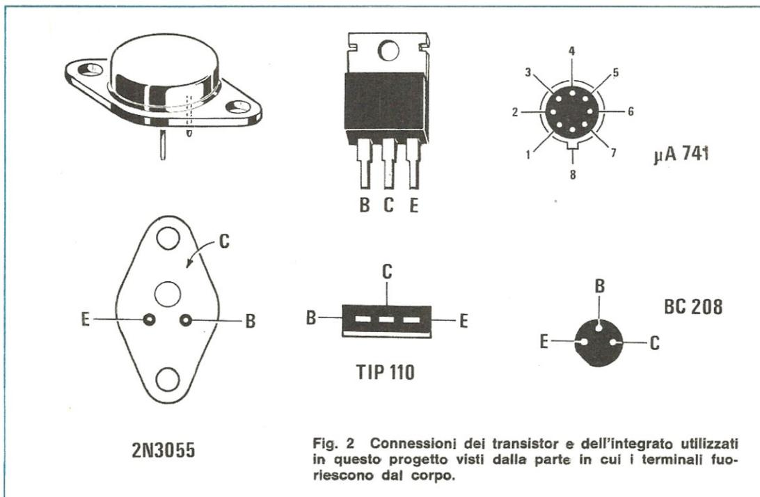
Fig. 2 Connessioni dei transistor e dell'integrato utilizzati in questo progetto visti dalla parte in cui i terminali fuoriescono dal corpo.
