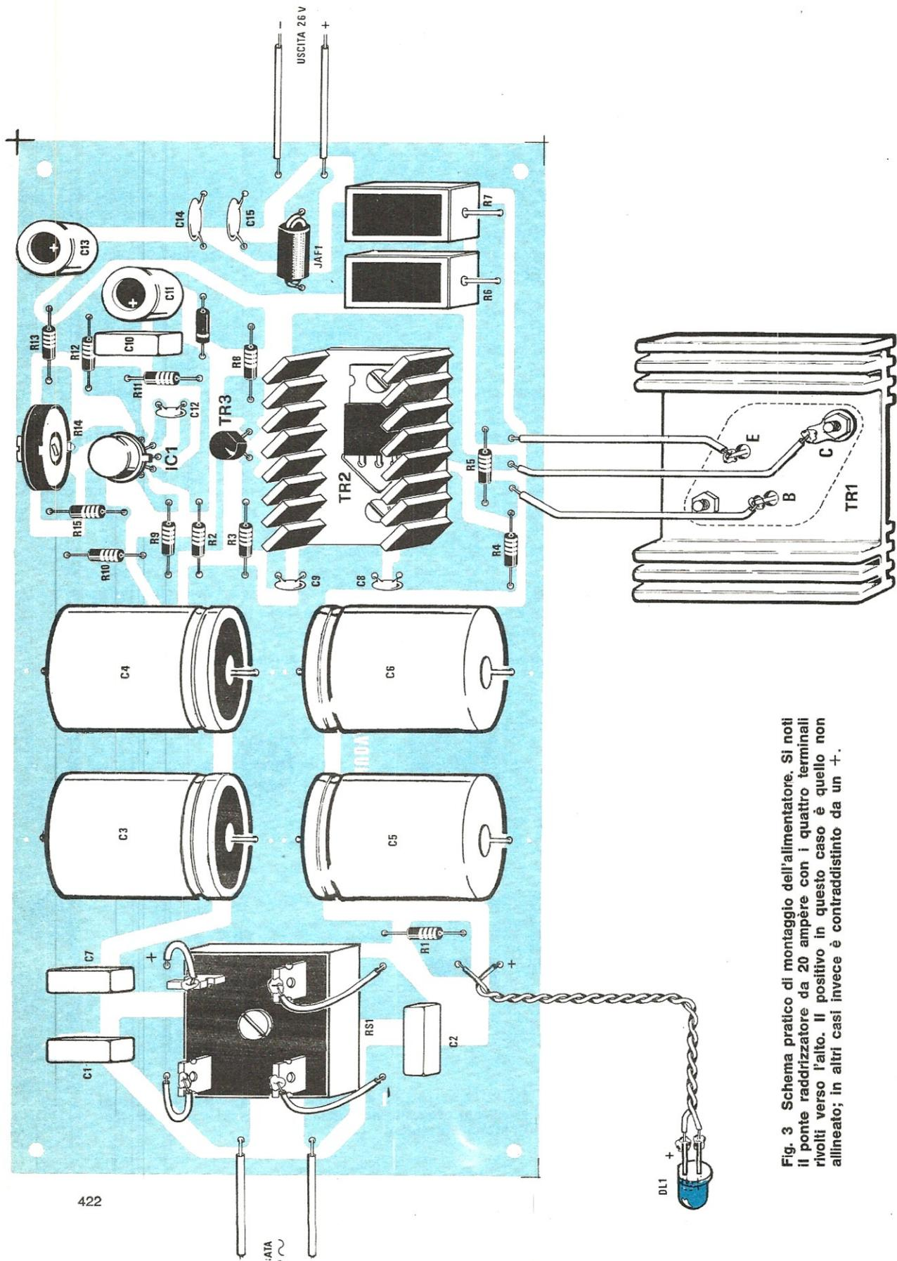
Fig. 3 Schema pratico di montaggio dell'alimentatore. Si noti il ponte raddrizzatore da 20 ampere con i quattro terminali rivolti verso l'alto. Il positivo in questo caso è quello non allineato; in altri casi invece è contraddistinto da un +.
