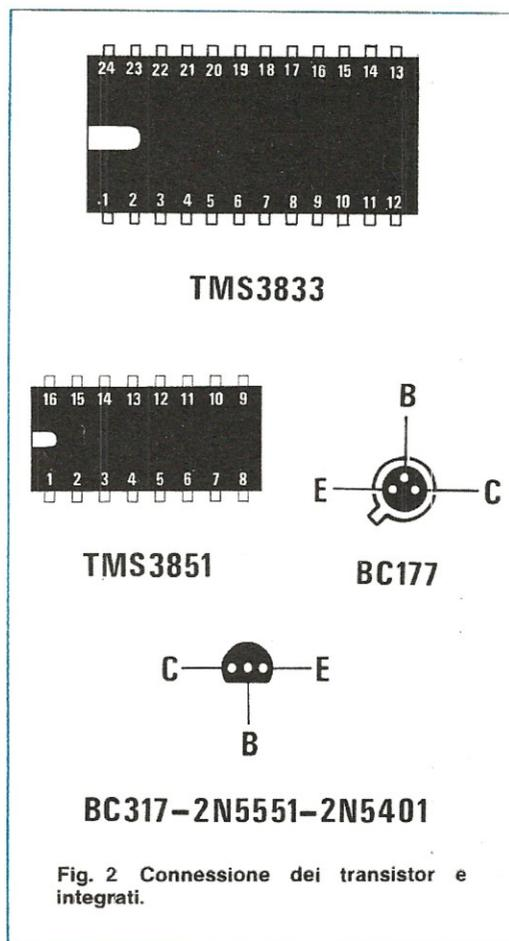
Fig. 2 Connessione dei transistor e integrati.
