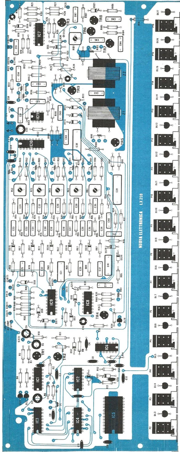
NOTA - In qualche circuito stampato abbiamo constatato che il foro dove va inserito il terminale del condensatore C56 che dovrebbe collegarsi al positivo dei 5 volt, essendoci spostata la matrice va a collegarsi ad un piedino dell'integrato oscillatore. Controllare tale foro prima di stagnare il condensatore, eventualmente rifare il foro in modo che questo terminale si congiunga come vedesi nello schema elettrico al + 5 volt. Tale condensatore è posto sulla sinistra di IC6.
