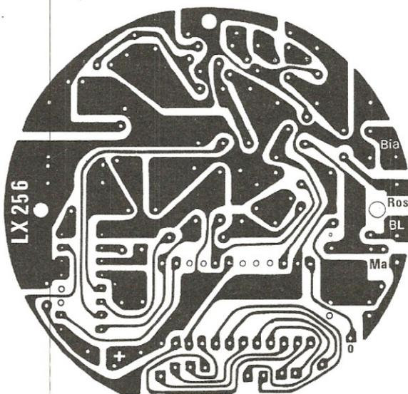
Fig. 4 In basso = Schema pratico di montaggio del circuito. I fili che escono da sopra, andranno tutti a collegarsi al circuito stampato della tastiera, quelli sulla destra invece alla morsettiera del vostro telefono rispettando i colori da noi riportati. Nota sul circuito stampato è presente un ponticello in filo nello spazio che intercorre tra il condensatore C1 e C2.
