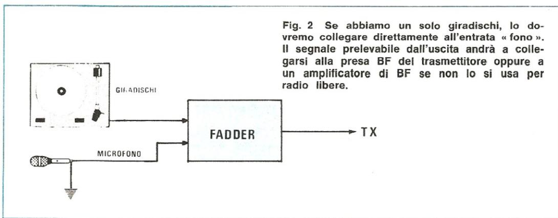
Fig. 2 Se abbiamo un solo giradischi, lo dovremo collegare direttamente all'entrata « fono ». Il segnale prelevabile dall'uscita andrà a collegarsi alla presa BF del trasmettitore oppure a un amplificatore di BF se non lo si usa per radio libere.
