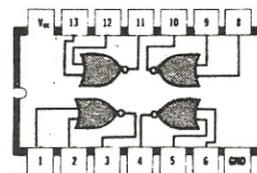
**Fig. 4** Connessione ai terminali dello zoccolo dei quattro nor c-mos contenuti nell'integrato CD.4001.
