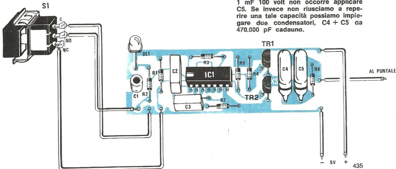
Fig. 4 Schema pratico di montaggio. Se si utilizza per C4 una capacità da 1 mF 100 volt non occorre applicare C5. Se invece non riusciamo a reperire una tale capacità possiamo impiegare due condensatori, C4 + C5 da 470.000 pF cadauno.
