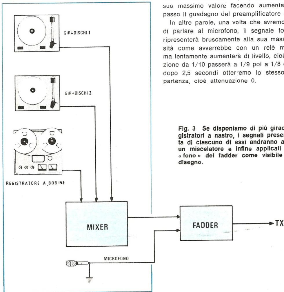
**Fig. 3** Se disponiamo di più giradischi e registratori a nastro, i segnali presenti in uscita di ciascuno di essi andranno applicati ad un miscelatore e infine applicati alla presa « fono » del fadder come visibile in questo disegno.
