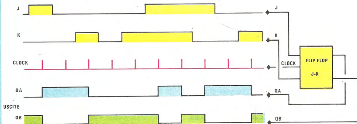
Fig. 3 Il funzionamento di un flip-flop J-K si può a grandi linee così riassumere (vedi grafico). Se all'ingresso J è presente una condizione logica 1, quando al clock giunge un impulso, l'uscita QA si porta alla stessa condizione logica, cioè 1. Se al sopraggiungere di un secondo impulso di clock, l'ingresso J ha modificato la sua condizione logica, passando da 1 a 0, l'uscita QA, come si nota, non viene modificata. Se vogliamo riportare QA in condizione logica 0 è necessario ora invertire la condizione dell'ingresso K da 0 a 1. Se l'ingresso K modifica in seguito la sua condizione logica passando da 1 a 0 le uscite QA-QB non invertono la loro condizione logica iniziale.
