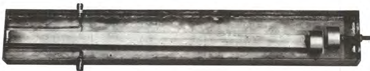
Foto di un filtro passa-banda realizzato con linea a 1/4 d'onda. Come spiegato nell'articolo è importante tenere centrata l'estremità libera della barra con un ritaglio di vetro-nite o di plexiglass, perché diversamente tale barra, come vedesi nella foto, può per motivi meccanici (a per dilatazione del metallo) spostarsi dal centro ed in questo caso la linea si disaccorderà, impedendo quindi il trasferimento del segnale di AF dal trasmettitore all'antenna.
