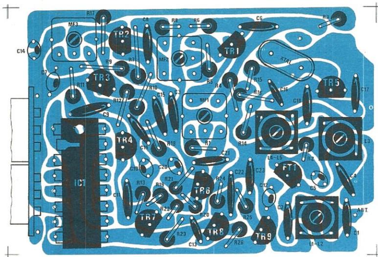
Fig. 2 Disposizione sul circuito stampato dei componenti relativi al ricevitore.
