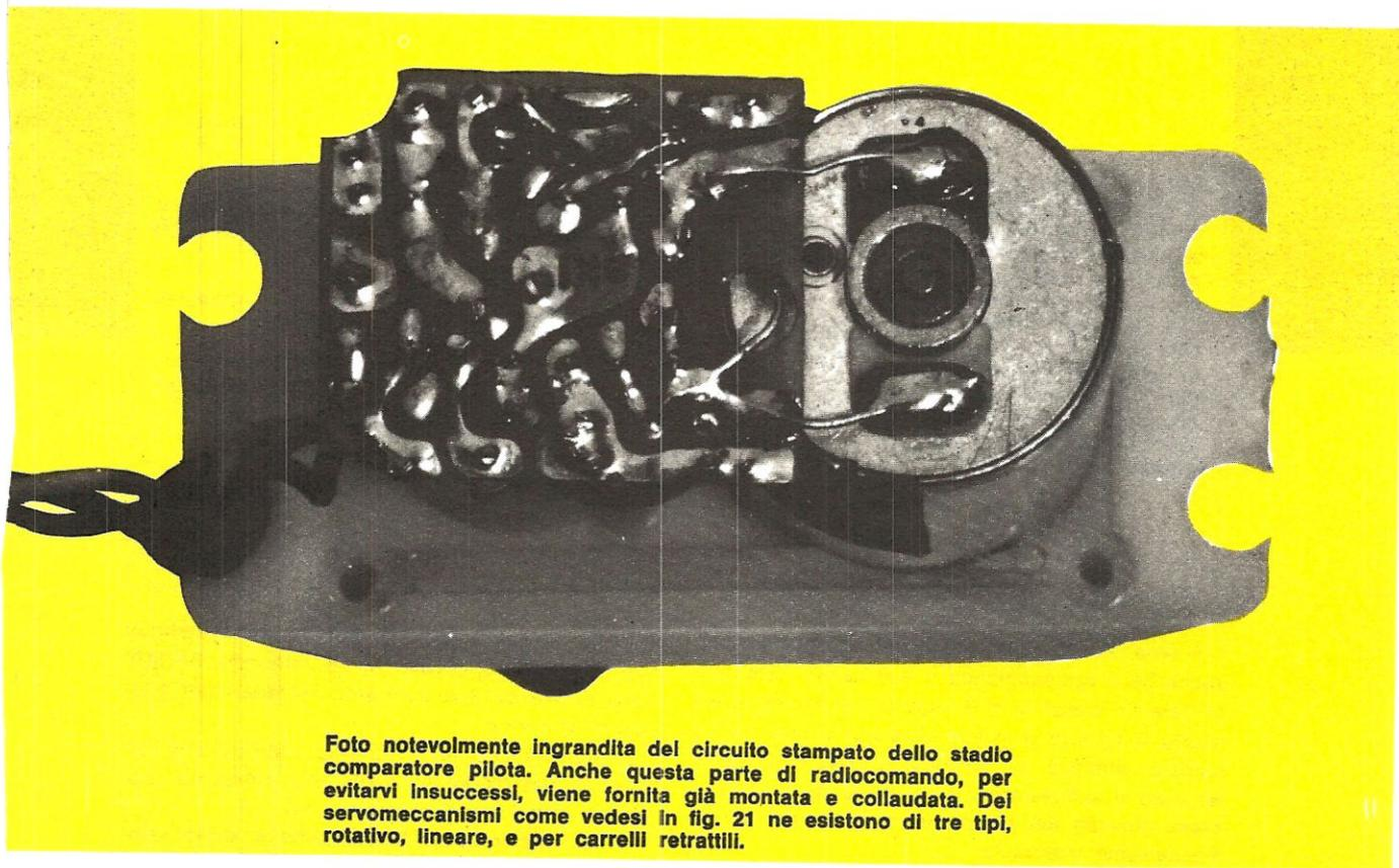
Foto notevolmente ingrandita del circuito stampato dello stadio comparatore pilota. Anche questa parte di radiocomando, per evitarvi insuccessi, viene fornita già montata e collaudata. Dei servomeccanismi come vedesi in fig. 21 ne esistono di tre tipi, rotativo, lineare, e per carrelli retrattili.
