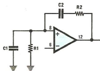
Fig. 2 I componenti del nostro schema che concorrono a determinare la frequenza di oscillazione sono rispettivamente le resistenze R1 e R2 ed i condensatori C1 e C2 (nello schema elettrico di fig. 1 C1 corrisponde al gruppo di condensatori da C1 a C8 e C2 al gruppo da C9 a C15).
