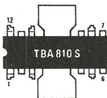
Fig. 3 L'integrato TBA.810 S ha le due alette laterali ripiegate in basso come vedesi in questo disegno. Tali alette, come spiegato nell'articolo, debbono risultare collegate alla massa del circuito stampato.
