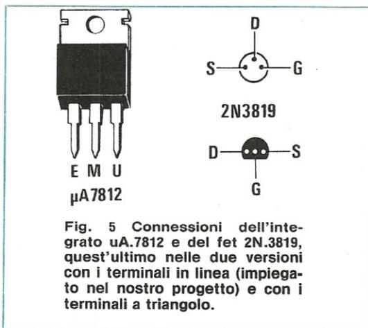
**Fig. 5 Connessioni dell'integrato uA.7812 e del fet 2N.3819, quest'ultimo nelle due versioni con i terminali in linea (impiegato nel nostro progetto) e con i terminali a triangolo.**
