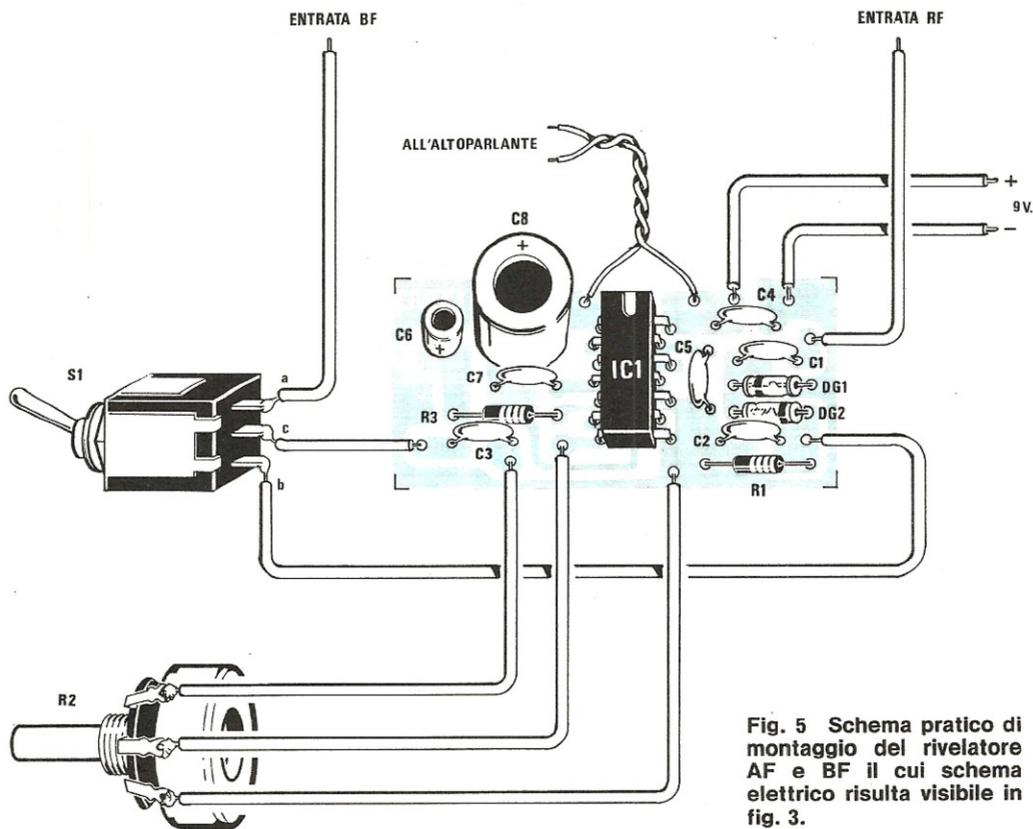
Fig. 5 Schema pratico di montaggio del rivelatore AF e BF il cui schema elettrico risulta visibile in fig. 3.
