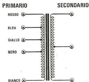
**Fig. 2** I trasformatori della serie 22-23-24-27 hanno a differenza dei primi un avvolgimento secondario provvisto di presa centrale. La massima corrente riportata nella tabella 1 è quella che si riesce a prelevare con raddrizzatori a ponte o con due diodi come visibile in fig. 5 e 6.
