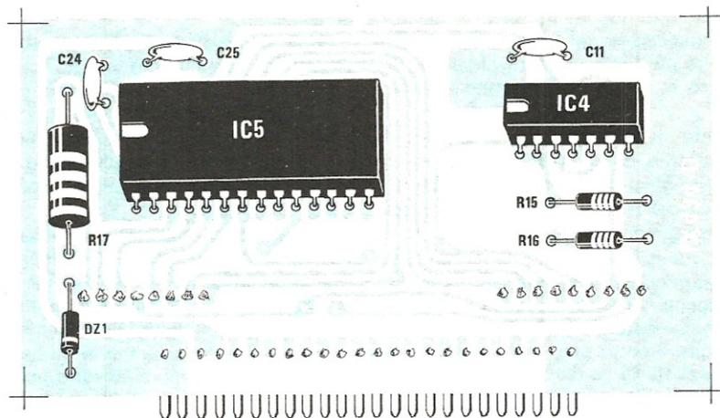
**Fig. 6** Schema pratico di montaggio del telaio di visualizzazione LX434/D visto dal lato dei componenti. Questo stampato è a fori metallizzati pertanto pur risultando un doppia faccia non è necessario eseguire nessun ponticello di collegamento fra le piste superiori e quelle inferiori.
