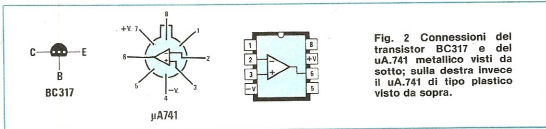
Fig. 2 Connessioni del transistor BC317 e del  $\mu A.741$  metallico visti da sotto; sulla destra invece il  $\mu A.741$  di tipo plastico visto da sopra.
