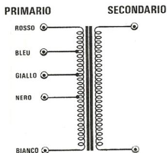
**Fig. 1** I trasformatori il cui codice inizia per 12-13-14 dispongono di un semplice secondario. Applicando la tensione dei 220 volt sui fili bianco-nero otterremo la massima tensione in uscita; applicandola invece sui fili bianco-rosso otterremo la minima tensione, come riportato nella tabella 1.
