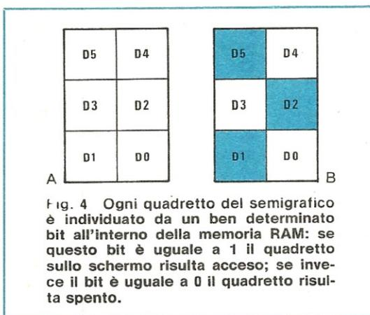
Fig. 4 Ogni quadretto del semigrafico è individuato da un ben determinato bit all'interno della memoria RAM: se questo bit è uguale a 1 il quadretto sullo schermo risulta acceso; se invece il bit è uguale a 0 il quadretto risulta spento.
