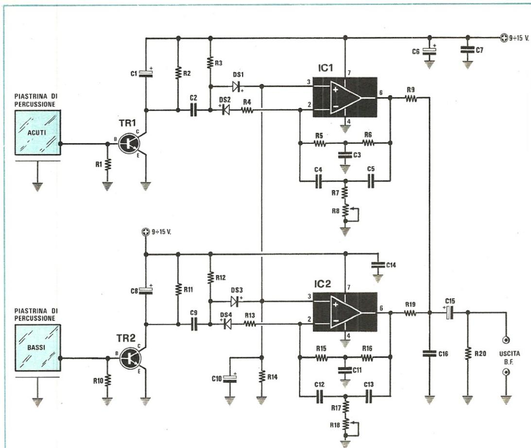
Schema elettrico del bongo. Le due piastrine di percussione sono ottenute con due ritagli di circuito stampato a doppia faccia la cui parte sottostante viene impiegata come schermo collegando il rame a massa.
