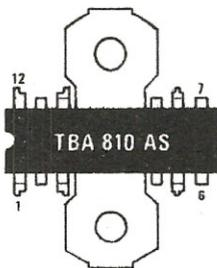
Fig. 4 Lo stesso integrato, se porta la sigla TBA.810 AS, si differenzia dal tipo S per avere le due alette disposte in orizzontale con due fori agli estremi in cui può essere inserita una vite.
