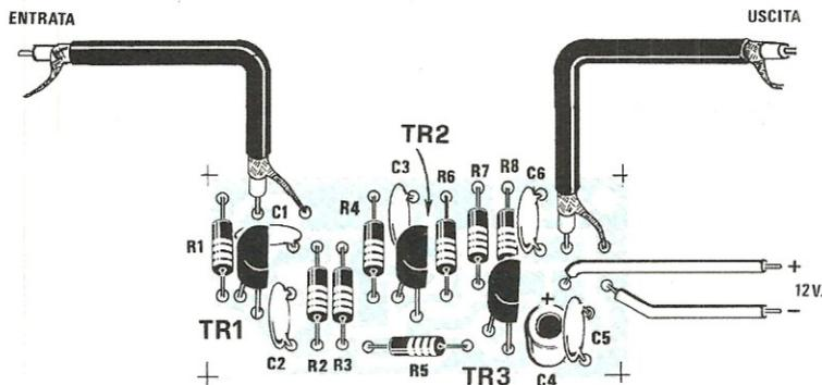
**Fig. 3** Schema pratico di montaggio. I transistor, come vedesi in questo disegno, vanno collocati con la parte semicircolare del corpo rivolta verso sinistra. Come accennato nell'articolo, se il preamplificatore verrà utilizzato su un'autovettura, dovrà essere racchiuso dentro una scatola metallica in modo da schermarlo totalmente.
