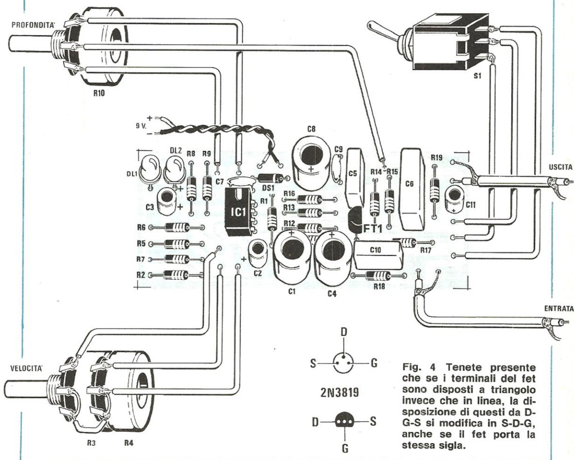
Fig. 4 Tenete presente che se i terminali del fet sono disposti a triangolo invece che in linea, la disposizione di questi da D-G-S si modifica in S-D-G, anche se il fet porta la stessa sigla.
