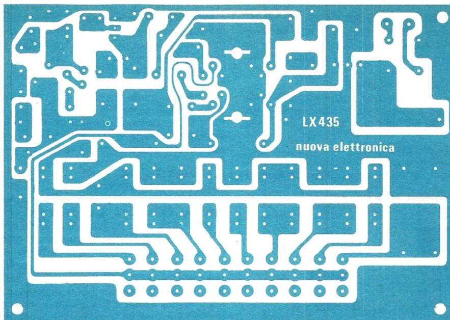
**Fig. 6** Disegno a grandezza naturale del circuito stampato necessario per la realizzazione di questo oscillatore di BF. Il circuito stampato è in vetronite e viene fornito già forato e completo di disegno serigrafico.
