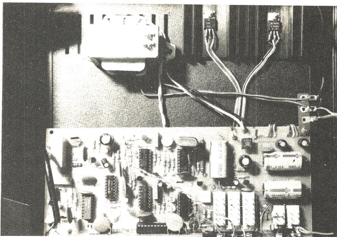
**Fig. 4** In alto. In questa foto ripresa dall'alto possiamo vedere il trasformatore di alimentazione e l'aletta di raffreddamento per i due integrati stabilizzatori posti subito dietro il circuito base all'interno del mobile.
