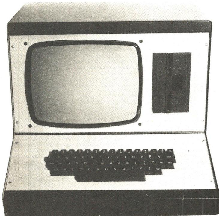
**Il mobile metallico per il nostro microcomputer viene fornito con le due mascherine frontali già forate, pronte per ricevere il tubo del cinescopio, un floppy-disk da 5 pollici e la tastiera alfanumerica presentata sul n. 72.**
