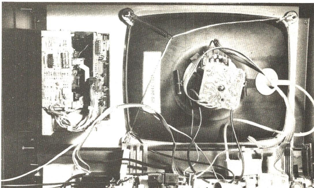
Guardando il mobile dalla parte posteriore possiamo renderci conto di come andrà fissato il filo flessibile diagonalmente sul corpo del tubo e di come verrà agganciata la molla per tenerlo teso. A questo filo dovremo stagnare l'estremità del filo di massa che esce dal telaio TK4 posto sullo zoccolo del tubo.
