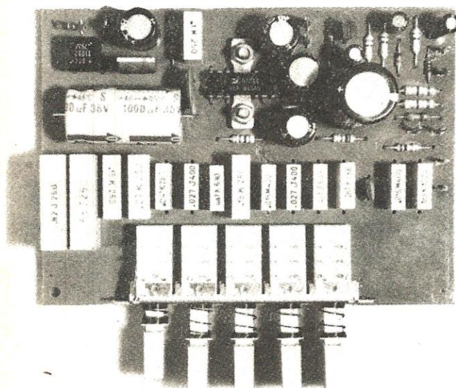
**Come si presenta a montaggio ultimato questo semplice oscillatore di BF. Si notino in questa foto i condensatori posti in prossimità del commutatore a slitta, necessari per ottenere le cinque frequenze richieste.**
