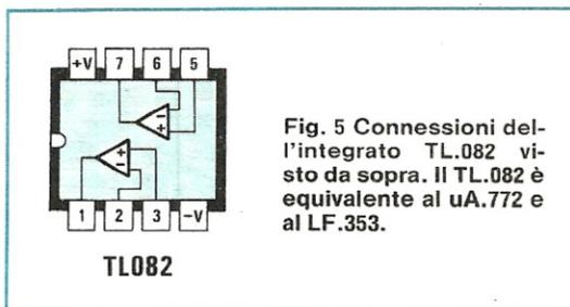
Fig. 5 Connessioni dell'integrato TL.082 visto da sopra. Il TL.082 è equivalente al uA.772 e al LF.353.
