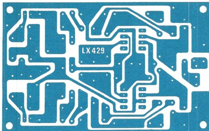
Fig. 3 Disegno a grandezza naturale del circuito stampato necessario per la realizzazione del bongo elettronico. Come saprete i nostri circuiti sono realizzati su supporti in vetronite e vengono forniti già forati e completi di disegno serigrafico con le sigle dei relativi componenti.
