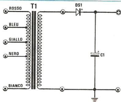
**Fig. 3** Un esempio di come si possa ottenere una tensione continua raddrizzando l'alternata con un solo diodo. Si tenga presente che la tensione continua che otterremo ai capi del condensatore elettrolitico di livellamento risulterà di 1,41 volte maggiore rispetto al valore efficace della tensione alternata presente sul secondario.
