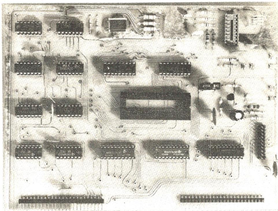
Nella foto qui sopra possiamo vedere la scheda interfaccia video come si presenta a montaggio ultimato. Sulla destra in alto è visibile lo zoccolo necessario per ricevere l'integrato LM1889 (IC15) che dovremo inserire solo se volessimo utilizzare il TV casalingo in sostituzione del monitor. Il connettore maschio a 20 poli che vediamo in basso sulla destra della scheda serve per collegarsi alla tastiera alfanumerica utilizzando l'apposita piattina.
