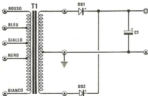
**Fig. 6** Se volessimo ricavare da un trasformatore con presa centrale una tensione unica, potremo impiegare due soli diodi collegandoli come vedesi in questo disegno. Ricordatevi che la tensione continua è sempre maggiorata di 1,41 rispetto al valore efficace dell'alternata.
