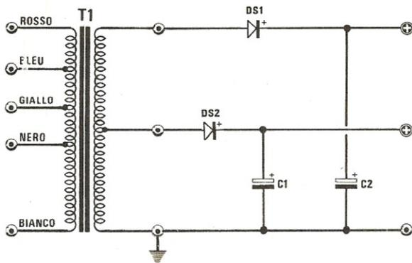
**Fig. 8** Se ci interessa ricavare due tensioni una doppia rispetto all'altra da un unico secondario, dovremo collegare un diodo raddrizzatore alla presa centrale ed uno all'estremo dell'avvolgimento, collegando l'estremo opposto a massa.
