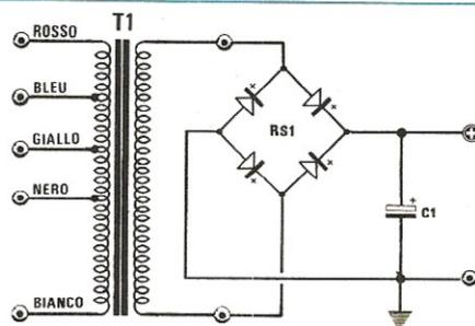
**Fig. 4** Applicando sul secondario di un trasformatore con avvolgimento unico un ponte raddrizzatore oppure quattro diodi collegati come riportato in questo schema, potremo raddrizzare entrambe le semionde della tensione alternata e prelevare così dall'alimentatore una maggior corrente.
