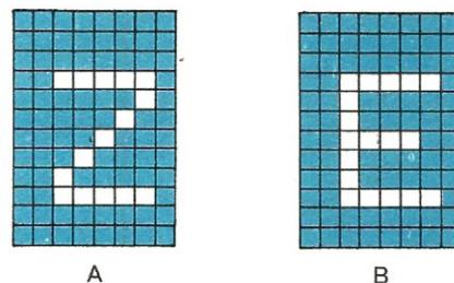
**Fig. 2** Le lettere e i numeri sul nostro schermo possono essere scritti anche in negativo e questo si ottiene molto facilmente spegnendo i led che nella figura sopra risultavano accesi ed accendendo al loro posto quelli che in tale figura risultavano spenti. In pratica, quando utilizzeremo il Basic, le lettere in negativo verranno sfruttate dal microcomputer per porci delle domande.
