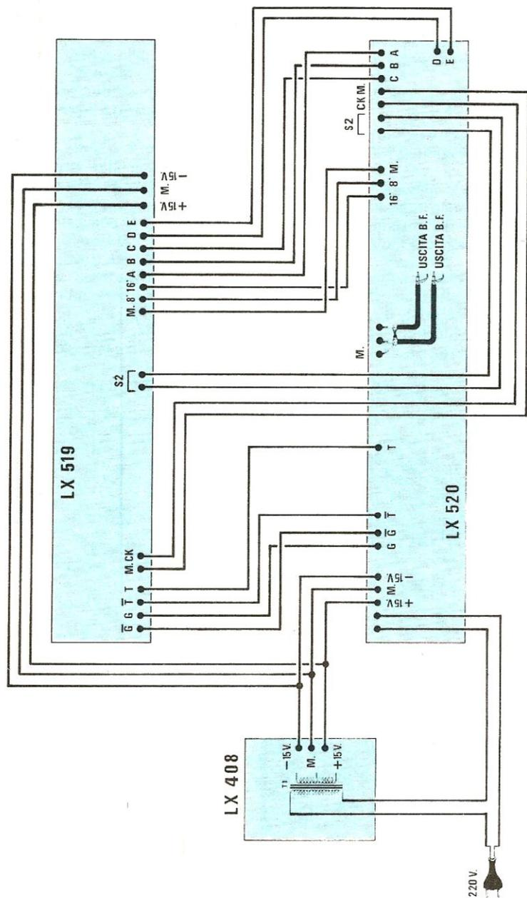
Fig. 15 I due circuiti stampati LX.519 e LX.520 dovranno essere collegati tra di loro utilizzando dei normali fili di rame isolati in plastica. In questo disegno abbiamo riportato i diversi terminali, indicati con le lettere e i numeri che saranno serigrafati sui due circuiti stampati. Per alimentare questo synthesizer consigliamo di utilizzare l'alimentatore stabilizzato LX.408.
