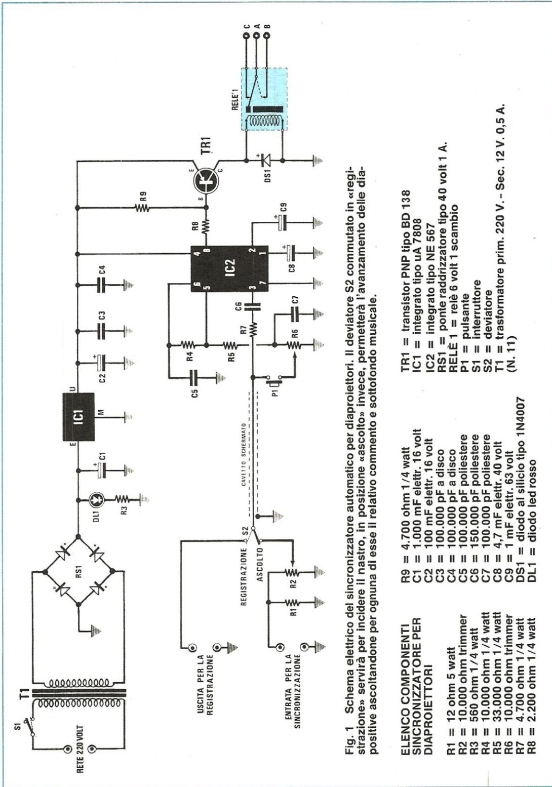
Fig. 1 Schema elettrico del sincronizzatore automatico per diaproiettori. Il deviatore S2 commutato in «registrazione» servirà per incidere il nastro, in posizione «ascolto» invece, permetterà l'avanzamento delle diapositive ascoltandone per ognuna di esse il relativo commento e sottofondo musicale.
