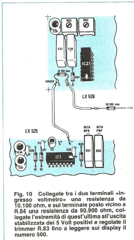
Fig. 10 Collegate tra i due terminali «ingresso voltmetro» una resistenza da 10.100 ohm, e sul terminale posto vicino a R.84 una resistenza da 90.900 ohm, collegate l'estremità di quest'ultima all'uscita stabilizzata dei 5 Volt positivi e regolate il trimmer R.83 fino a leggere sui display il numero 500.
