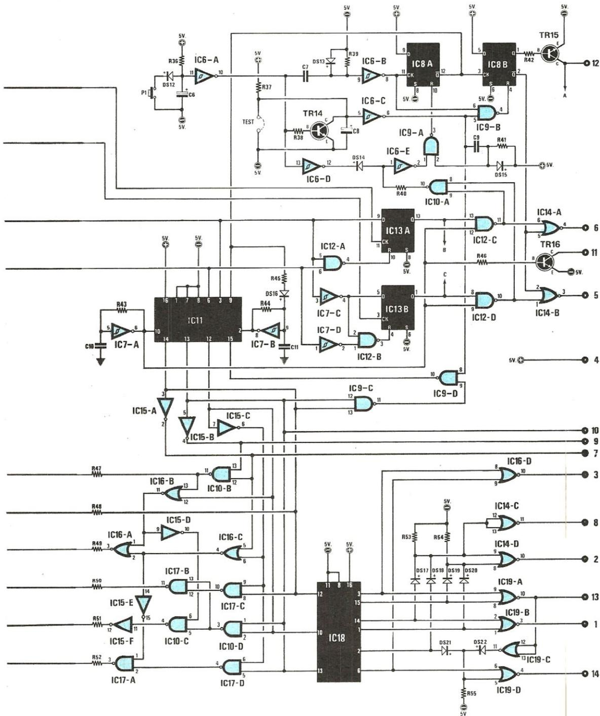
I numeri che appaiono sulla destra di tale schema andranno a collegarsi tramite una pinnata a 14 fili allo schema elettrico del visualizzatore riportato in fig. 2.
