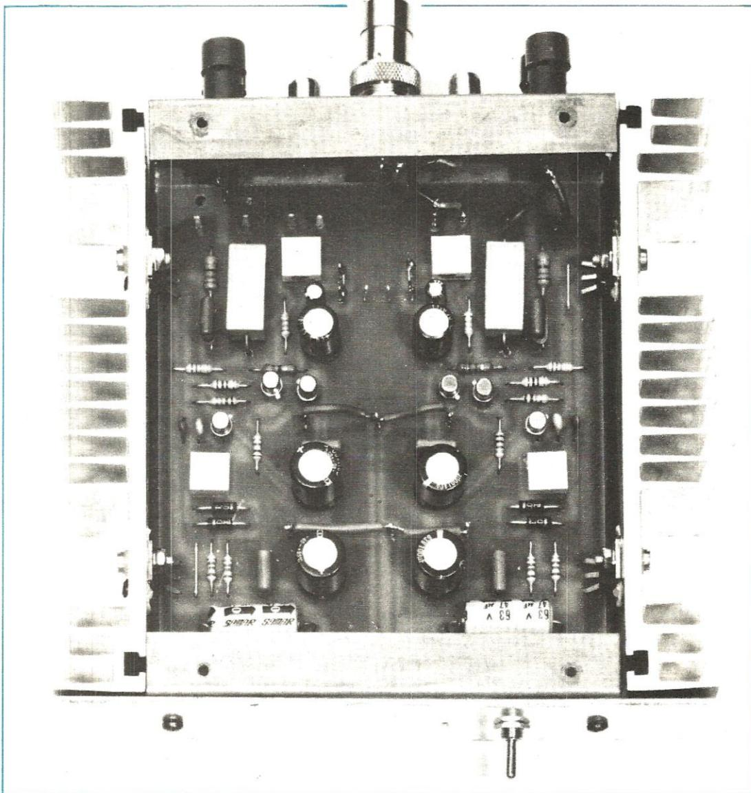
8° = Dopo aver eseguito questi collegamenti accendete l'alimentatore, e con un cacciavite tarate l'altro trimmer R11 fino a che anche questo canale assorba una corrente di 100 milliamper.
