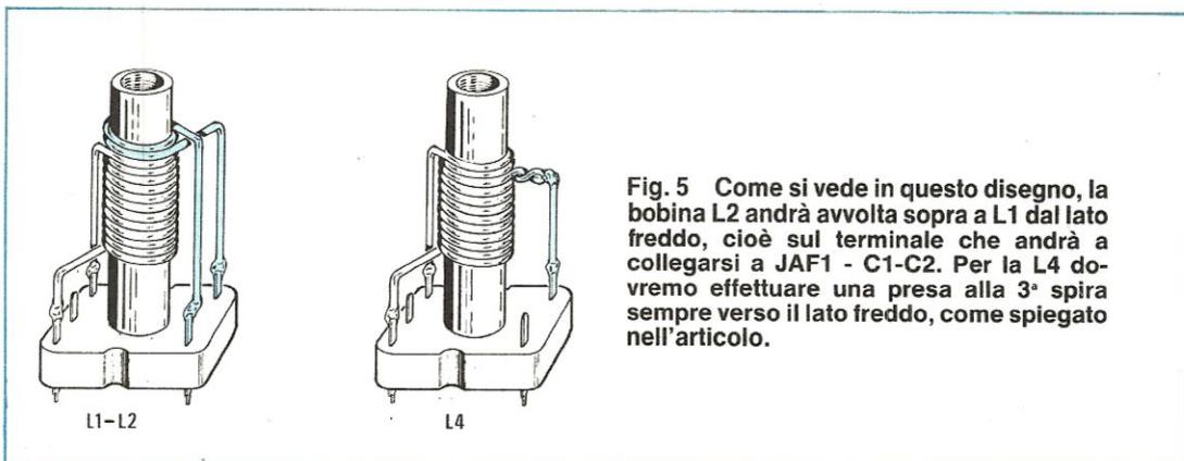
Fig. 5 Come si vede in questo disegno, la bobina L2 andrà avvolta sopra a L1 dal lato freddo, cioè sul terminale che andrà a collegarsi a JAF1 - C1-C2. Per la L4 dovremo effettuare una presa alla 3<sup>a</sup> spira sempre verso il lato freddo, come spiegato nell'articolo.
