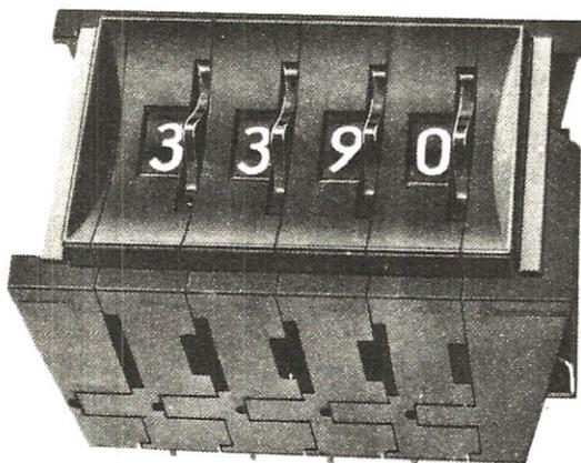
**Fig. 7** Tutti i commutatori binari dispongono di quattro terminali contrassegnati con 8-C-4-2-1 corrispondenti alle uscite D-C-B-A di un qualsiasi integrato contatore divisore. Come vedesi in fig. 6 ai contatori divisori X6 non dovremo collegare il terminale 8 = D.
