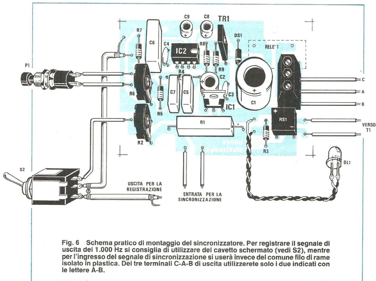
**Fig. 6** Schema pratico di montaggio del sincronizzatore. Per registrare il segnale di uscita dei 1.000 Hz si consiglia di utilizzare del cavetto schermato (vedi S2), mentre per l'ingresso del segnale di sincronizzazione si userà invece del comune filo di rame isolato in plastica. Dei tre terminali C-A-B di uscita utilizzerete solo i due indicati con le lettere A-B.
