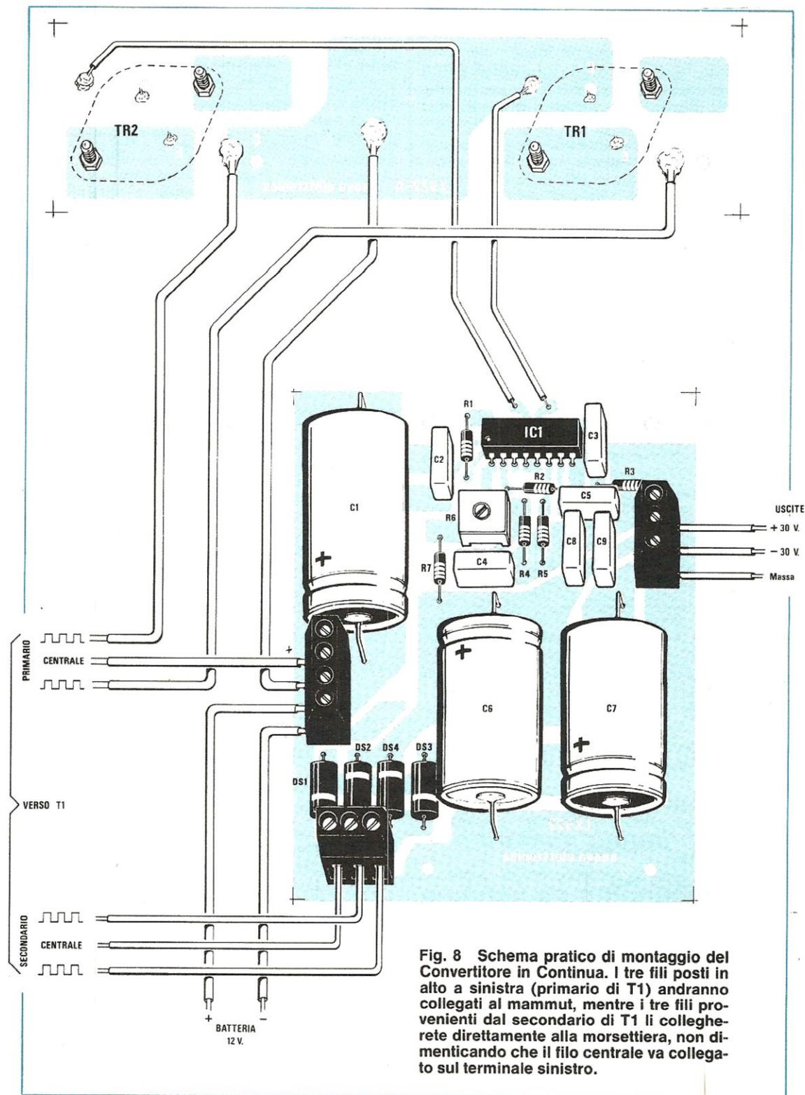
Fig. 8 Schema pratico di montaggio del Convertitore in Continua. I tre fili posti in alto a sinistra (primario di T1) andranno collegati al mammut, mentre i tre fili provenienti dal secondario di T1 li collegherete direttamente alla morsettiere, non dimenticando che il filo centrale va collegato sul terminale sinistro.
