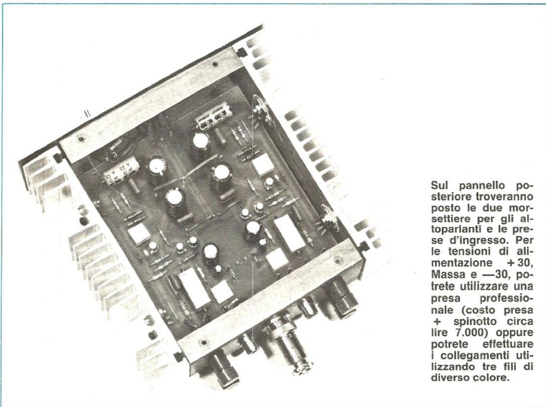
Sul pannello posteriore troveranno posto le due morsettiere per gli altoparlanti e le prese d'ingresso. Per le tensioni di alimentazione +30, Massa e -30, potrete utilizzare una presa professionale (costo presa + spinotto circa lire 7.000) oppure potrete effettuare i collegamenti utilizzando tre fili di diverso colore.
