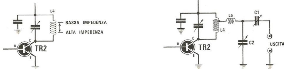
Fig. 2 - Quando l'impedenza di collettore risulta, come nel nostro caso, maggiore di 52 ohm, occorre accordare il collettore con una bobina e una capacità, prelevando il segnale per l'uscita sulla seconda o terza spira dal lato freddo come vedesi in figura.
