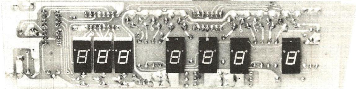
**Questo è il primo ed unico provatransistor in grado di individuare automaticamente la disposizione dei terminali E-B-C di qualsiasi transistor, di indicarne la polarità e il beta.**
