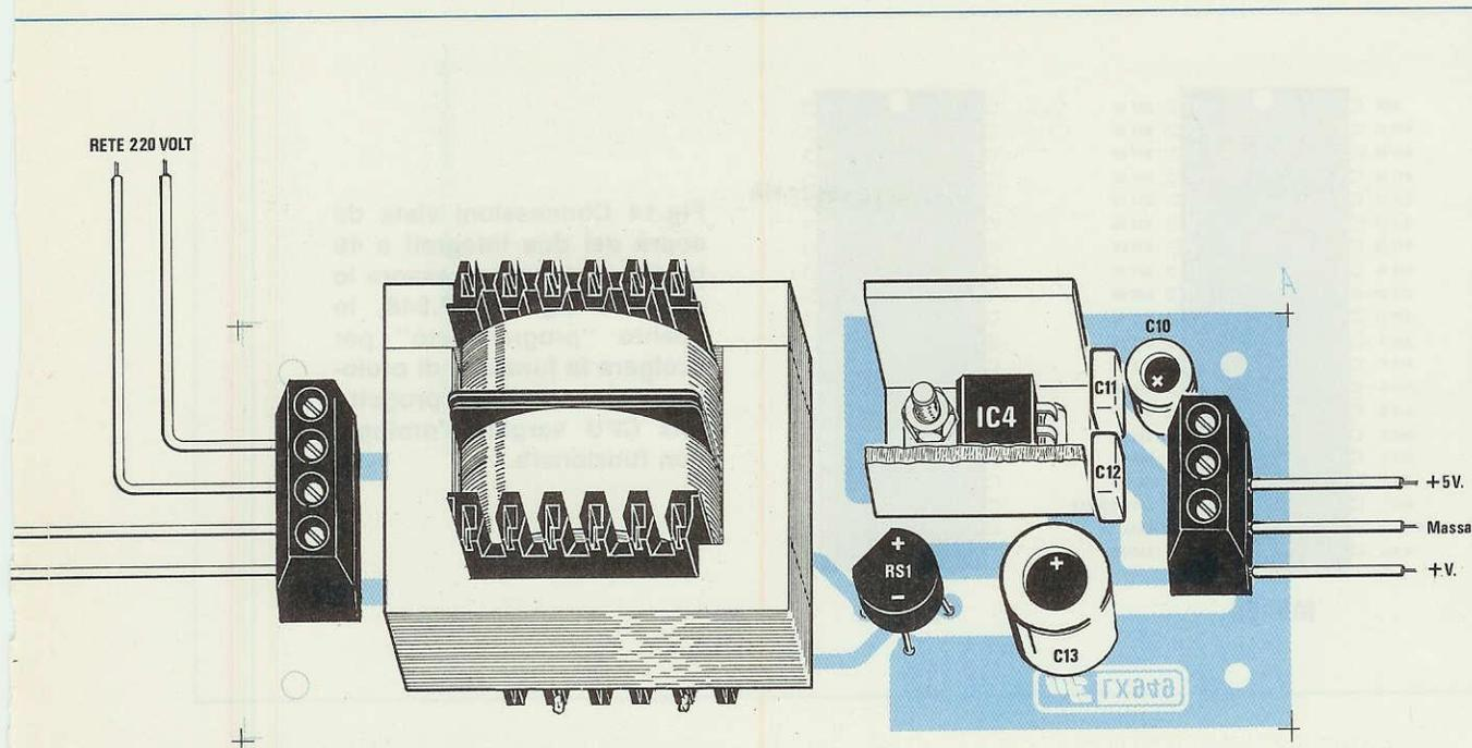
Fig. 13 Schema pratico di montaggio dell'alimentatore. Quando fisserete l'integrato stabilizzatore sopra alla sua aletta di raffreddamento, dovrete controllare che i suoi terminali non entrino in contatto con il metallo dell'aletta stessa. Ricordatevi che la tensione stabilizzata dei 5 volt andrà prelevata dal morsetto posto in alto e quella "non stabilizzata" dal morsetto in basso indicato con il segno +.
