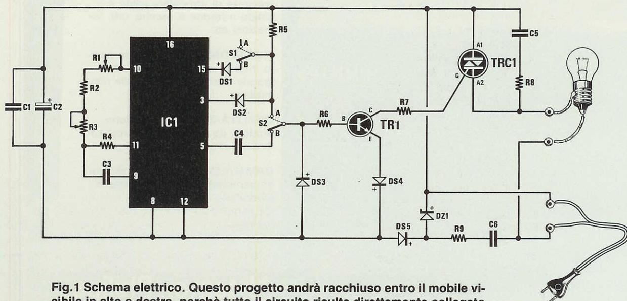
Fig.1 Schema elettrico. Questo progetto andrà racchiuso entro il mobile visibile in alto a destra, perchè tutto il circuito risulta direttamente collegato alla rete dei 220 volt.
