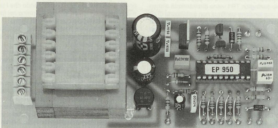
**Fig.5** Foto di un circuito stampato di elettromagnetoterapia già pronto per essere montato all'interno del mobile. I terminali visibili in basso a destra del circuito stampato, serviranno per il collegamento al commutatore rotativo S2.
