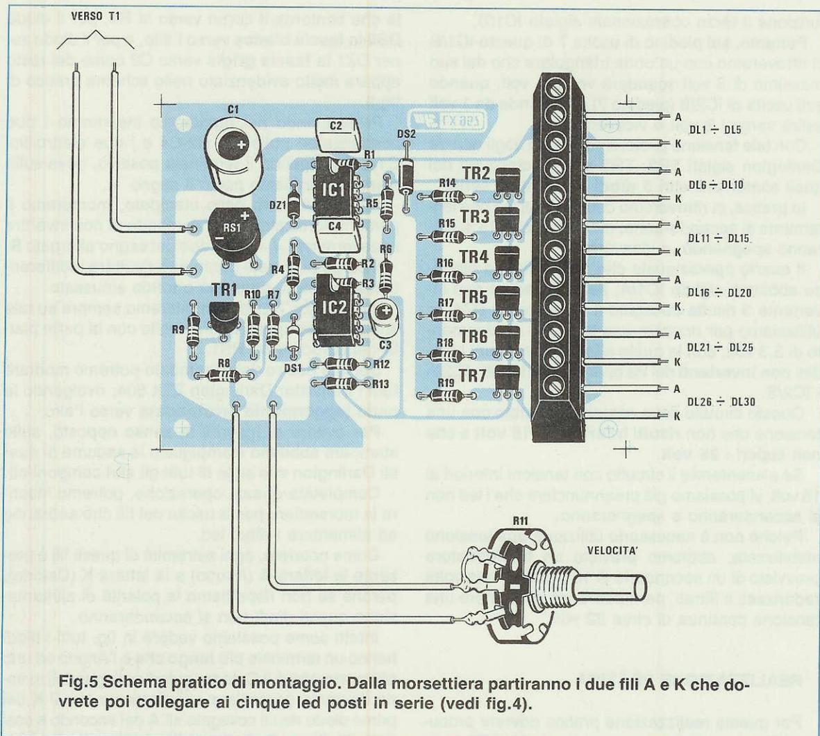
**Fig.5** Schema pratico di montaggio. Dalla morsetteria partiranno i due fili A e K che dovrete poi collegare ai cinque led posti in serie (vedi fig.4).
