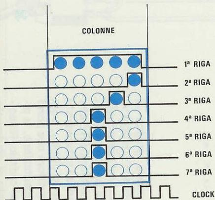
Fig.6 A far accendere sui display il numero 7, provvederà l'integrato IC3 fornendo una tensione positiva alla prima fila e collegando a massa i terminali dei 5 led; quando fornirà tensione positiva alla seconda fila, collegherà a massa l'ultimo diodo led, e così via.
