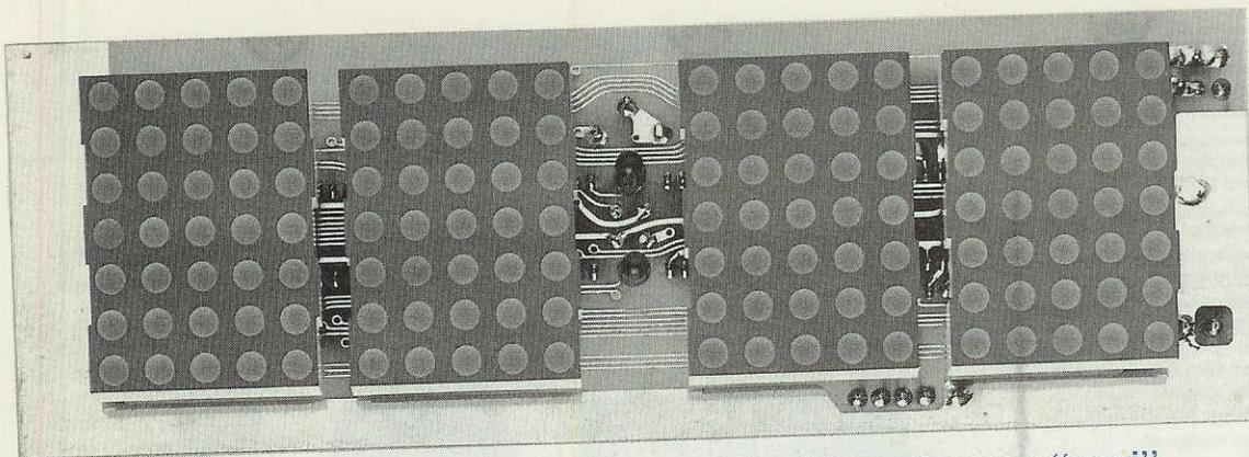
Usando quattro display da 38x53 millimetri è possibile realizzare un "maxi" orologio digitale i cui numeri risulteranno visibili anche a notevole distanza. Per evitare che l'orologio si fermi in mancanza della tensione di rete è stata inserita nello stampato una pila Ni-Cd ricaricabile automaticamente, che provvederà a tenerlo in funzione per circa 4 mesi.
