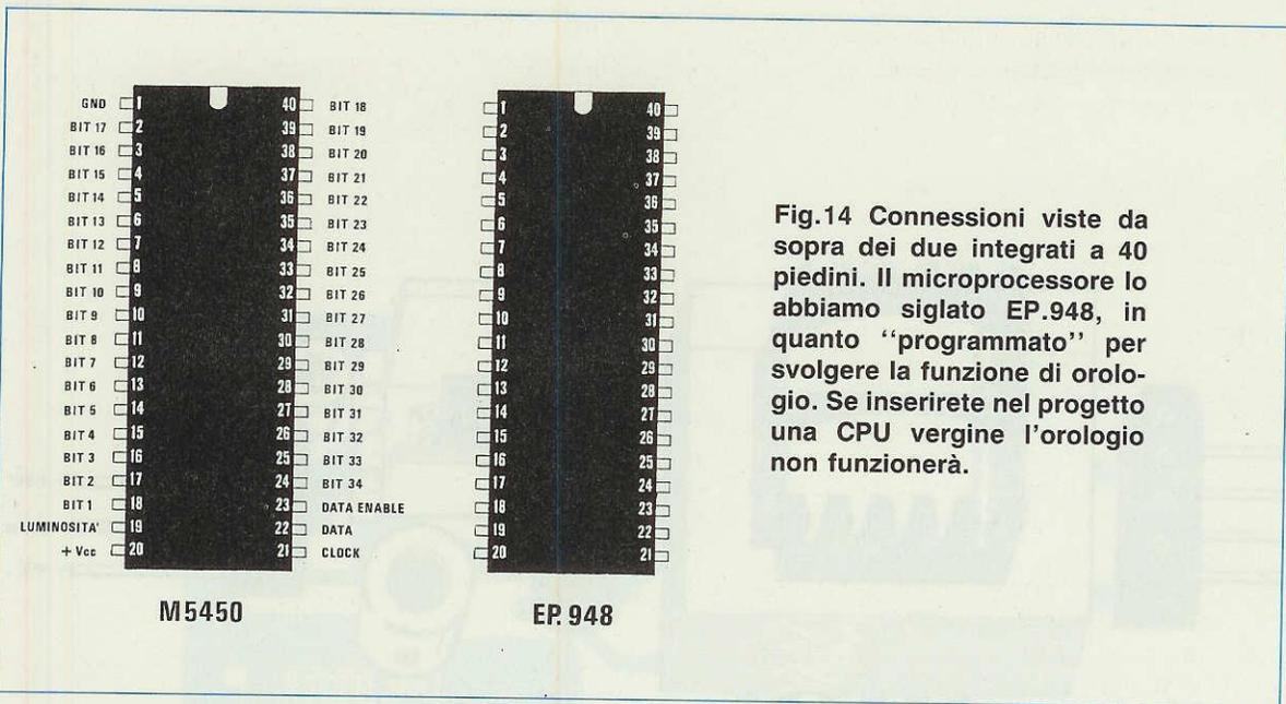
Fig.14 Connessioni viste da sopra dei due integrati a 40 piedini. Il microprocessore lo abbiamo siglato EP.948, in quanto "programmato" per svolgere la funzione di orologio. Se inserirete nel progetto una CPU vergine l'orologio non funzionerà.
