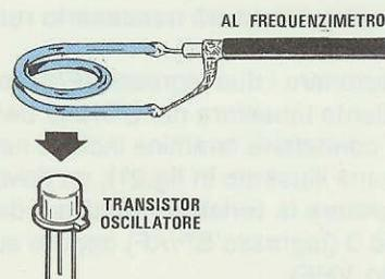
Fig.19 Si potrebbe tentare di avvolgere lo stesso "link" sopra al transistor oscillatore.
