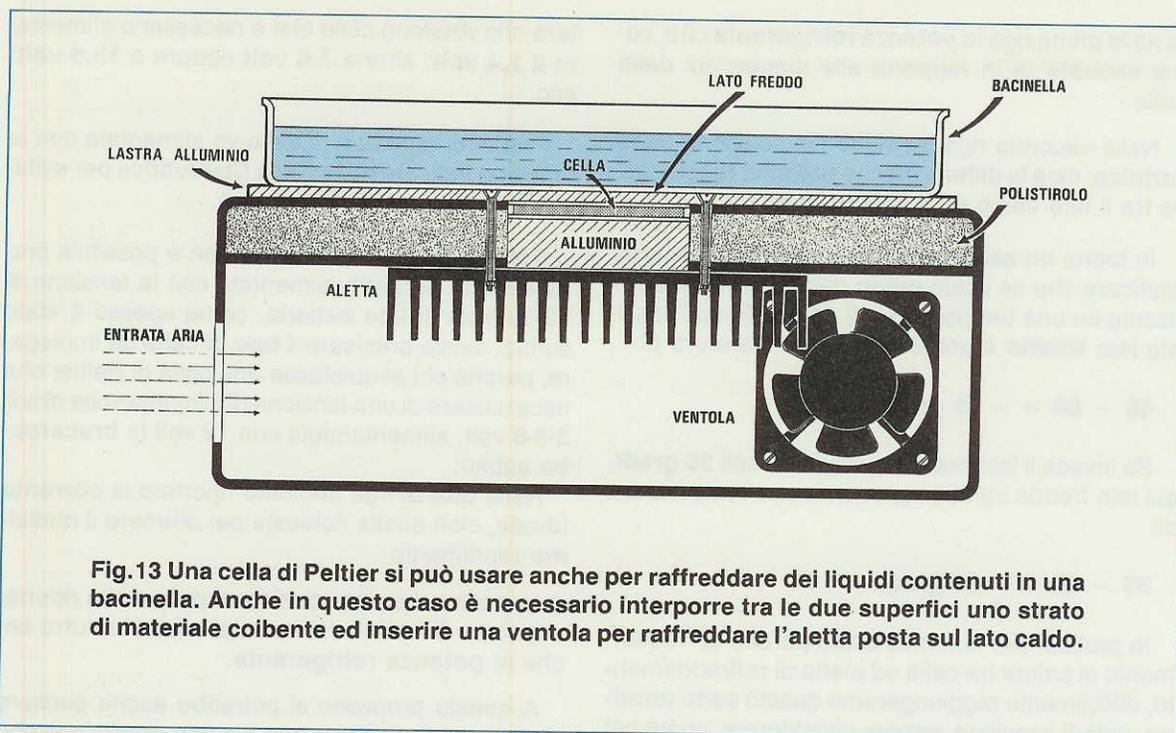
Fig.13 Una cella di Peltier si può usare anche per raffreddare dei liquidi contenuti in una bacinella. Anche in questo caso è necessario interporre tra le due superfici uno strato di materiale coibente ed inserire una ventola per raffreddare l'aletta posta sul lato caldo.
