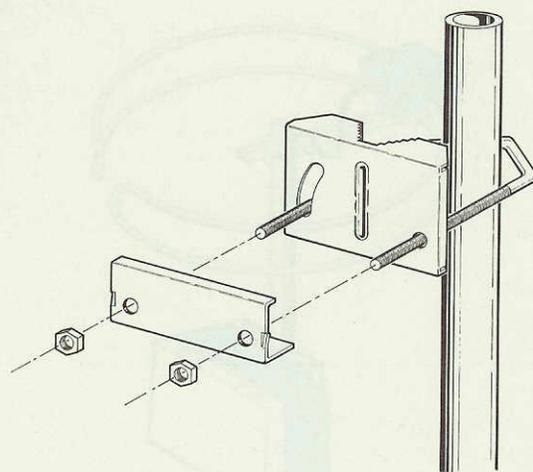
**Fig.8** Assieme alle antenne vi verranno fornite anche le due staffe di fissaggio per il palo di sostegno. Posta la forcella a U sul palo, sul lato opposto dovete inserire la staffa e la squadretta per serrare l'asta collegata alla scatola di derivazione.
