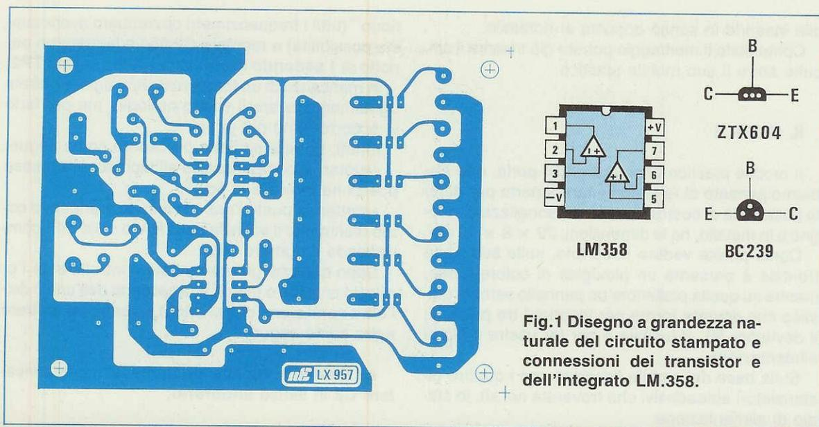
Fig.1 Disegno a grandezza naturale del circuito stampato e connessioni dei transistor e dell'integrato LM.358.
