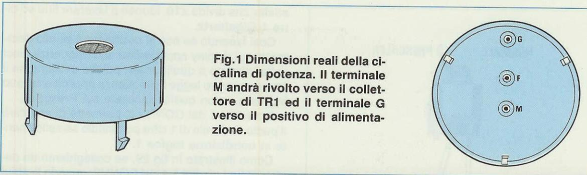
**Fig. 1** Dimensioni reali della cicalina di potenza. Il terminale M andrà rivolto verso il collettore di TR1 ed il terminale G verso il positivo di alimentazione.
