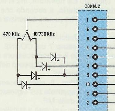
Fig.23 Utilizzando un secondo deviatore e pochi diodi 1N.4150, è possibile predisporre il frequenzimetro per sottrarre due diversi valori di MF. Nell'esempio riportato abbiamo programmato il frequenzimetro per "sottrarre" 470 KHz o 10.730 KHz.
