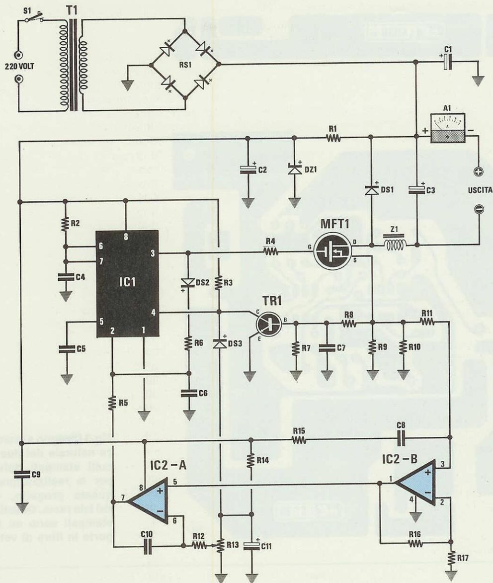
Fig.2 Schema elettrico dell'alimentatore a corrente costante e connessioni degli integrati visti da sopra. Il Mos-Power P.741 ed il diodo BY.359 (vedi DS1) andranno montati su un'aletta di raffreddamento (vedi fig.6).
