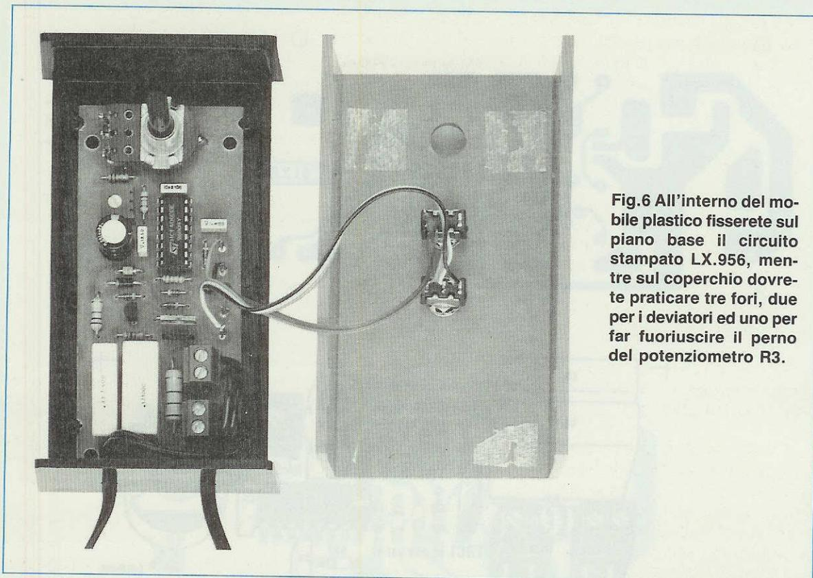
**Fig.6** All'interno del mobile plastico fisserete sul piano base il circuito stampato LX.956, mentre sul coperchio dovrete praticare tre fori, due per i deviatori ed uno per far fuoriuscire il perno del potenziometro R3.
