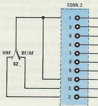
Fig.22 Se collegherete questo frequenzimetro ad un qualsiasi ricevitore per conoscere la frequenza di sintonia, dovrete anche considerare il valore di MF. Nell'esempio riportato abbiamo programmato il frequenzimetro per "sottrarre" 455 KHz (vedi tabella a sinistra).
