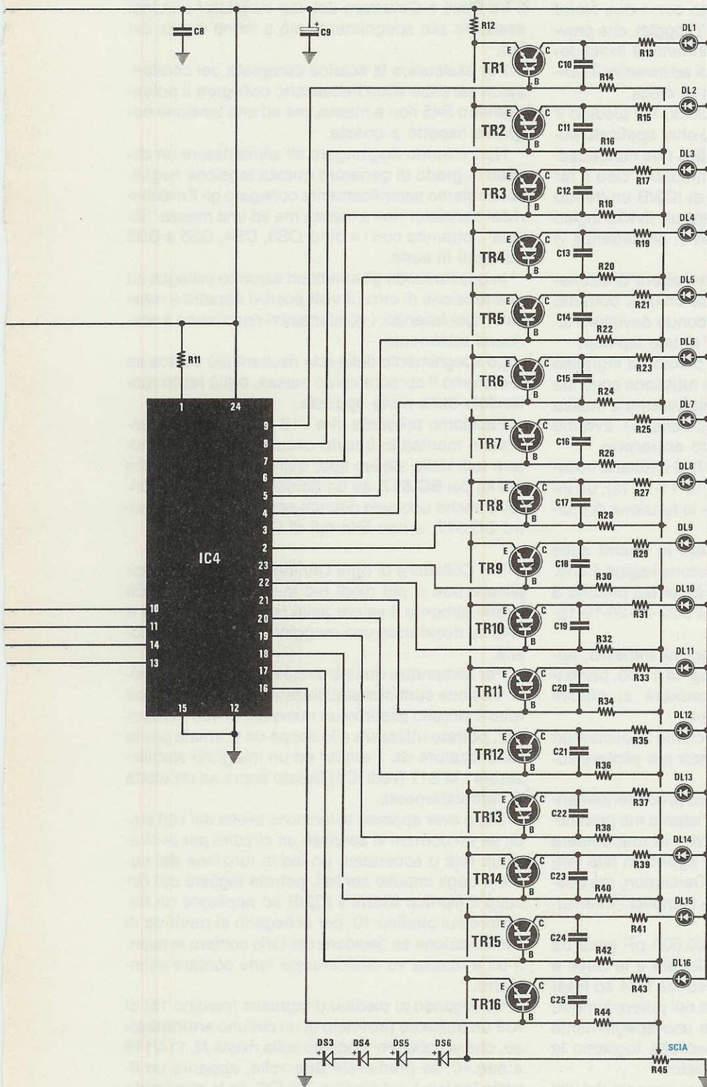
Fig.1 Schema elettrico per realizzare il progetto delle luci ruotanti con scia luminosa.
