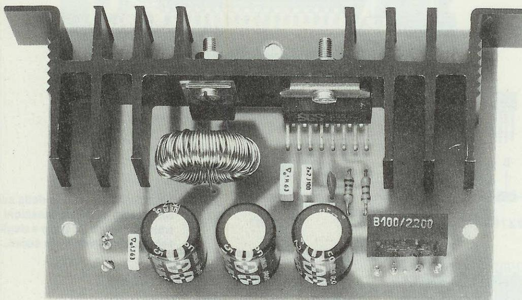
**Fig.8** Foto dello stadio di alimentazione. Se già sapete che non userete mai tale frequenzimetro in auto o in barca, sarà per voi assai meno costoso ed anche più semplice auto-costruirvi un alimentatore stabilizzato con un integrato uA.7805, che potrete racchiudere in un contenitore separato.
