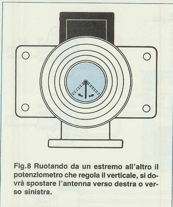
**Fig.8** Ruotando da un estremo all'altro il potenziometro che regola il verticale, si dovrà spostare l'antenna verso destra o verso sinistra.
