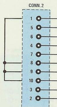
Fig.26 Se il ricevitore ha dei valori di MF anomali, dovrete inserire la scheda LX.942 e collegare sul **CONN1** i piedini 8-9-10 al positivo dei 5 volt (piedino 1). Il deviatore S2 rimarrà sempre collegato come illustrato in fig.21 per commutare i due ingressi BF/AF - VHF.
