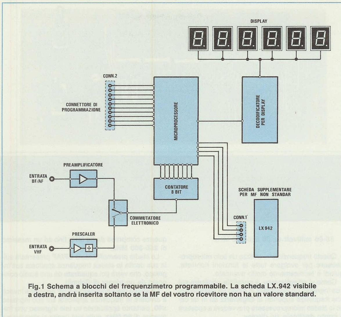
Fig.1 Schema a blocchi del frequenzimetro programmabile. La scheda LX.942 visibile a destra, andrà inserita soltanto se la MF del vostro ricevitore non ha un valore standard.
