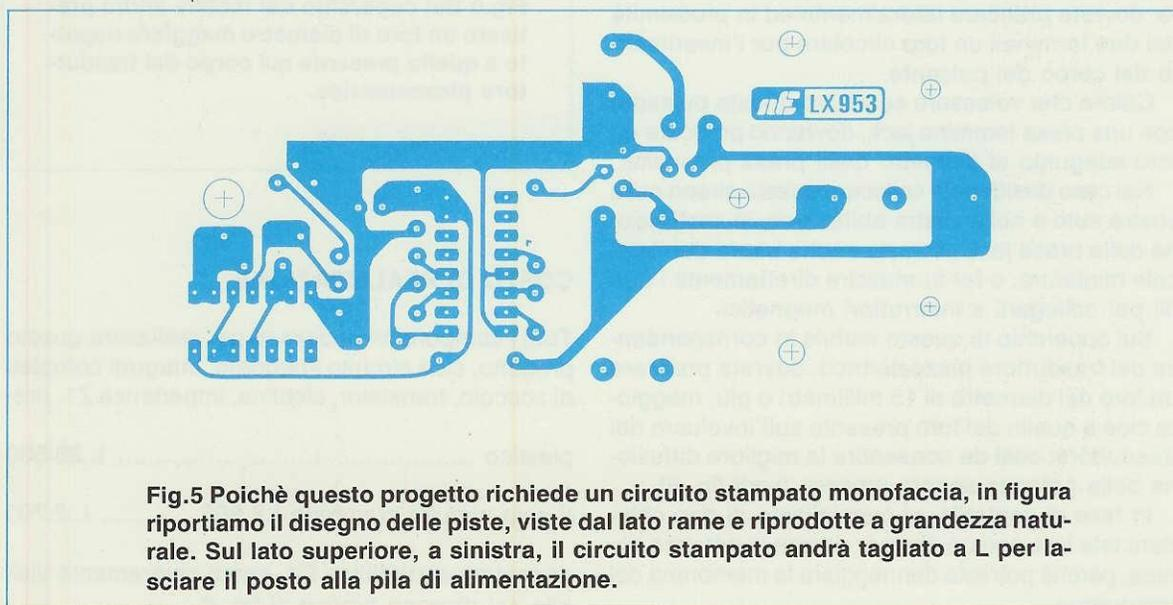
**Fig.5** Poichè questo progetto richiede un circuito stampato monofaccia, in figura riportiamo il disegno delle piste, viste dal lato rame e riprodotte a grandezza naturale. Sul lato superiore, a sinistra, il circuito stampato andrà tagliato a L per lasciare il posto alla pila di alimentazione.
