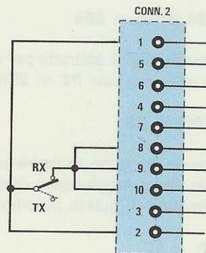
**Fig.28** Per leggere sia la frequenza del ricevitore che quella del trasmettitore con inserita la scheda LX.942, sarà sufficiente utilizzare un deviatore che fornisca o tolga la tensione sui piedini 8-9-10. In questo esempio, cioè con il piedino 2 collegato al positivo, il segnale entra nell'ingresso VHF (vedi fig.22).
