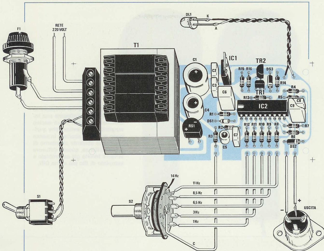
Fig.7 Schema pratico di montaggio. I due fili che provengono dal cordone di alimentazione dei 220 volt vanno collegati ai primi due fori della morsettiara.
