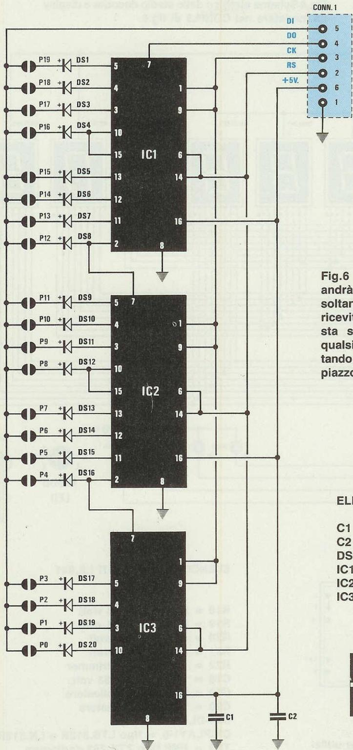
Fig.6 Questo stadio siglato LX.492 andrà inserito nel frequenzimetro soltanto se il valore di MF del vostro ricevitore non è standard. Con questa scheda potrete programmare qualsiasi valore di MF, cortocircuitando, come spiegato nell'articolo, le piazzole siglate da P19 a P0.
