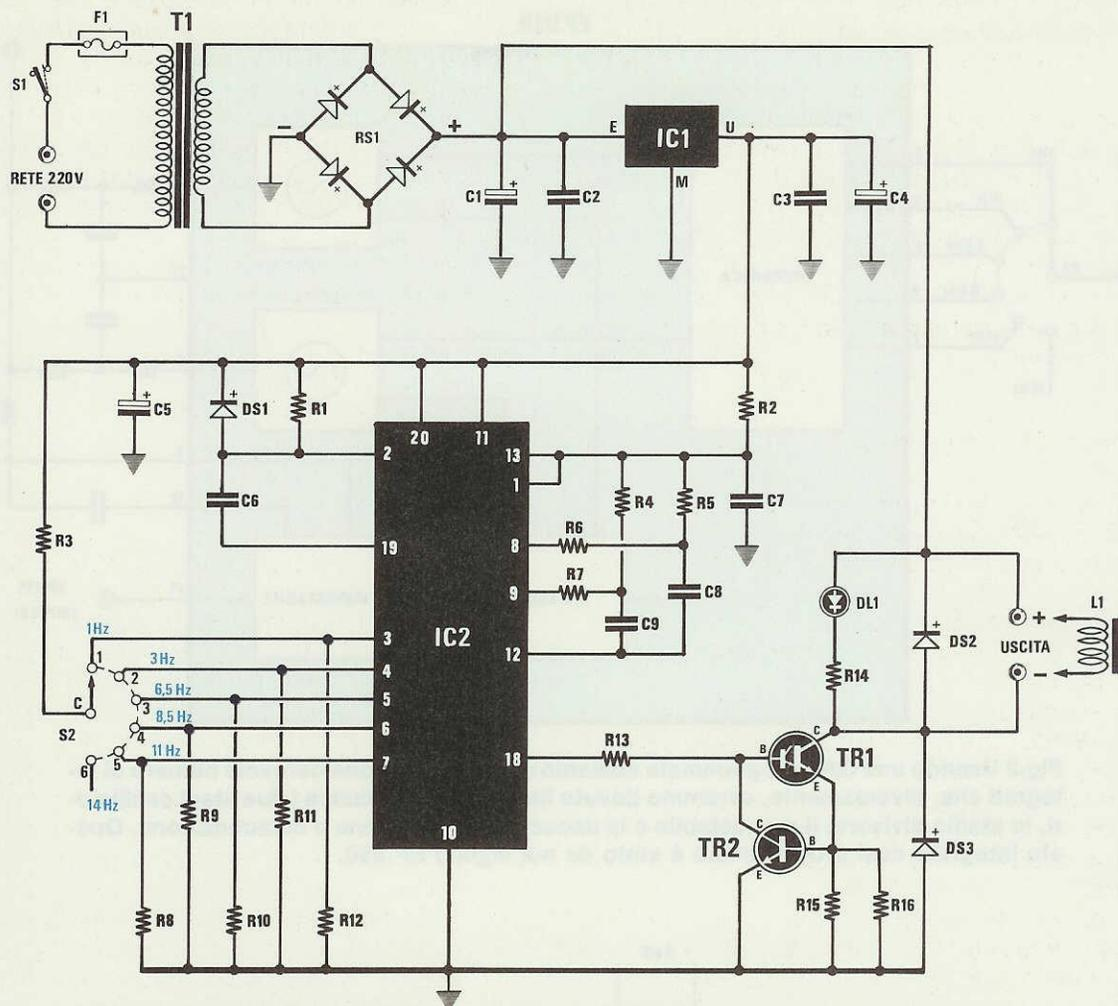
Fig.1 Schema elettrico della elettromagnetoterapia a Bassa Frequenza.
