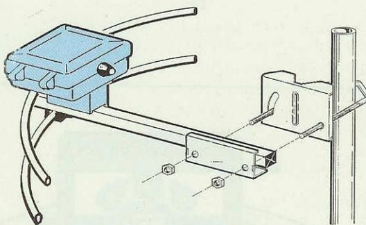
**Fig.9** L'asta collegata alla scatola di derivazione, una volta infilata nella squadretta, verrà bloccata tramite la forcella a U con i due dadi. Controllate che le due antenne risultino perfettamente parallele e centrate sul palo.
