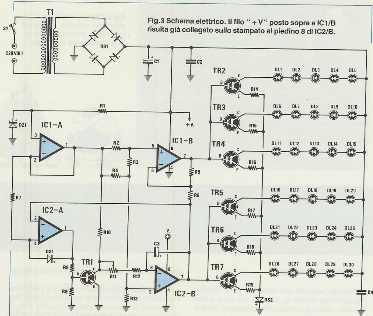
Fig.3 Schema elettrico. Il filo "+ V" posto sopra a IC1/B risulta già collegato sullo stampato al piedino 8 di IC2/B.
