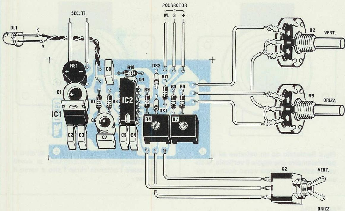
**Fig.6** Schema pratico di montaggio. Nel disegno non abbiamo raffigurato il trasformatore di alimentazione e l'interruttore di rete S1. Per tarare i due trimmer, se non avete ancora fissato il polarotor sulla parabola, potrete togliere il coperchio anteriore in plastica, ruotare a metà corsa i due potenziometri e poi i due trimmer per portare la piccola antenna in posizione verticale o orizzontale (vedi figg. 8-9).
