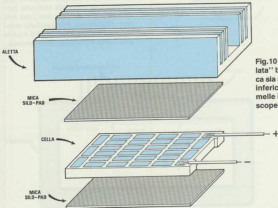
Fig. 10 In una cella "non isolata" bisogna porre una mica sia sul lato superiore che inferiore per isolare le lamelle in rame che risultano scoperte.
