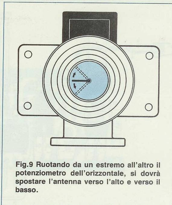
**Fig.9** Ruotando da un estremo all'altro il potenziometro dell'orizzontale, si dovrà spostare l'antenna verso l'alto e verso il basso.
