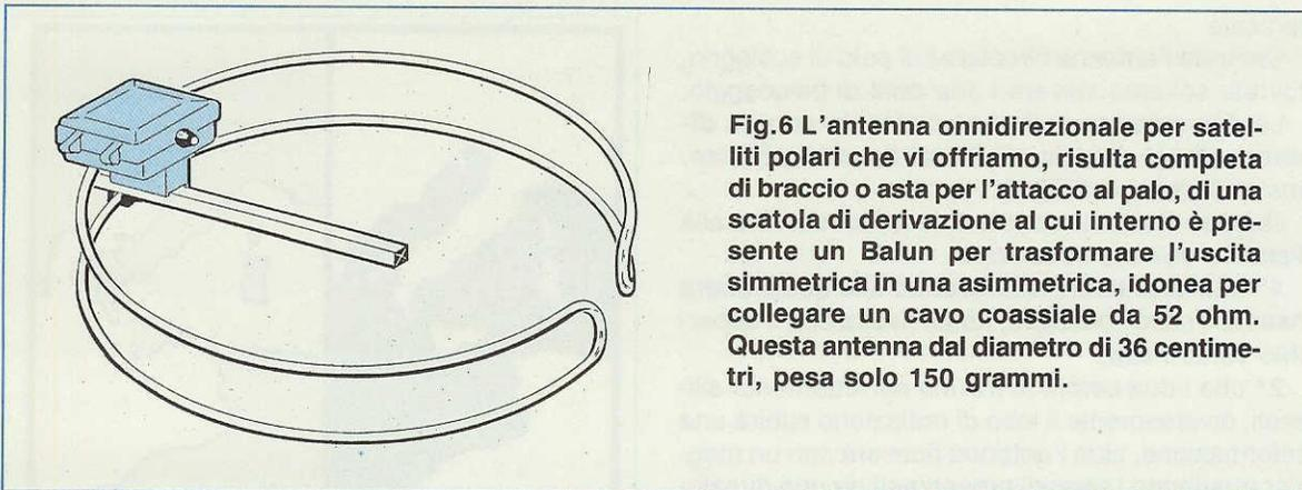
Fig. 6 L'antenna onnidirezionale per satelliti polari che vi offriamo, risulta completa di braccio o asta per l'attacco al palo, di una scatola di derivazione al cui interno è presente un Balun per trasformare l'uscita simmetrica in una asimmetrica, idonea per collegare un cavo coassiale da 52 ohm. Questa antenna dal diametro di 36 centimetri, pesa solo 150 grammi.
