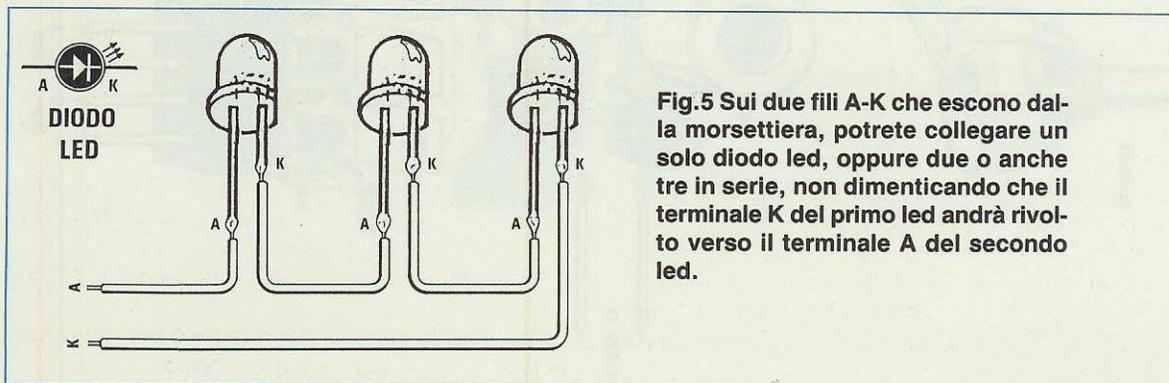
Fig.5 Sui due fili A-K che escono dalla morsettiera, potrete collegare un solo diodo led, oppure due o anche tre in serie, non dimenticando che il terminale K del primo led andrà rivolto verso il terminale A del secondo led.
