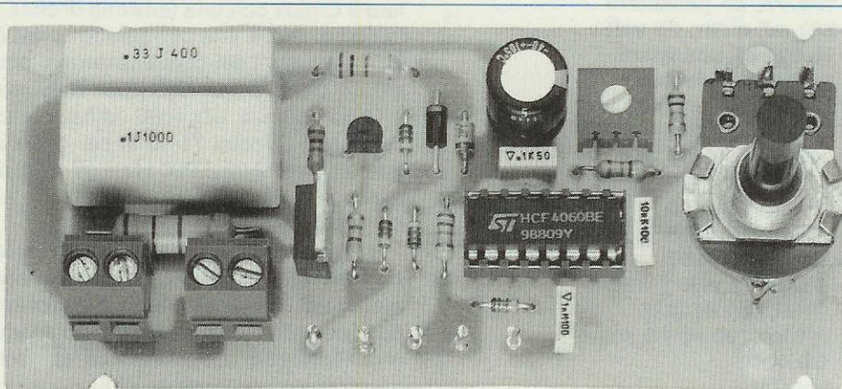
**Fig.2** Foto del progetto come si presenta a montaggio ultimato. Si noti il potenziometro R3 fissato sopra al circuito stampato. Non toccate il circuito stampato con la spina di rete inserita nella presa dei 220 volt.
