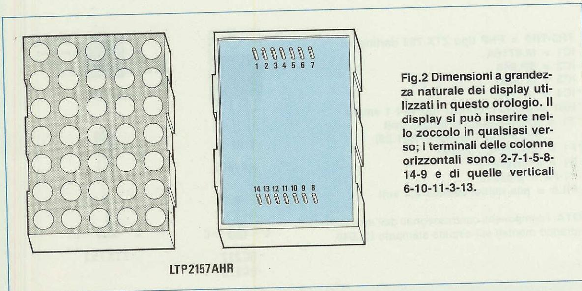
**Fig.2** Dimensioni a grandezza naturale dei display utilizzati in questo orologio. Il display si può inserire nello zoccolo in qualsiasi verso; i terminali delle colonne orizzontali sono 2-7-1-5-8-14-9 e di quelle verticali 6-10-11-3-13.
