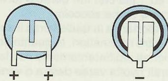
Fig.15 La pila al nichel-cadmio da 2,4 volt presenta due terminali dal lato "positivo" ed un solo terminale dal lato "negativo".
