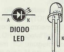
Fig.16 Per non invertire sullo stampato i due terminali dei diodi led, ricordatevi che quello "più lungo" è sempre l'ANODO.
