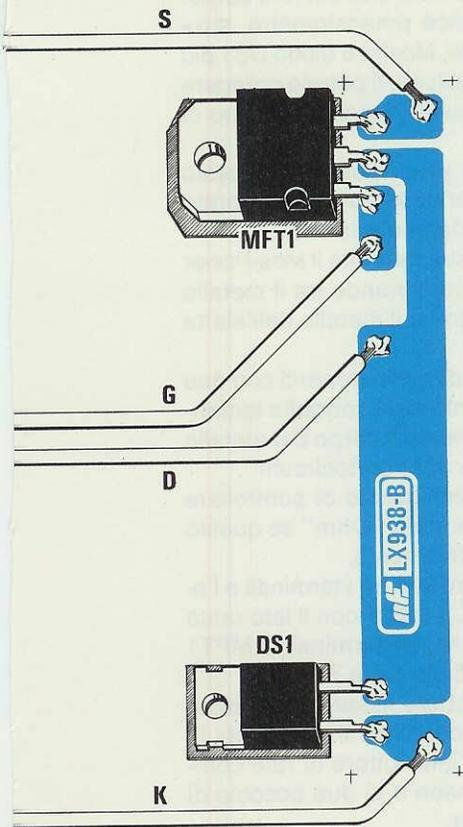
Fig.6 Il piccolo circuito stampato LX.938/B verrà utilizzato come punto di appoggio per i terminali del Mos-Power, per il diodo DS1 e per i fili di collegamento (vedi foto in basso). Ricordatevi che il corpo metallico del Mos-Power e del diodo DS1 dovranno risultare "isolati" dal metallo dell'aletta, tramite due miche e rondelle isolanti da inserire nelle viti di fissaggio.
