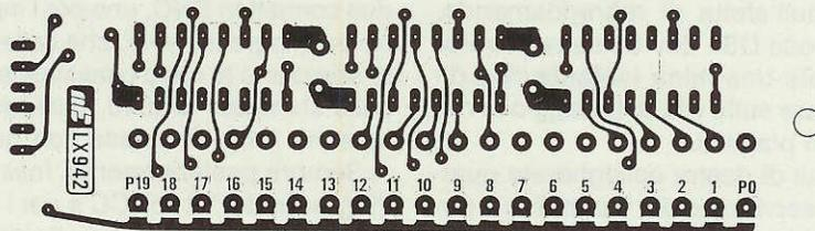
Fig.13 In alto, il disegno pratico della scheda LX.942 visto da entrambi i lati, ed in basso la foto dello stampato. Si notino le piazzole siglate da P19 a P0 necessarie per programmare qualsiasi valore di MF.
