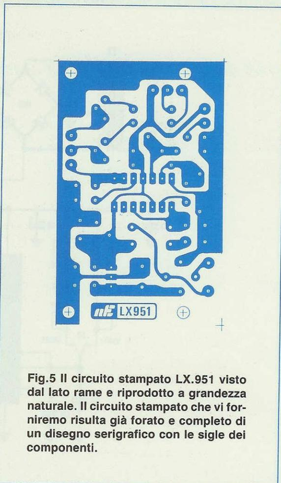
**Fig.5 Il circuito stampato LX.951 visto dal lato rame e riprodotto a grandezza naturale. Il circuito stampato che vi forniremo risulta già forato e completo di un disegno serigrafico con le sigle dei componenti.**
