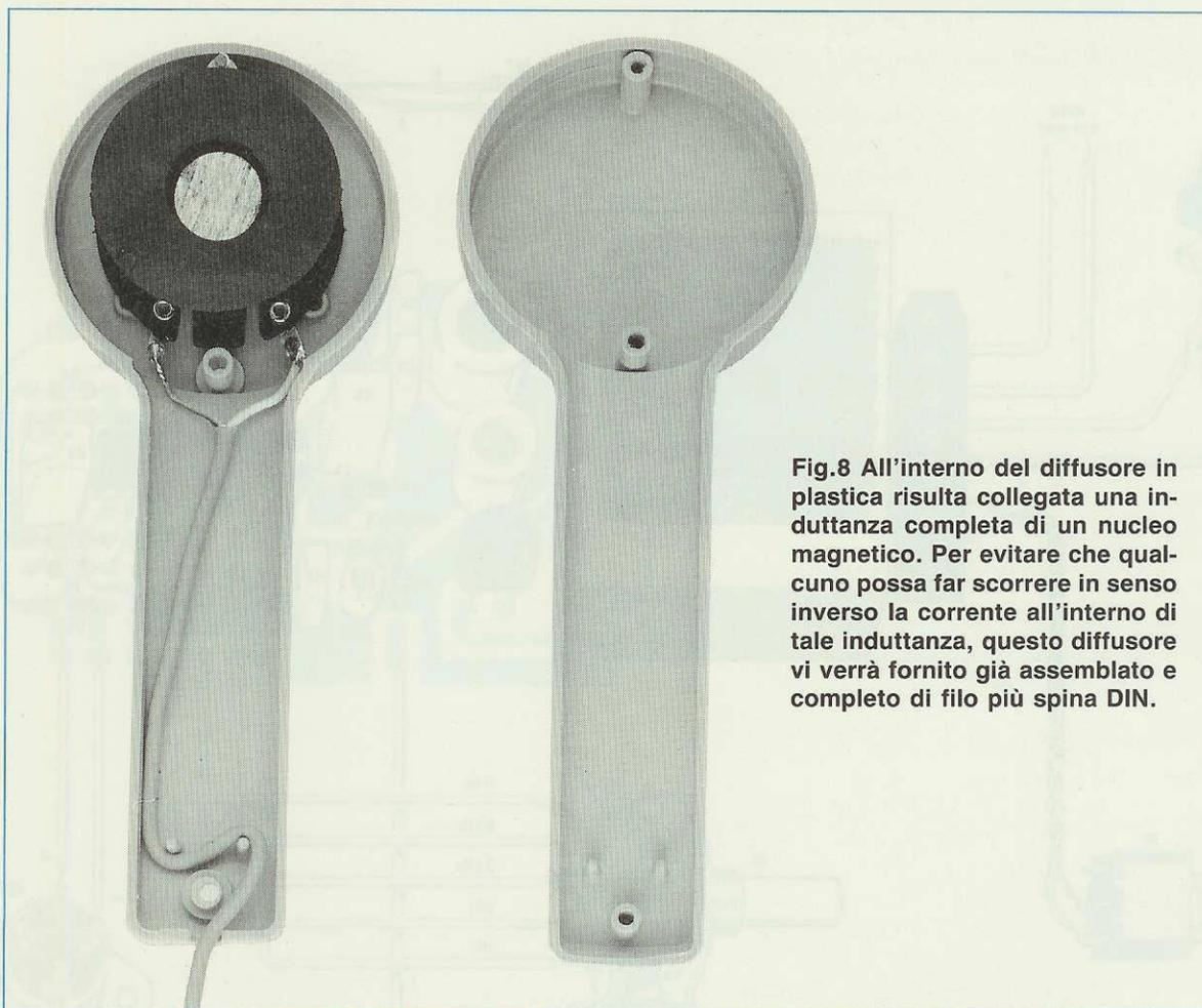
**Fig.8** All'interno del diffusore in plastica risulta collegata una induttanza completa di un nucleo magnetico. Per evitare che qualcuno possa far scorrere in senso inverso la corrente all'interno di tale induttanza, questo diffusore vi verrà fornito già assemblato e completo di filo spina DIN.
