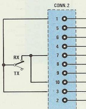
Fig.24 Volendo usare questo stesso frequenzimetro per leggere la frequenza di Ricezione e quella di Trasmissione, dovrete utilizzare un deviatore supplementare. Nell'esempio, come si collega il frequenzimetro per la lettura VHF e per "addizionare" in ricezione 455 KHz (vedi piedini 7 - 10).
