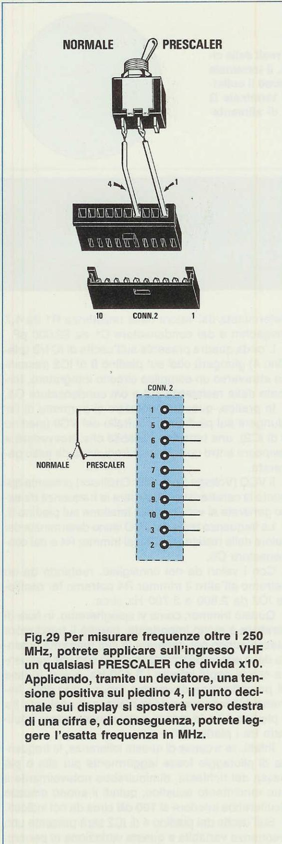
**Fig.29** Per misurare frequenze oltre i 250 MHz, potrete applicare sull'ingresso VHF un qualsiasi PRESCALER che divida x10. Applicando, tramite un deviatore, una tensione positiva sul piedino 4, il punto decimale sui display si sposterà verso destra di una cifra e, di conseguenza, potrete leggere l'esatta frequenza in MHz.
