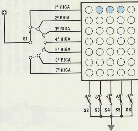
Fig.4 Per accendere dei led disposti sulla prima fila, sarà sufficiente applicare una tensione positiva sul "terminale 2" e collegare a massa uno dei sette terminali 6-10-11-3-13 presenti in basso. Per effettuare delle prove con una pila da 9 volt, COLLEGATE IN SERIE al positivo una resistenza da 390 ohm per non bruciare i led.
