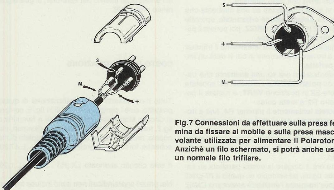
**Fig.7** Connessioni da effettuare sulla presa femmina da fissare al mobile e sulla presa maschio volante utilizzata per alimentare il Polarotor. Anzichè un filo schermato, si potrà anche usare un normale filo trifilare.
