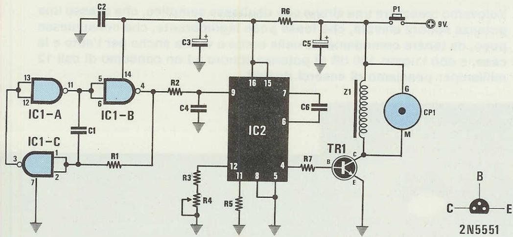
Fig.3 Schema elettrico della sirena e connessioni del transistor 2N5551 visto da sotto.
