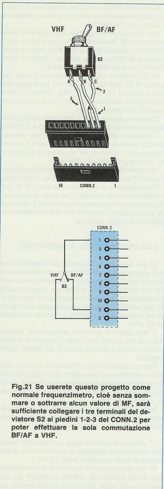
Fig.21 Se userete questo progetto come normale frequenzimetro, cioè senza sommare o sottrarre alcun valore di MF, sarà sufficiente collegare i tre terminali del deviatore S2 ai piedini 1-2-3 del CONN.2 per poter effettuare la sola commutazione BF/AF a VHF.
