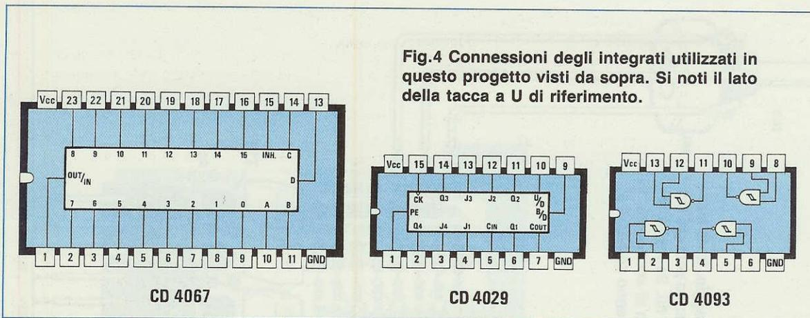
Fig.4 Connessioni degli integrati utilizzati in questo progetto visti da sopra. Si noti il lato della tacca a U di riferimento.
