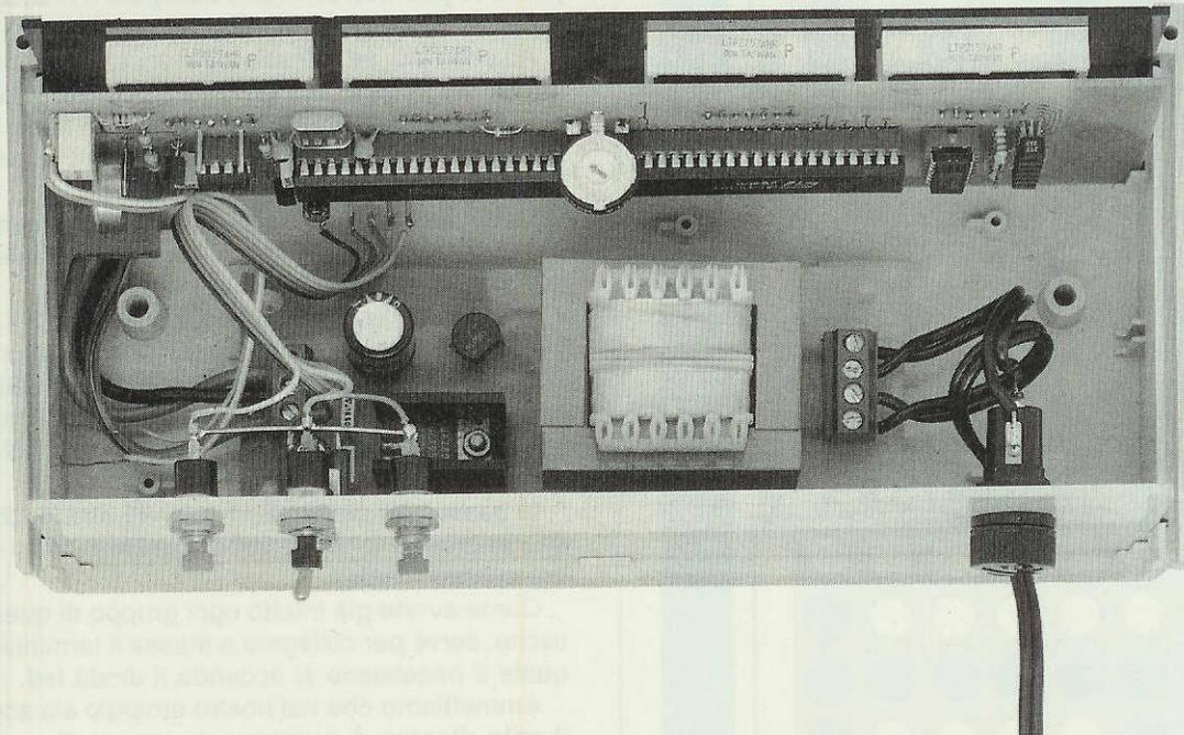
**Fig.10** All'interno del mobile plastico sono presenti delle guide, utili per inserire il pannello frontale in plexiglas rosso e dietro a questo, sempre in verticale, il circuito stampato dell'orologio. Sul piano del mobile fisserete lo stampato dell'alimentatore, utilizzando i quattro distanziatori con base autoadesiva. Sul pannello posteriore del mobile fisserete il portafusibile, i tre pulsanti e l'interruttore S1.
