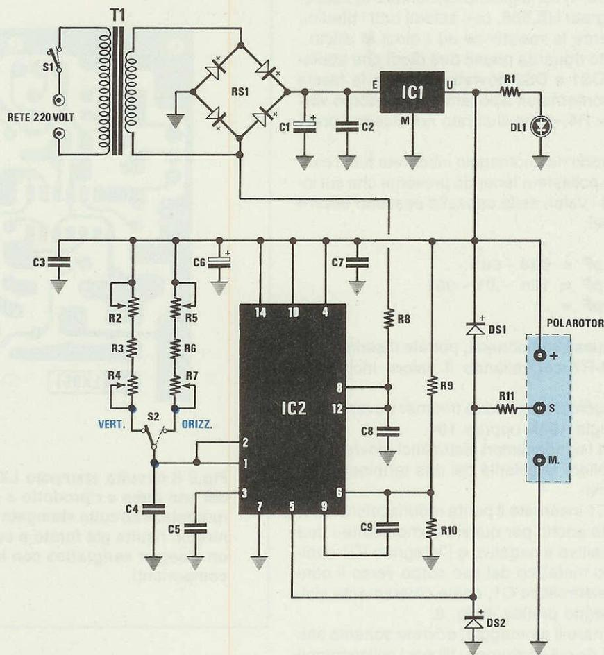
Fig.4 Schema elettrico del Controllo manuale per Polarotor. Il rettangolo in colore visibile a destra rappresenta i terminali d'uscita da collegare al Polarotor.
