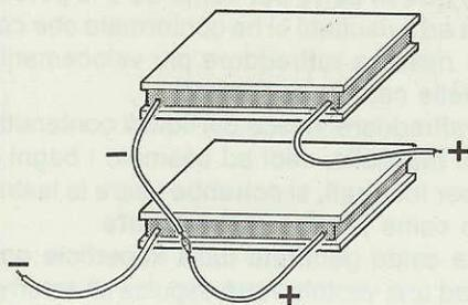
**Fig.16** Per scendere molto sotto allo "zero" conviene collocare le due celle una sopra all'altra. Questo sistema risulta particolarmente valido se si ha la necessità di congelare molto velocemente l'interno di camere frigorifere.
