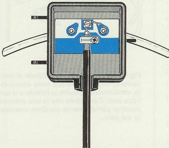
**Fig.11** All'interno della scatola di derivazione, il filo centrale del cavo coassiale andrà fissato nel piccolo morsetto e la calza metallica dello schermo serrata sotto la fascetta centrale. Sull'ingresso del Preamplificatore d'antenna sono presenti due identici morsetti, per fissare i due cavi coassiali che provengono dalle due antenne.
