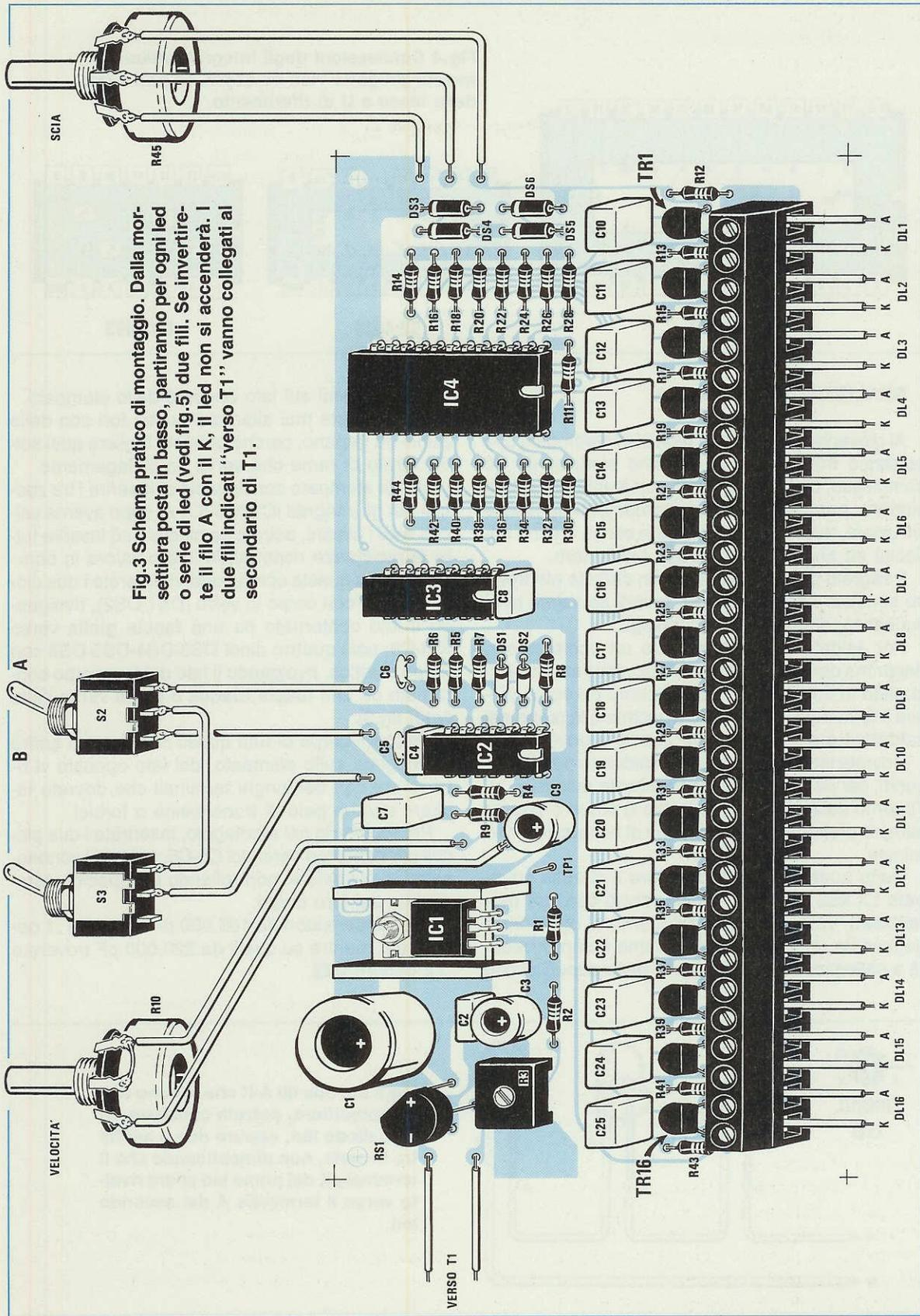
Fig.3 Schema pratico di montaggio. Dalla morsettera posta in basso, partiranno per ogni led serie di led (vedi fig.5) due fili. Se invertirete il filo A con il K, il led non si accenderà. I due fili indicati "verso T1" vanno collegati al secondario di T1.
