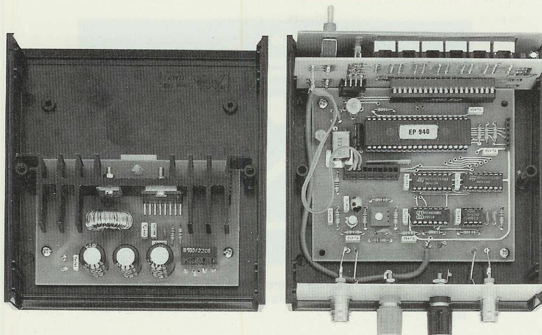
**Fig.17** Nel semicoperchio inferiore del mobile plastico viene fissato il circuito base del frequenzimetro più lo stadio display, mentre nel semicoperchio superiore l'alimentatore switching. Chi non ha problemi di spazio potrebbe inserire tutto lo stadio di alimentazione, più il trasformatore dei 220 volt, entro un contenitore separato.
