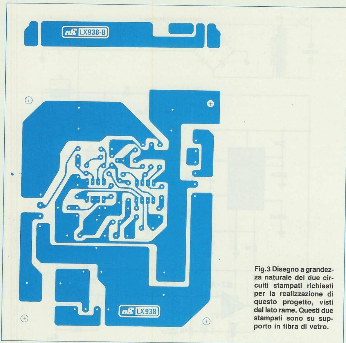
**Fig.3** Disegno a grandezza naturale dei due circuiti stampati richiesti per la realizzazione di questo progetto, visti dal lato rame. Questi due stampati sono su supporto in fibra di vetro.
