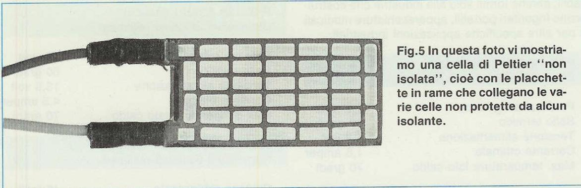
Fig.5 In questa foto vi mostriamo una cella di Peltier "non isolata", cioè con le placchette in rame che collegano le varie celle non protette da alcun isolante.
