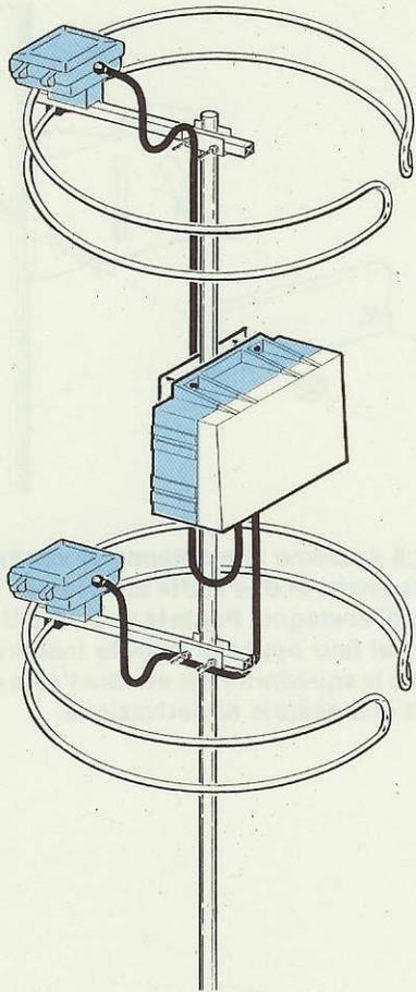
**Fig.10** Le due antenne andranno collegate alla scatola di derivazione con due spezzoni di cavo coassiale, di lunghezza prestabilita. Per l'antenna superiore si dovrà usare uno spezzone lungo esattamente 72 cm. e per quella inferiore uno spezzone di 36 cm., in modo che sul preamplificatore i due segnali giungano in fase.
