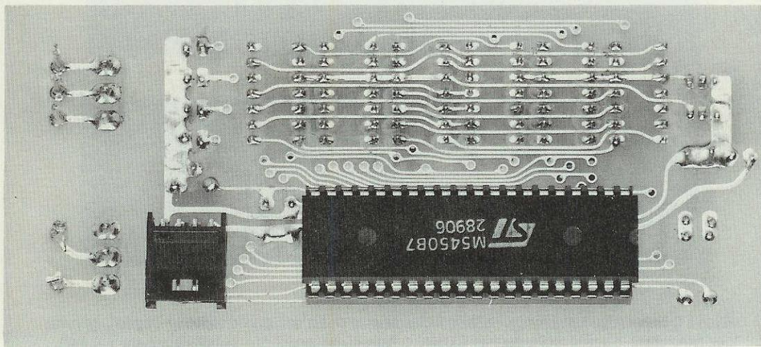
**Fig.12** Foto dello stampato LX.941 visto dal lato dell'integrato. Tutte le piste del circuito stampato sono protette da solded-resist, che lascia libere le sole piazzole da saldare.
