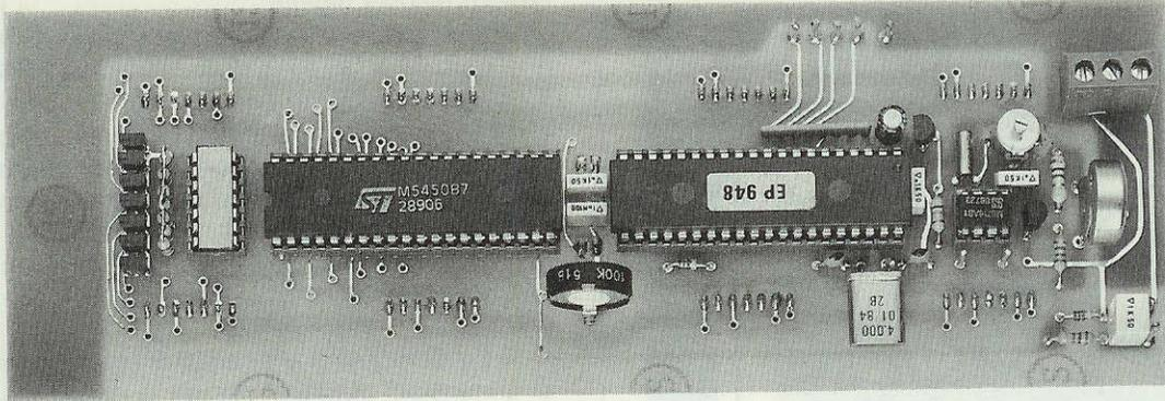
**Fig.9** Foto dello stampato LX.948 visto dal lato degli integrati. Dal lato opposto, come abbiamo già evidenziato in fig.8, andranno innestati i quattro display giganti. Tutte le piste dello stampato che vi forniremo sono protette da una speciale vernice che lascia liberi i soli reofori da saldare.
