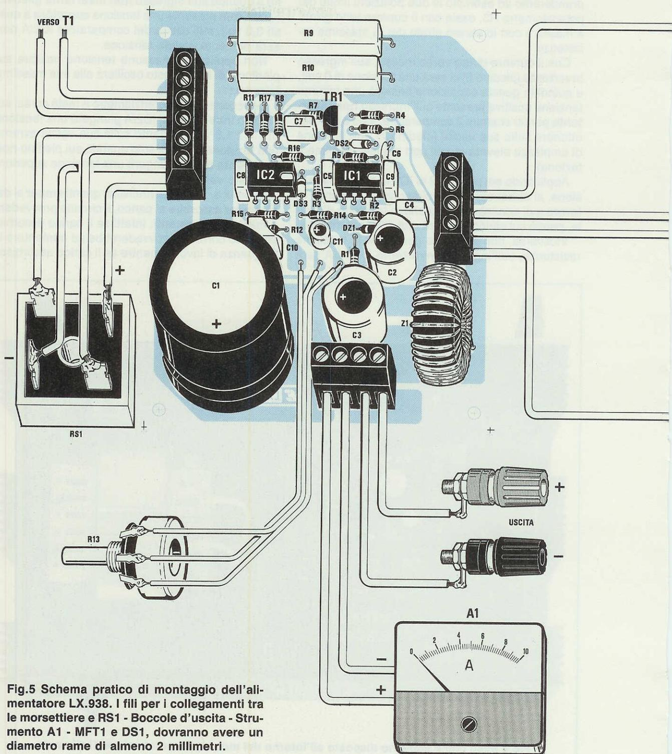
Fig.5 Schema pratico di montaggio dell'alimentatore LX.938. I fili per i collegamenti tra le morsettiere e RS1 - Boccole d'uscita - Strumento A1 - MFT1 e DS1, dovranno avere un diametro rame di almeno 2 millimetri.
