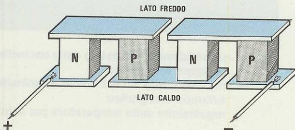
Fig.2 Una sola cella non riesce mai ad erogare una elevata potenza refrigerante, perciò per aumentare quest'ultima si devono collegare più celle in serie.
