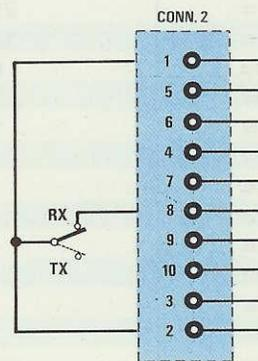
Fig.25 Se il vostro ricevitore disponesse di una MF a 10,7 MHz, dovrete fornire in Ricezione una tensione positiva al piedino 8 per "sottrarre" 10,7 MHz e lasciare collegato al positivo il piedino 2 se la frequenza da leggere fosse maggiore di 40 MHz, o al piedino 3, se fosse minore di 40 MHz.
