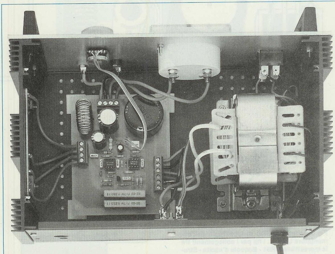
**Fig.4** Ecco come abbiamo disposto all'interno del mobile, il trasformatore di alimentazione e la scheda base LX.938. Come si può intravedere, sul pannello frontale andranno fissati l'interruttore di rete completo di lampada spia, lo strumento, il potenziometro e le due bocche d'uscita. Sull'aletta di sinistra risultano fissati il Mos-Power ed il diodo DS1, mentre sul pannello posteriore, il ponte raddrizzatore RS1 ed il portafusibile.
