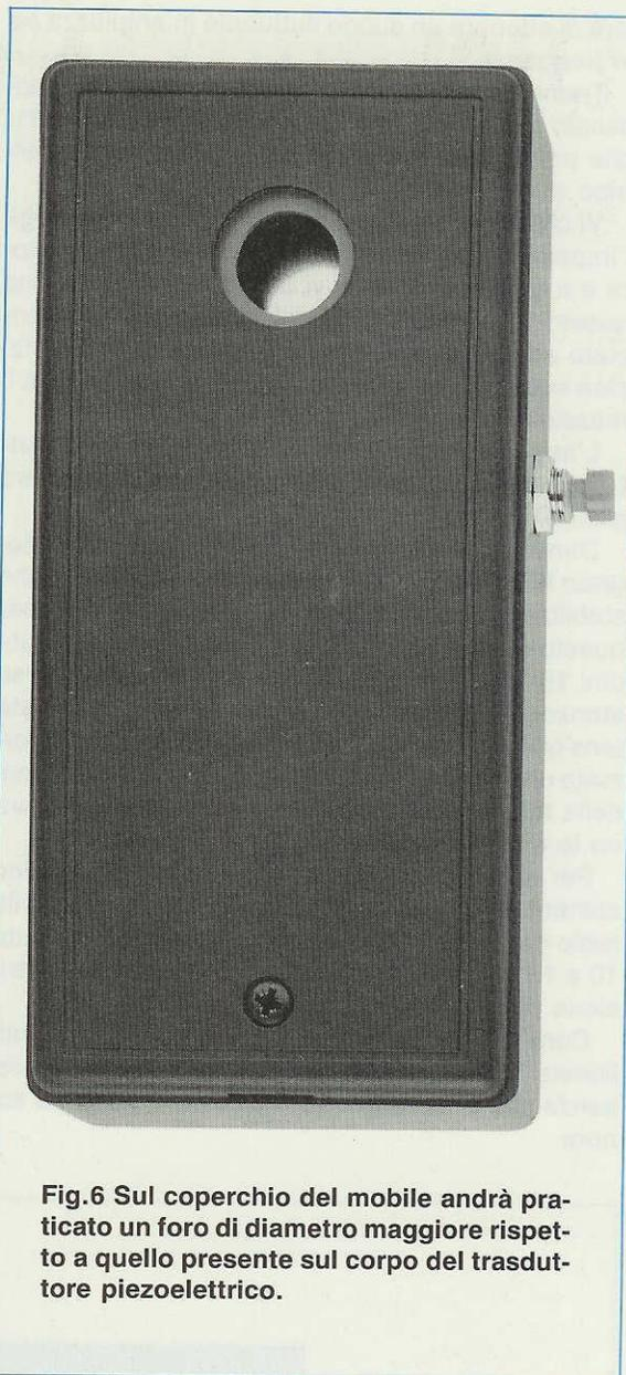
**Fig.6 Sul coperchio del mobile andrà praticato un foro di diametro maggiore rispetto a quello presente sul corpo del trasduttore piezoelettrico.**
