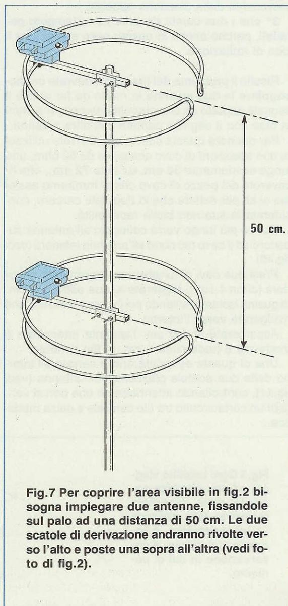
Fig. 7 Per coprire l'area visibile in fig.2 bisogna impiegare due antenne, fissandole sul palo ad una distanza di 50 cm. Le due scatole di derivazione andranno rivolte verso l'alto e poste una sopra all'altra (vedi foto di fig.2).
