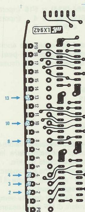
**Fig.27** Programmare un qualsiasi valore di MF utilizzando la tabella riportata nella pagina di sinistra, non è difficile (vedi esempi nell'articolo). Avendo in questa scheda cortocircuitato P13-P10-P8-P4-P3-P2, abbiamo programmato un valore di MF pari a 9.500 KHz.
