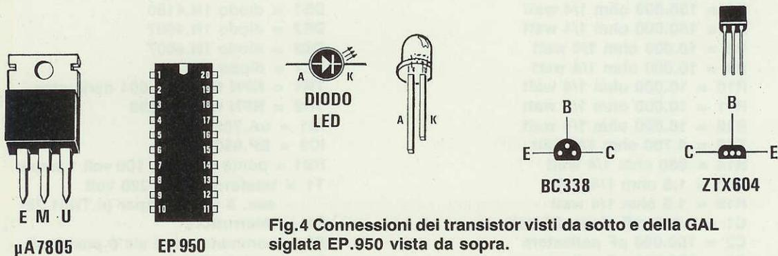
Fig.4 Connessioni dei transistor visti da sotto e della GAL siglata EP.950 vista da sopra.
