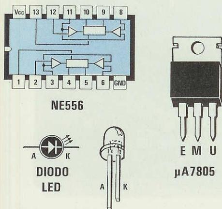
Fig.3 Connessioni dei semiconduttori utilizzati in questo progetto. L'integrato NE.556 è visto da sopra.
