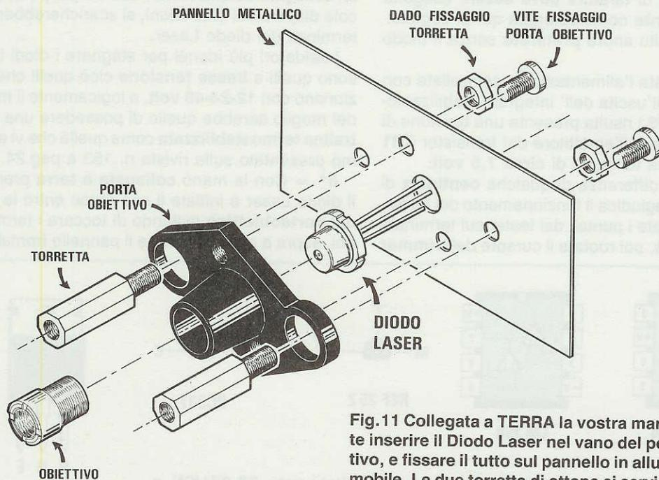
Fig.11 Collegata a TERRA la vostra mano, potrete inserire il Diodo Laser nel vano del portaobiettivo, e fissare il tutto sul pannello in alluminio del mobile. Le due torrette di ottone ci serviranno per fissare il "Tester Ottico".
