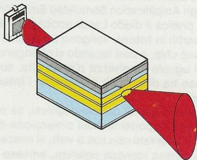
Fig.2 La struttura interna di un diodo Laser è molto complessa. Come possiamo vedere nel disegno, dal suo chip fuoriesce da due lati un fascio luminoso. Quello frontale fuoriescirà dalla finestra del diodo, quello posteriore andrà a colpire un "fotodiodo" fissato nell'interno del suo corpo.
