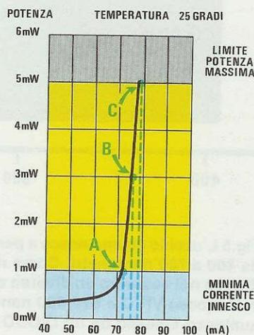
Fig. 8 Poichè la curva di pendenza di un Diodo Laser è molto ripida basta una differenza di pochi milliamper per spegnere il diodo o per bruciarlo. Ad una temperatura di 25 gradi, una corrente di 72 mA (punto A) farà erogare al diodo 1 milliwatt, e con 75 mA farà erogare già 3 milliwatt (punto B) mentre con 78 mA (punto C) avremo già raggiunto il massimo di 5 milliwatt.
