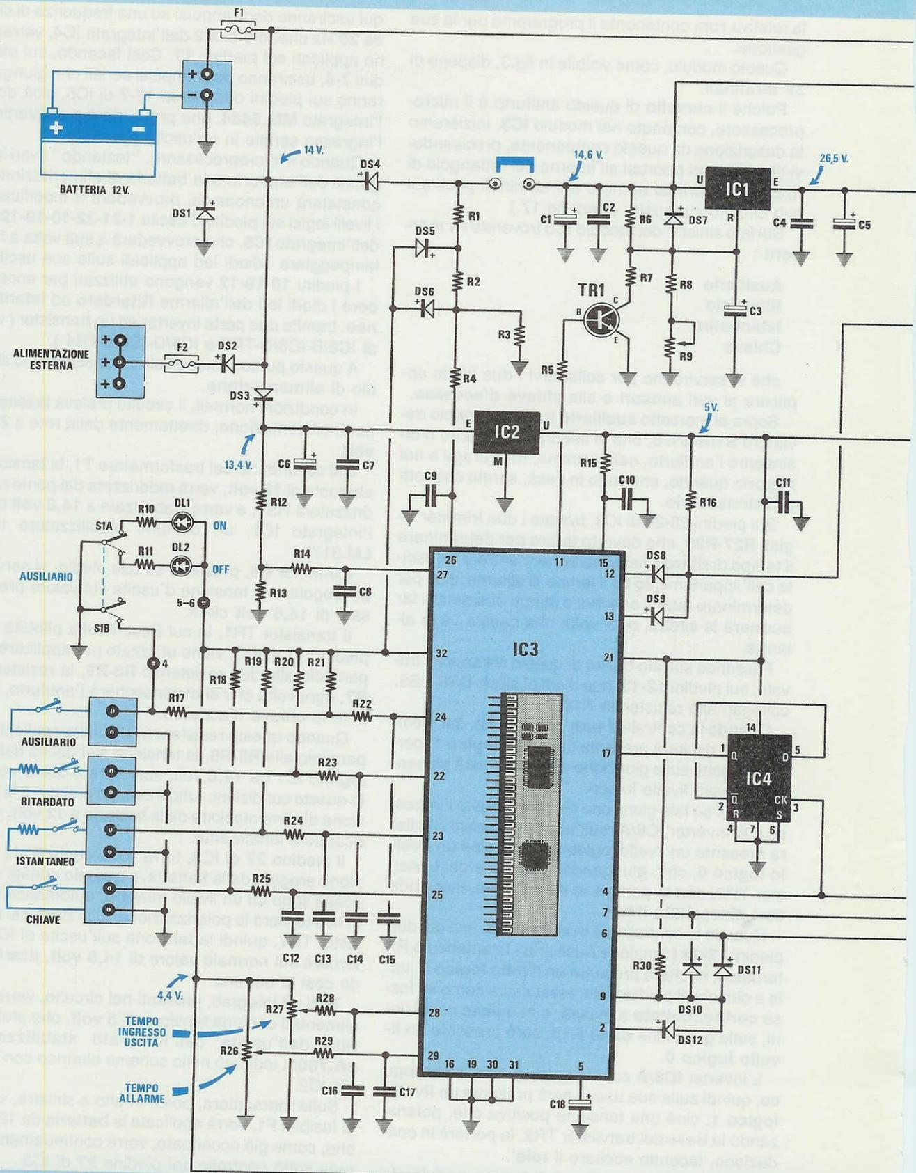
Sulla seconda morsettiere a 3 poli, contraddistinta dalla scritta **Alimentazione esterna**, potrete prelevare la tensione positiva di 12 volt, per alimentare dei **sensori all'infrarosso** o delle chiavi elettroniche.
