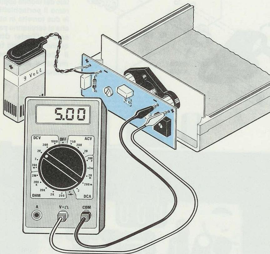
Fig.17 Dopo aver applicato sulle due torrette in ottone il "Tester Ottico" presentato su questo numero, dovrete alimentarlo, applicando su due terminali di destra un tester possibilmente digitale. A questo punto dovrete lentamente ruotare il cursore del trimmer R19 fino a leggere un massimo di 5 volt. Vi facciamo presente che se aumenterete la luminosità fino a leggere sul tester una tensione a 5,6 volt, dopo pochi secondi il Diode Laser si distruggerà.
