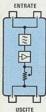
**Fig.428** Nei moduli dei Filtri di Canale le due boccole d'INGRESSO poste sopra sono in "parallelo" come lo sono le due boccole d'USCITA poste sotto. Il trimmer presente in questi Filtri serve solo per "attenuare" un segnale e non per amplificarlo.
