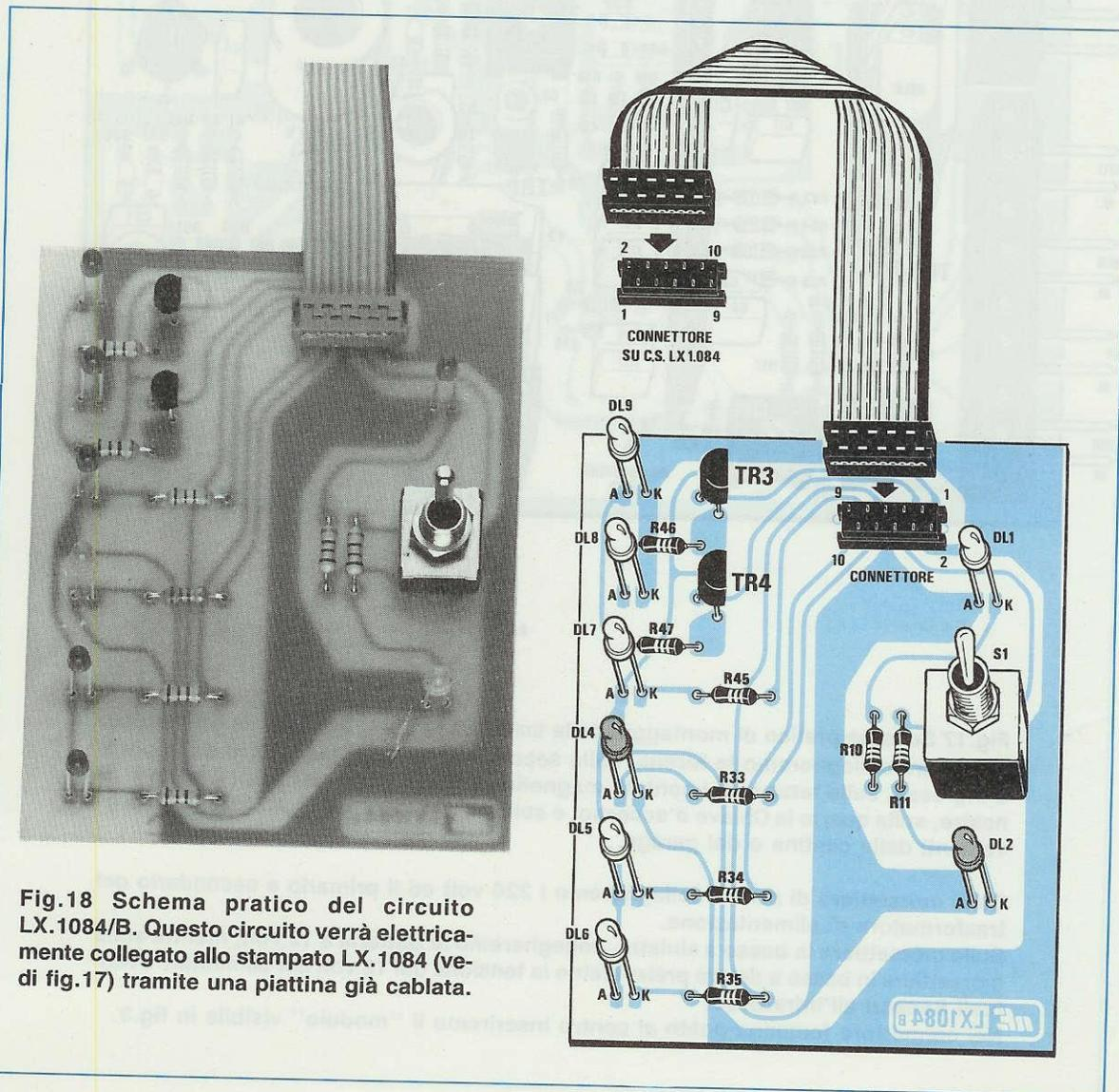
Fig.18 Schema pratico del circuito LX.1084/B. Questo circuito verrà elettricamente collegato allo stampato LX.1084 (vedi fig.17) tramite una piattina già cablata.
