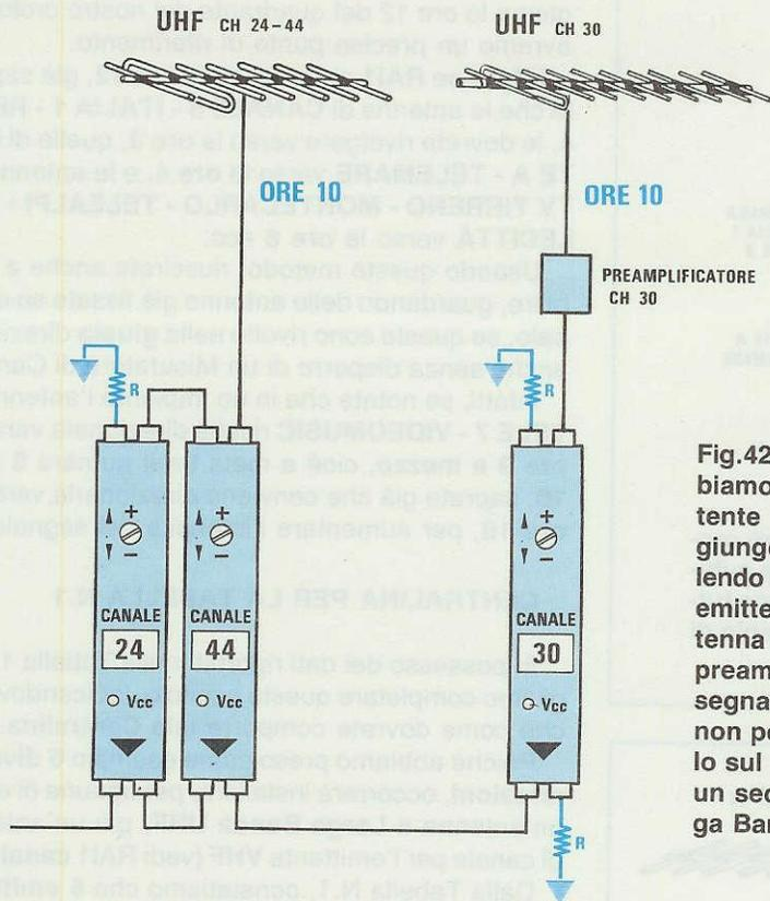
Fig.422 Nella Centralina di fig.421 abbiamo volutamente escluso l'emittente "TV K8" Canale 30 perchè giunge con soli 39 dBmicrovolt. Volendo assolutamente ricevere questa emittente, dovremo utilizzare un'antenna per questo solo Canale, più un preamplificatore da palo. Poichè il segnale risulterà ancora "debole" non potremo direttamente collegarlo sul Filtro del Canale 30, ma su di un secondo Preamplificatore a Larga Banda (vedi fig.423).
