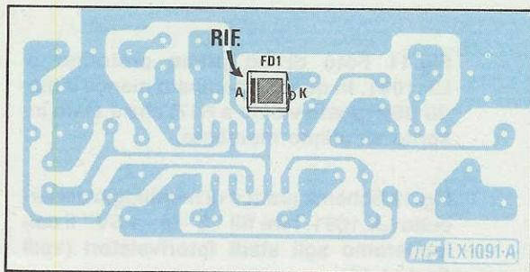
Fig.14 Schema pratico di montaggio del fotorivelatore LX.1091/A. Il fotodiode BPW.34 andrà montato dal lato opposto di questo stampato (vedi disegno in alto) rivolgendo la piccola "I" di riferimento verso sinistra.
