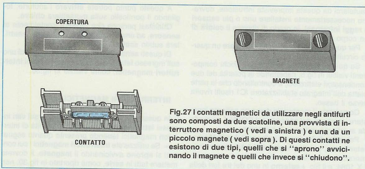
Fig.27 I contatti magnetici da utilizzare negli antifurti sono composti da due scatoline, una provvista di interruttore magnetico ( vedi a sinistra ) e una da un piccolo magnete ( vedi sopra ). Di questi contatti ne esistono di due tipi, quelli che si "aprono" avvicinando il magnete e quelli che invece si "chiudono".
