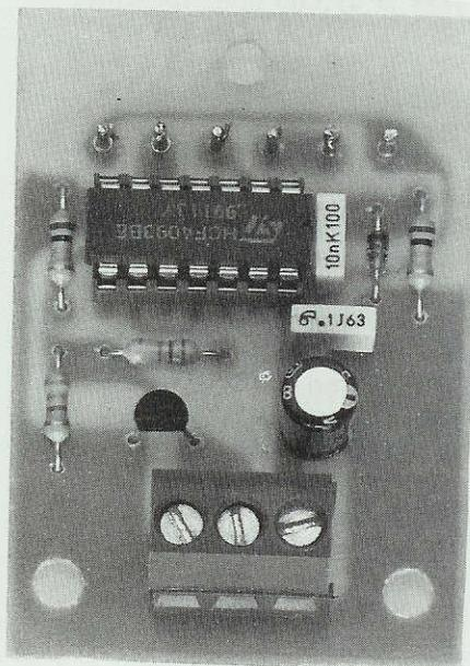
Fig. 14 Foto del circuito stampato LX.1085 relativo alla Chiave Codificata con sopra già montati tutti i componenti richiesti.
