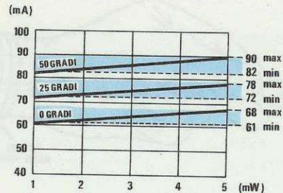
**Fig.9** In questo grafico abbiamo riportato quali correnti "massime" dovremo far as- sorbire al Diodo Laser per raggiungere la massima potenza di 5 milliwatt con tempe- rature di 0-25-50 gradi. Come si potrà no- tare, una corrente "minima" per 25 gradi, risulta già pericolosa per una temperatura di 0 gradi.
