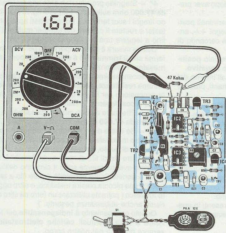
Fig.10 Prima di fissare il Diodo Laser sullo stampato dovrete "pretarare" i trimmer R8 e R6. Dopo aver pretarato il trimmer R8 (leggere articolo) dovrete stagnare una resistenza da 47.000 ohm sulle piste 1-2, poi ruotare il cursore del trimmer R6 fino a leggere sul tester una tensione di circa 1,6 volt.
