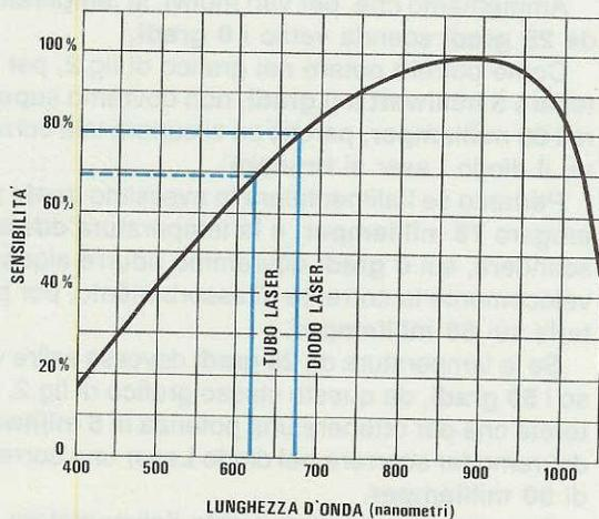
Fig.5 Il fotodiode BPW.34 usato nel nostro Tester Ottico risulta sensibile a tutte le radiazioni comprese tra 400-1.000 nanometri. Come visibile nel grafico di sinistra, questo fotodiode risulta maggiormente sensibile alla luce emessa da un Diodo Laser che a quella emessa da un Tubo Laser.
