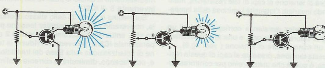
**Fig.4** Per regolare la corrente di assorbimento del Diodo Laser in modo da ottenere in uscita una potenza luminosa sui 5 milliwatt, utilizzeremo il transistor **TR3**. Se sul collettore mettessimo una comune lampadina a filamento, e polarizzassimo la Base di tale transistor con una tensione più o meno positiva, potremmo regolare la sua intensità luminosa.
