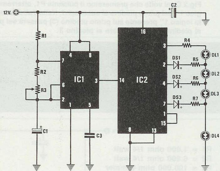
Fig.6 Schema che provvede a tener acceso i quattro diodi led con tempi decrescenti.
