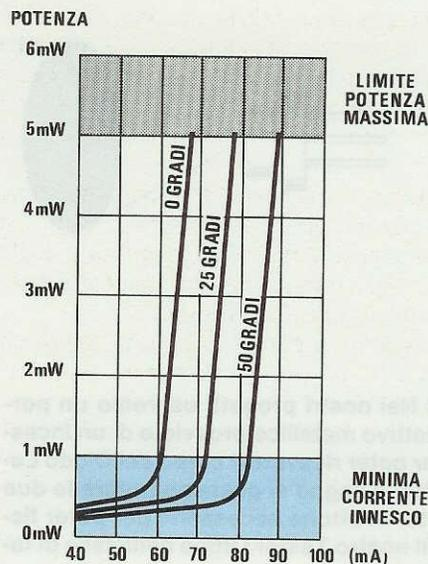
Fig.2 Guardando questi due grafici, scopriremo che non è possibile tarare un Diodo Laser regolando la sua corrente di assorbimento, perchè se la temperatura dovesse scendere o aumentare il Diodo potrebbe autodistruggersi o disinnescarsi. Per evitare questi rischi occorre tararlo controllando solo la sua potenza luminosa.
