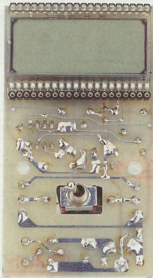
Fig.4 Foto del circuito LX.1087 visto dal lato del Display. Prima di inserire il Display sui due connettori femmina, controllate se la sua tacca di riferimento è posta a destra (vedi figg.5-6).
