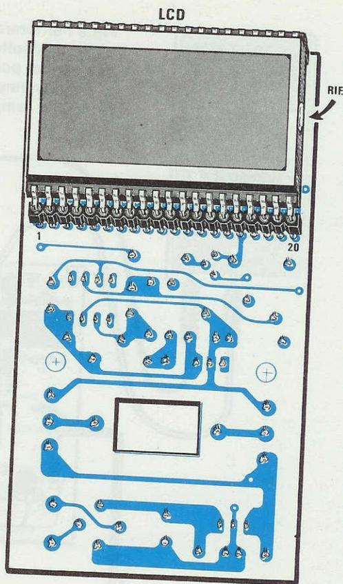
Fig.7 In basso, lo stampato LX.1087 visto dal lato dei componenti. Per collegare le due Sonde consigliamo di usare due spezzoni di cavo schermato bifilare, cercando ovviamente di non invertire i due fili interni.
