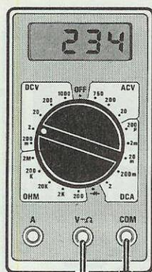
Fig.9 Per tarare questo termometro sarà sufficiente leggere quale tensione risulta presente tra il terminale MASSA e U di una delle due sonde, poi tarare il trimmer R9 fino a far apparire sui display lo stesso numero. Una tensione di 234 millivolt dovrà corrispondere ad una temperatura di 23,4 gradi.
