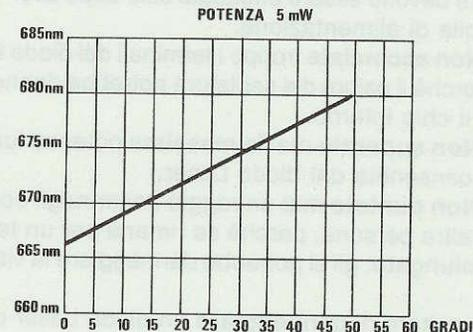
**Fig.10** Al variare della temperatura varia an- che la lunghezza d'onda di emissione. A 0 gradi il Laser emetterà una luce sui 665 na- nometri, a 15 gradi emetterà una luce sui 670 nanometri e a 50 gradi una luce sui 780 nanometri.
