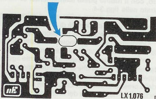
Fig.1 Prima di montare i componenti sul circuito stampato LX.1076, controllate se dal perimetro dell'asola, dove andrà inserito il Mosfet BF966, è stata asportata la sottilissima pista in rame visibile in figura. In caso contrario la dovrete asportare raschiandola con una lama.
