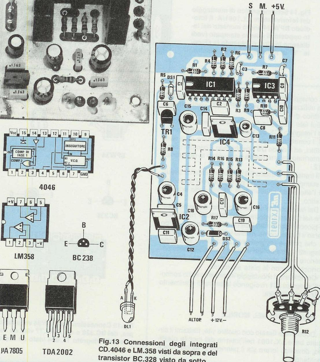
Fig.13 Connessioni degli integrati CD.4046 e LM.358 visti da sopra e del transistor BC.328 visto da sotto.
