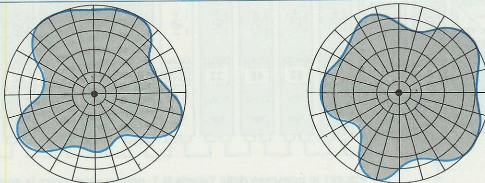
**Fig.419** Il diagramma di radiazione di una qualsiasi antenna trasmittente non è perfettamente circolare, quindi trovandovi in zone marginali, cioè molto lontane dall'emittente, non stupitevi se spostandovi di pochi chilometri il segnale subisce una notevole attenuazione.
