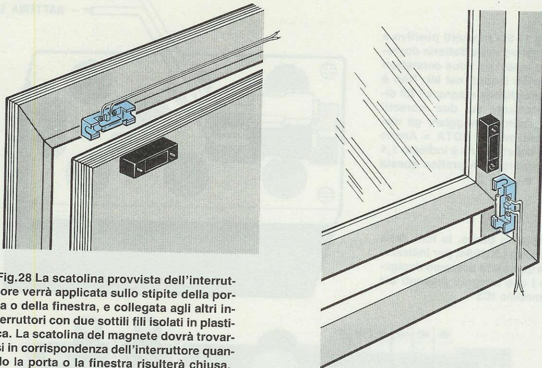
Fig.28 La scatola provvista dell'interruttore verrà applicata sullo stipite della porta o della finestra, e collegata agli altri interruttori con due sottili fili isolati in plastica. La scatola del magnete dovrà trovarsi in corrispondenza dell'interruttore quando la porta o la finestra risulterà chiusa.
