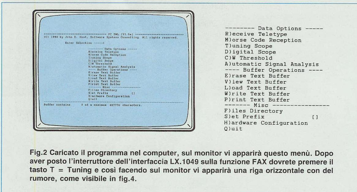
Fig.2 Caricato il programma nel computer, sul monitor vi apparirà questo menù. Dopo aver posto l'interruttore dell'interfaccia LX.1049 sulla funzione FAX dovreste premere il tasto T = Tuning e così facendo sul monitor vi apparirà una riga orizzontale con del rumore, come visibile in fig.4.
