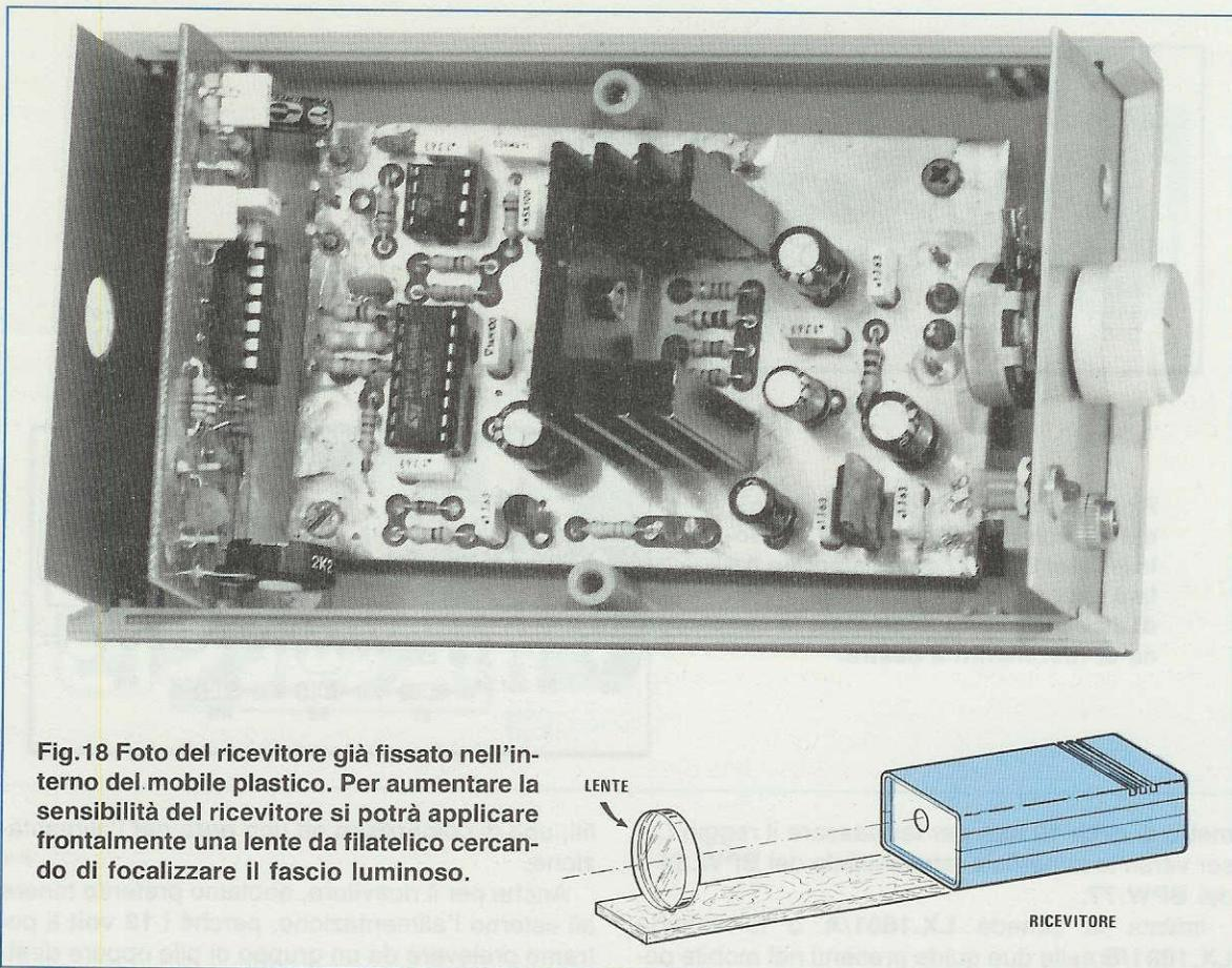
Fig.18 Foto del ricevitore già fissato nell'interno del mobile plastico. Per aumentare la sensibilità del ricevitore si potrà applicare frontalmente una lente da filatelico cercando di focalizzare il fascio luminoso.
