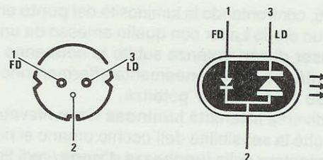
**Fig.11** Connessioni, viste da sotto, di un diodo Laser e disegno grafico che utilizze- remo nei nostri schemi. Il piedino 1 FD, fa capo all'anodo del "fotodiodo" di control- lo; il piedino 3 LD fa capo al catodo del "diodo Laser". Il piedino Comune 2 è sem- pre collegato al metallo del suo corpo.
