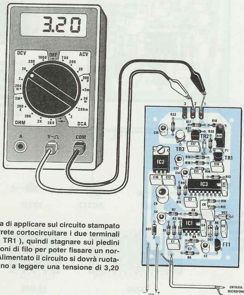
Fig.12 Prima ancora di applicare sul circuito stampato il Diodo Laser, dovrete cortocircuitare i due terminali **P1** ( posto vicino a **TR1** ), quindi stagnare sui piedini **2-1** due corti spezzoni di filo per poter fissare un normale tester in **CC**. Alimentato il circuito si dovrà ruotare il trimmer **R19** fino a leggere una tensione di **3,20 volt**.
