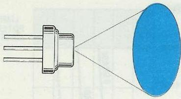
Fig.3 Come già accennato, un Diodo Laser emette un fascio molto divergente e ovalizzato, quindi per poter ottenere un piccolo "punto" luminoso, come quello emesso da un Tubo Laser, dovremo completarlo con un appropriato OBIETTIVO.
