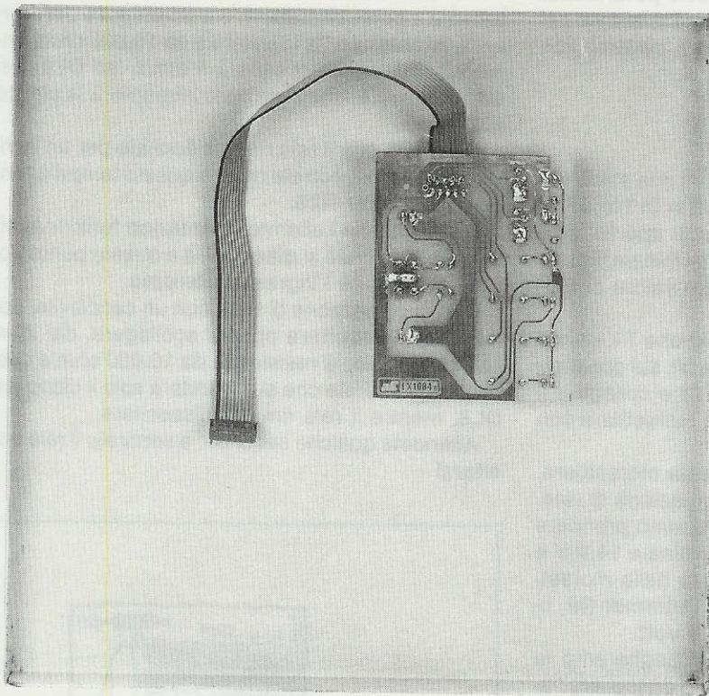
Fig.19 Il circuito visibile in fig.18 verrà fissato, tramite il dado dell'interruttore S1, sul pannello frontale del mobile della centralina. Su tale pannello ( vedi fig.20 ) è riportato un disegno serigrafico con dei simboli molto esplicativi.
