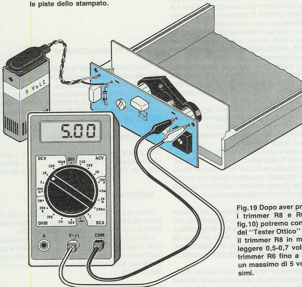
**Fig.19** Dopo aver preparato i trimmer R8 e R6 (vedi fig.10) potremo con l'aiuto del "Tester Ottico" ritarare il trimmer R8 in modo da leggere 0,5-0,7 volt, poi il trimmer R6 fino a leggere un massimo di 5 volt massimi.
