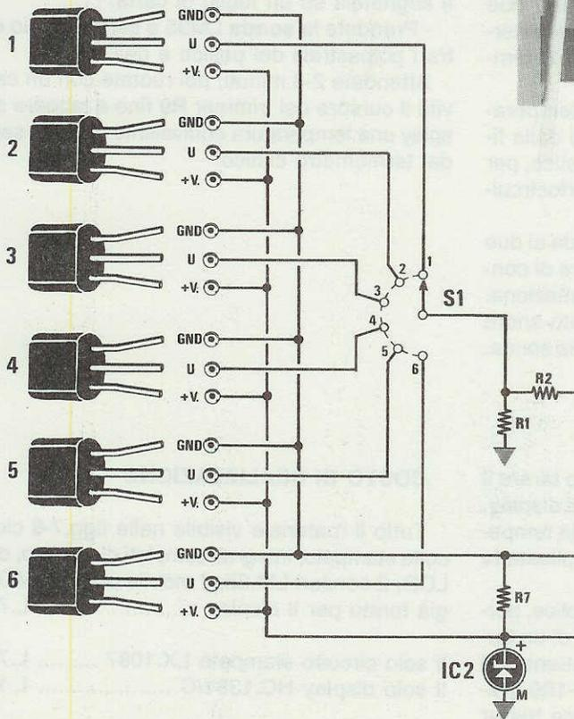
Fig.13 Chi volesse aggiungere più sonde, dovrà sostituire il deviatore a 2 vie da noi utilizzato con un commutatore rotativo a più posizioni. In questo schema potete vedere quanto risulti semplice applicare ad esempio 6 Sonde.
