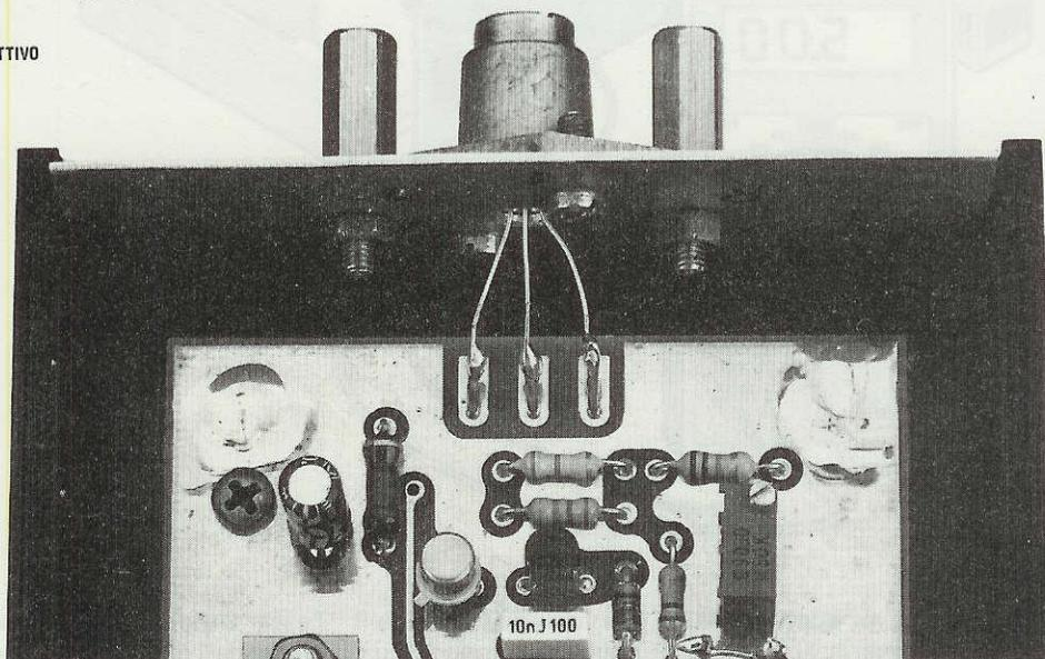
**Fig.15** I tre terminali del Diodo Laser verranno stagnati sulle piste 3-2-1 presenti sul circuito stampato ( vedi fig.9 ) cercando di non invertire i due terminali laterali del diodo. Per primo stagnerete il terminale 2 poi passerete a stagnare il piedino 1 e il 3 o viceversa. Se ancora non l'avete fatto, togliete il ponticello sui due terminali P1 ( vedi in fig.12 il ponticello vicino a TR1 ).
