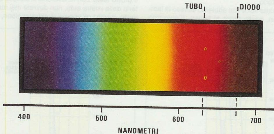
Fig.5 L'occhio umano riesce a percepire con diversa intensità tutte le lunghezze d'onda da 400 a 700 nanometri. Come riportato in questa tavola ad ogni diversa lunghezza d'onda noi vedremo un diverso colore, e poichè 630 nanometri corrispondono ad un color rosso VIVO e 670-680 nanometri ad un color rosso SCURO, vedremo il punto luminoso emesso da un DIODO Laser meno luminoso di quello di un TUBO Laser, anche se di identica potenza.
