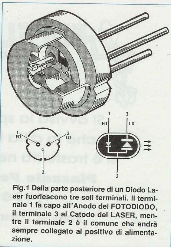
**Fig.1** Dalla parte posteriore di un Diode Laser fuoriescono tre soli terminali. Il terminale 1 fa capo all'Anodo del FOTODIODO, il terminale 3 al Catodo del LASER, mentre il terminale 2 è il comune che andrà sempre collegato al positivo di alimentazione.
