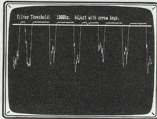
Fig.9 Premendo il tasto "freccia su" dovete portare la riga orizzontale sulla parte superiore di questa onda quadra, poi premere 2 volte il tasto M e vi ritroverete nel menù.
