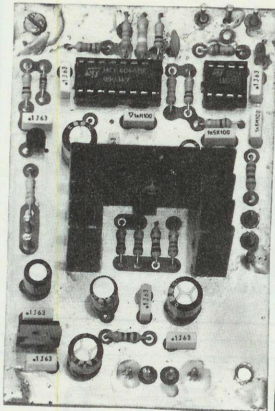
Fig.11 Foto di un primo prototipo di LX.1091. In questo stampato manca il diodo DS2 (posto vicino a R17) che è stato inserito all'ultimo momento.
