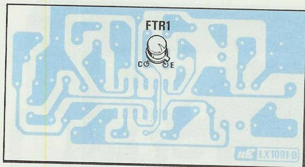
Fig. 16 Schema pratico di montaggio del fotorivelatore LX.1091/B. Il fototransistor BPW.77 andrà montato dal lato opposto di questo stampato (vedi disegno sopra) rivolgendo la tacca di riferimento a destra.
