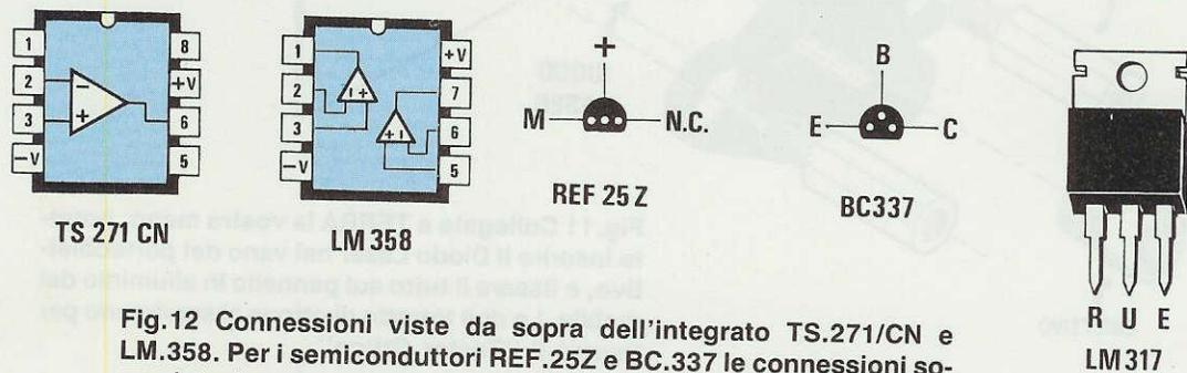
Fig.12 Connessioni viste da sopra dell'integrato TS.271/CN e LM.358. Per i semiconduttori REF.25Z e BC.337 le connessioni sono viste da sotto, mentre le connessioni dell'integrato LM.317 sono viste tenendo la parte metallica sul retro del corpo.
