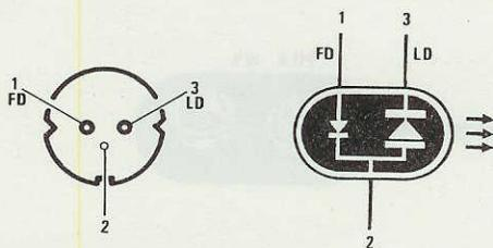
**Fig.9** Dal corpo metallico di ogni Diodo Laser fuoriescono 3 terminali disposti a V. Il terminale 1 fa capo all'anodo del FOTODIODO, il terminale 2 al catodo del DIODO LASER. Il terminale 2 va collegato al positivo di alimentazione.
