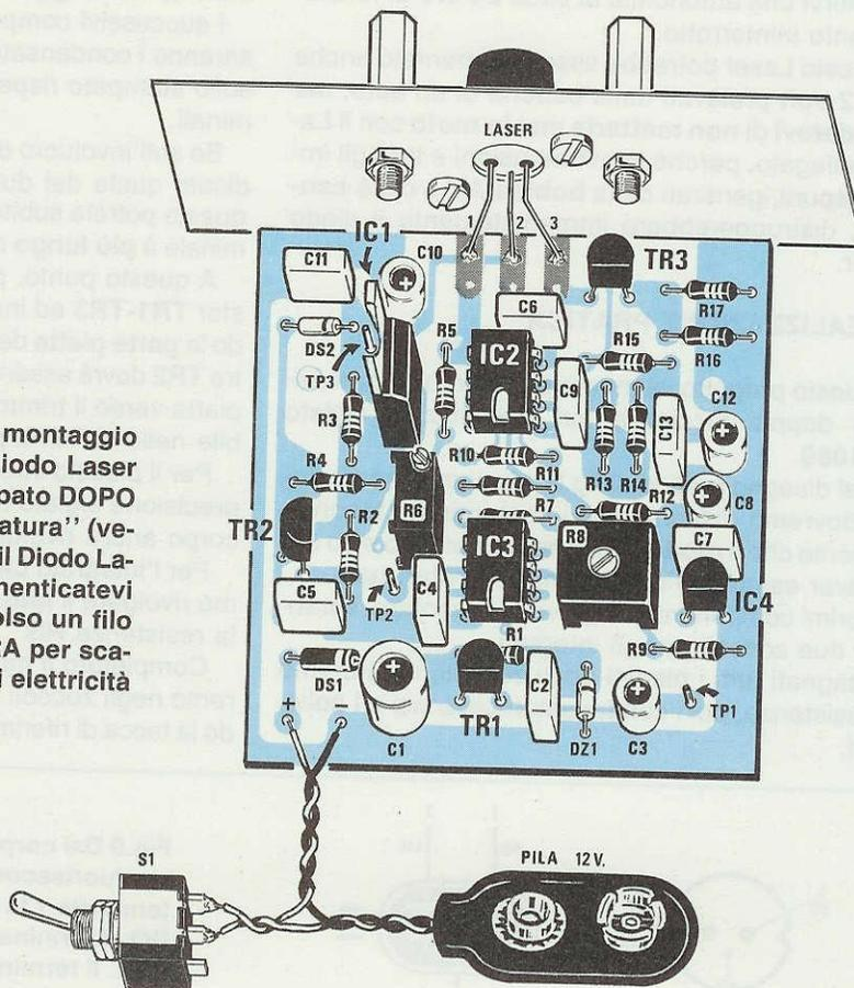
la Base del transistor **TR3**, e, così facendo, **aumenterà** la corrente di alimentazione al diodo Laser, incrementandone di conseguenza anche la luminosità.
