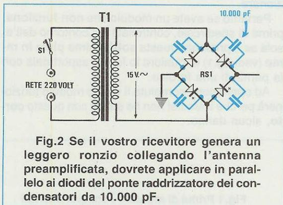
**Fig.2** Se il vostro ricevitore genera un leggero ronzio collegando l'antenna preamplificata, dovrete applicare in parallelo ai diodi del ponte raddrizzatore dei condensatori da 10.000 pF.
