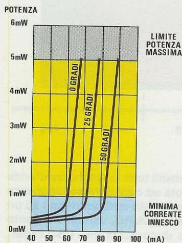
Fig. 7 Curva di pendenza di un Diodo Laser. Come si può notare in questo grafico, se la temperatura varia dovremo automaticamente modificare la corrente di alimentazione, perchè se si superano i 5 milliwatt il diodo si distrugge. Pertanto se facessimo assorbire al diodo 78 mA, ad una temperatura di 25 gradi, e questa dovesse scendere sui 18 gradi, il diodo Laser si distruggerebbe.
