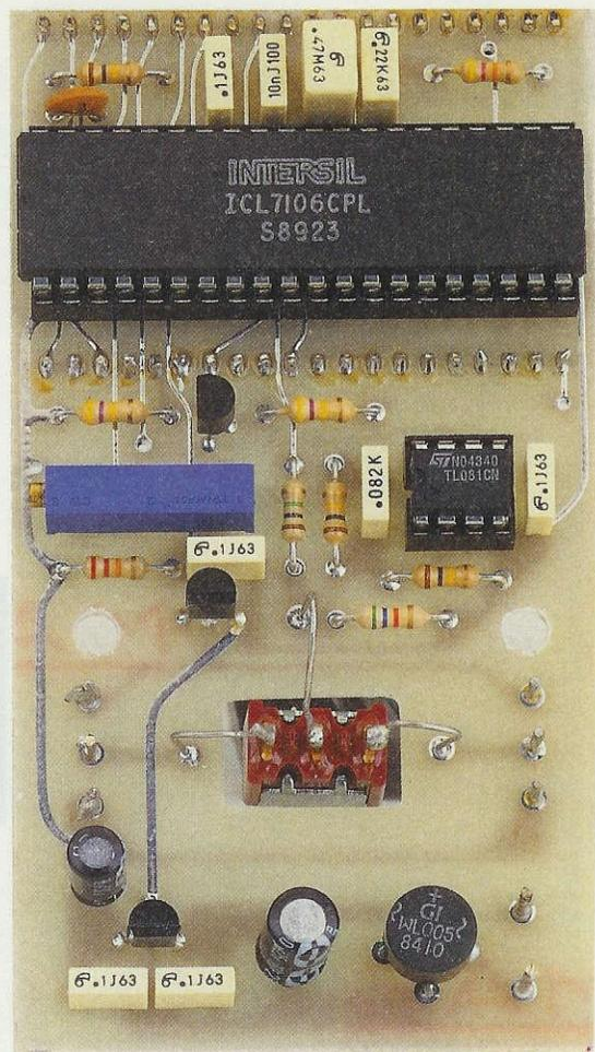
**Fig.1** Foto del circuito **LX.1087** visto dal lato dei componenti. Si noti in basso al centro la finestra praticata sullo stampato per poter effettuare il corto collegamento sui tre terminali del deviatore **S1**. (vedi fig.7)
