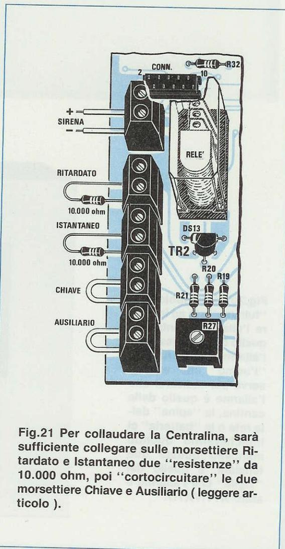
**Fig.21** Per collaudare la Centralina, sarà sufficiente collegare sulle morsettiere Ritardato e Istantaneo due "resistenze" da 10.000 ohm, poi "cortocircuiterare" le due morsettiere Chiave e Ausiliario ( leggere articolo ).
