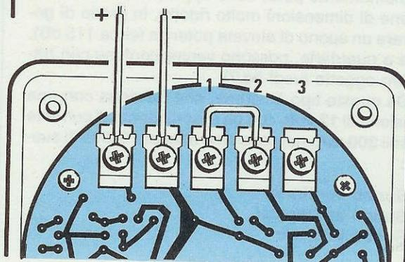
**Fig.10** Volendo ottenere un suono BILTONALE dobbiamo invece cortocircuitare, sempre con un corto spezzone di filo, i morsetti che noi abbiamo contrassegnato con i numeri 1-3.
