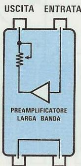
**Fig.429** Nei moduli Preamplificatori a Larga Banda, abbiamo sopra una boccola contrassegnata INGRESSO e una contrassegnata USCITA. Le due boccole poste sotto sono collegate in parallelo. Il trimmer regola il "guadagno" da 0 a 20 dB.
