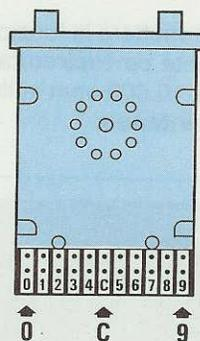
Fig.24 Sul commutatore della Chiave sono presenti 11 piste. Su ogni pista c'è il numero di codice. Il terminale "C" è il centrale del commutatore. In basso la foto dei tre commutatori già fissati sul pannello del mobile.
