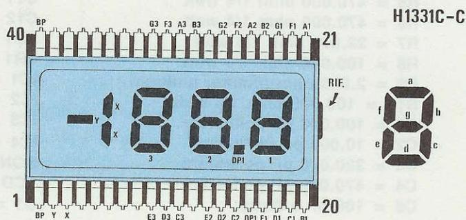
Fig.6 Di lato, lo stampato LX.1087 visto dalla parte del Display. Poichè non esiste uno zoccolo per questo Display, abbiamo usato due connettori femmine da 20 piedini. Il lato di riferimento indicato RIF va rivolto a destra.
