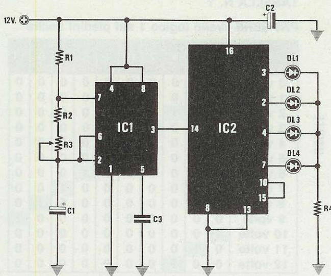
Fig.4 Schema che provvede a far accendere in sequenza solo quattro diodi led.
