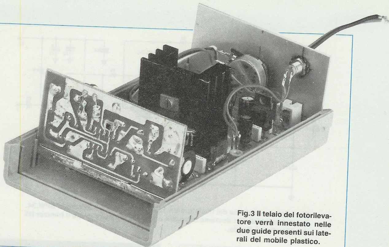
Fig.3 Il telaio del fotorilevatore verrà innestato nelle due guide presenti sui laterali del mobile plastico.
