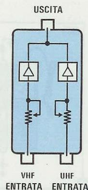
**Fig.430** Nell'Amplificatore Finale di Potenza abbiamo sopra una boccola dove escono i segnali VHF e UHF miscelati, e in basso un ingresso per il segnale VHF e uno per i segnali UHF. Per ogni ingresso abbiamo un separato trimmer del "guadagno".
