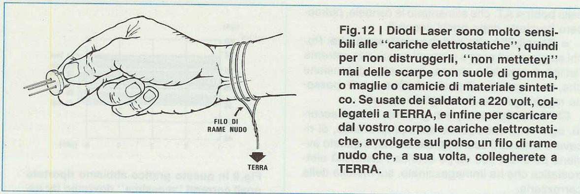
Fig.12 I Diodi Laser sono molto sensibili alle "cariche elettrostatiche", quindi per non distruggerli, "non mettetevi" mai delle scarpe con soles di gomma, o maglie o camicie di materiale sintetico. Se usate dei saldatori a 220 volt, collegateli a TERRA, e infine per scaricare dal vostro corpo le cariche elettrostatiche, avvolgete sul polso un filo di rame nudo che, a sua volta, collegherete a TERRA.
