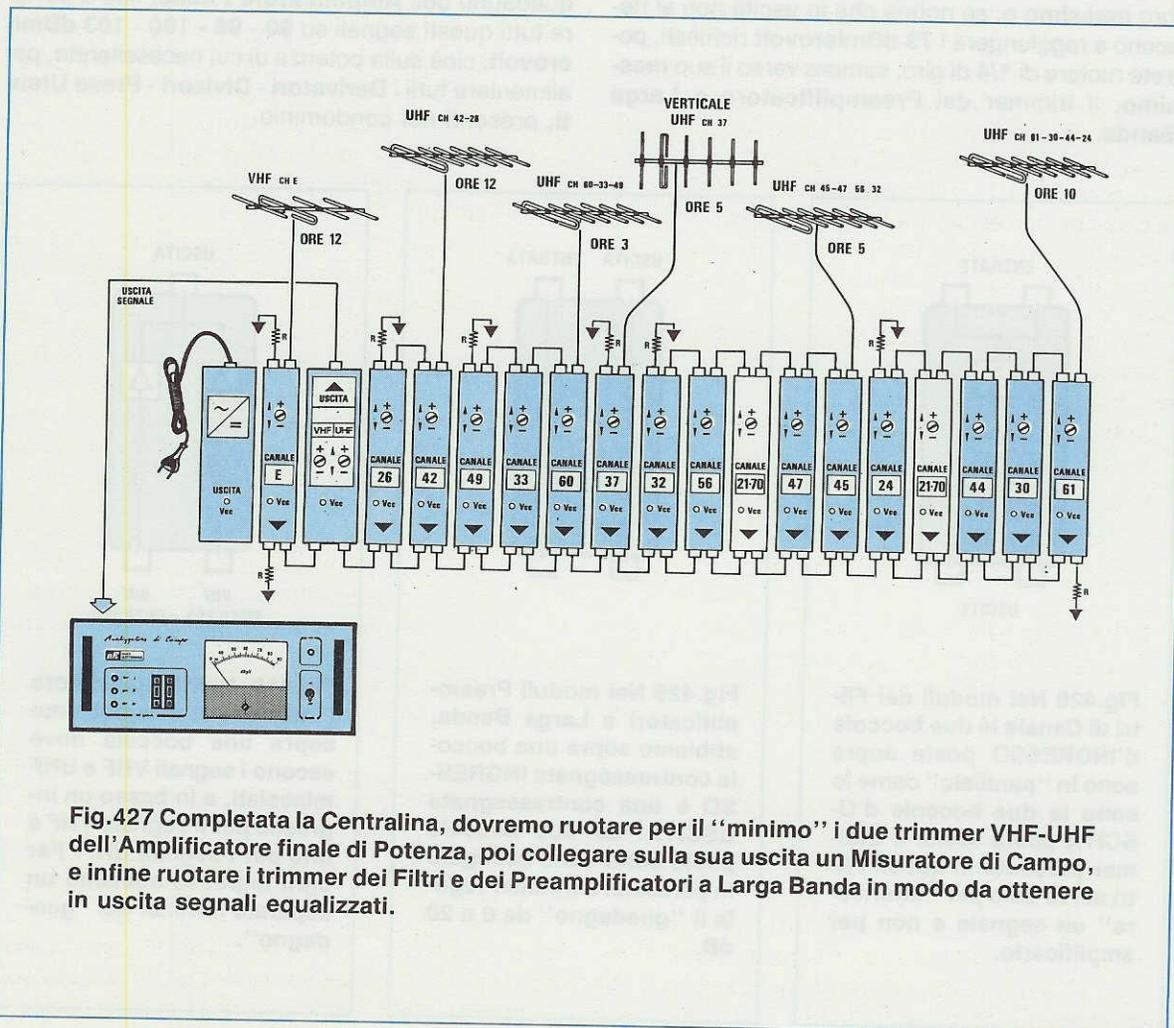
Fig.427 Completata la Centralina, dovremo ruotare per il "minimo" i due trimmer VHF-UHF dell'Amplificatore finale di Potenza, poi collegare sulla sua uscita un Misuratore di Campo, e infine ruotare i trimmer dei Filtri e dei Preamplificatori a Larga Banda in modo da ottenere in uscita segnali equalizzati.
