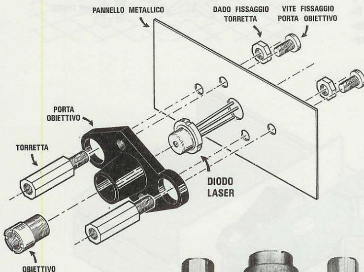
**Fig.14** Sul pannello frontale del mobile applicheremo il portaobiettivo e le due torrette in ottone che ci serviranno per fissare il "Tester Ottico" quando dovremo tarare il Diodo Laser per la massima potenza di 5 milliwatt.
