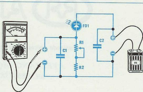
Fig.1 Schema del Tester Ottico, da utilizzare per tarare i Diodi Laser per la sua massima potenza luminosa.
