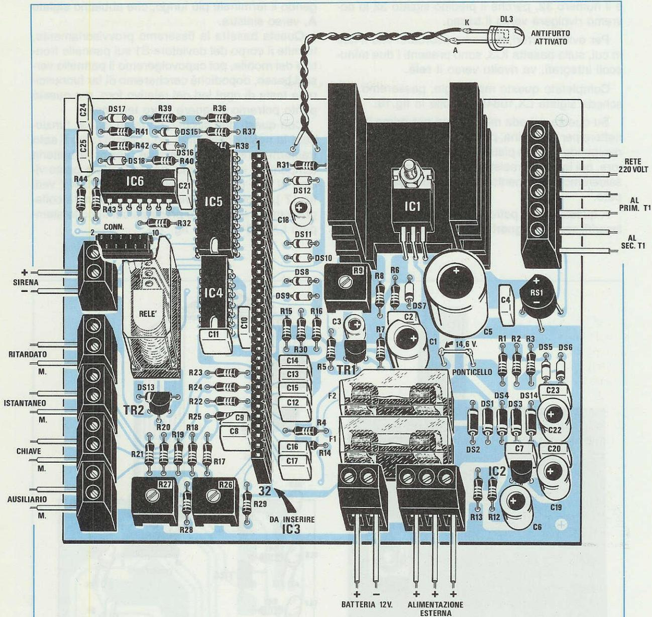
Fig.17 Schema pratico di montaggio della scheda LX.1084. Sulla prima morsettiera di sinistra collegheremo la Sirena, sulla seconda il contatto magnetico della porta d'ingresso, sulla terza tutti i contatti magnetici, posti in serie, collegati a porte e finestre, sulla quarta la Chiave d'accesso, e sull'ultima i fili dei contatti magnetici provenienti dalla cantina o dal garage.
