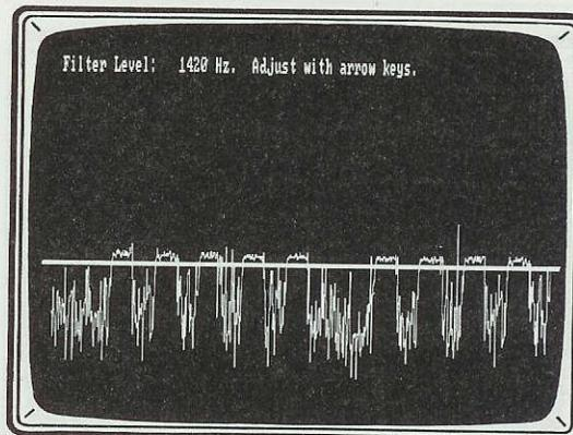
Fig.5 Un segnale telegrafico, oltre a distinguersi ad orecchio, farà apparire sullo schermo delle onde "quadre" che inizialmente possono non essere ben definite.
