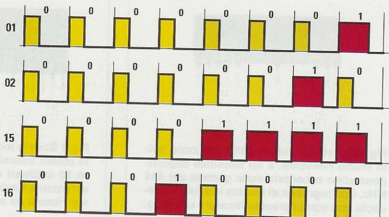
Se volessimo per esempio chiamare il possessore del **cercapersone** codificato con il numero **15**, sulla tastiera dovremo comporre **1** e **5**, poi quando premeremo il pulsante **asterisco** o **cancelletto**, il microprocessore provvederà ad inviare al trasmettitore gli **8 bit** corrispondenti a questo numero, cioè **0000-1111**.
