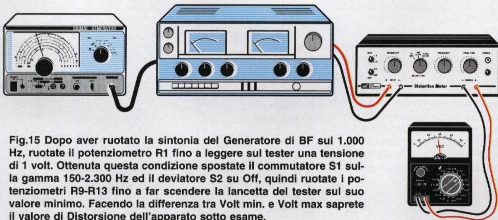
Fig.15 Dopo aver ruotato la sintonia del Generatore di BF sui 1.000 Hz, ruotate il potenziometro R1 fino a leggere sul tester una tensione di 1 volt. Ottenuta questa condizione spostate il commutatore S1 sulla gamma 150-2.300 Hz ed il deviatore S2 su Off, quindi ruotate i potenziometri R9-R13 fino a far scendere la lancetta del tester sul suo valore minimo. Facendo la differenza tra Volt min. e Volt max saprete il valore di Distorsione dell'apparato sotto esame.
