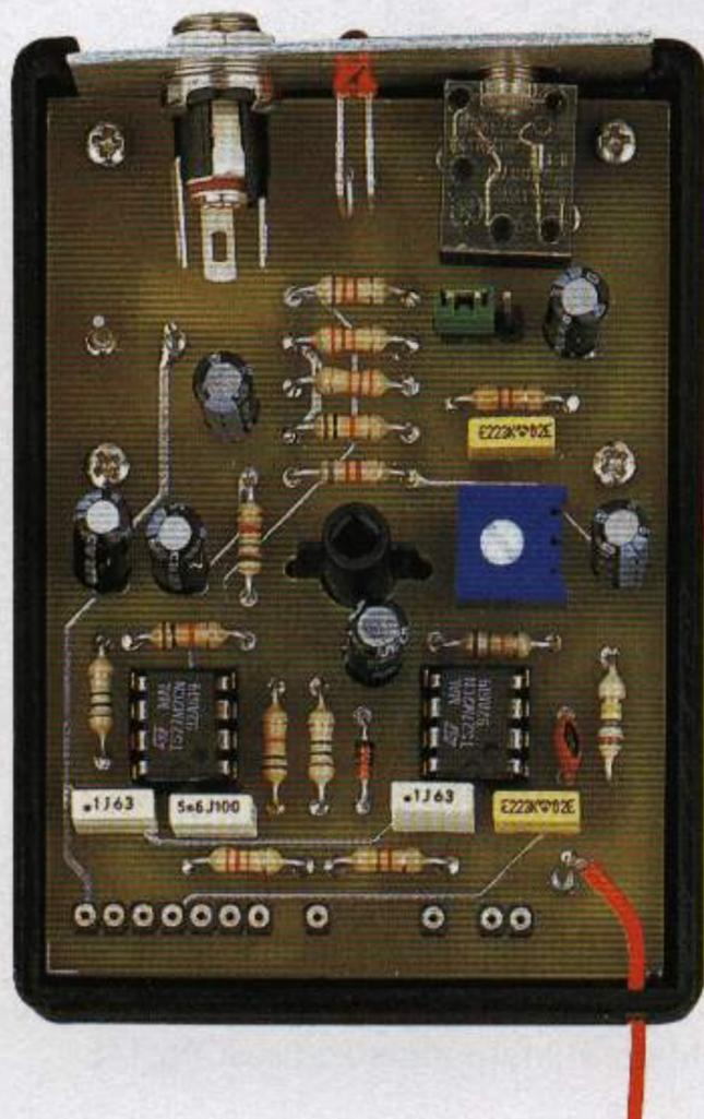
**Fig.13** (Foto a sinistra) Dopo aver saldato i terminali del modulo trasmittente KM01.41 sul circuito stampato, lo dovete ripiegare a L in modo da poter chiudere il coperchio del mobile. Il filo dell'antenna va saldato sul terminale a spillo posto vicino al condensatore C7 (vedi fig. 6).
