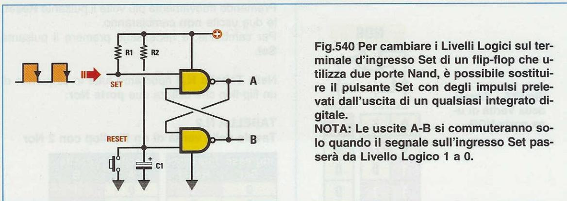
Fig.540 Per cambiare i Livelli Logici sul terminale d'ingresso Set di un flip-flop che utilizza due porte Nand, è possibile sostituire il pulsante Set con degli impulsi prelevati dall'uscita di un qualsiasi integrato digitale.
