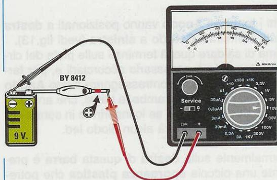
**Fig.15** Se il terminale **POSITIVO** del diodo risulta rivolto verso il positivo del **Tester**, leggerete una tensione di circa **5 volt**, perchè questi diodi per alta tensione introducono una caduta di **4 volt**.
