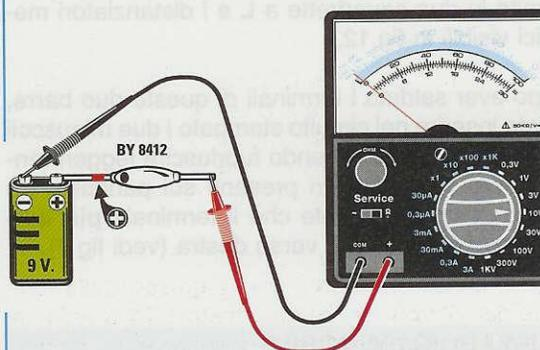
**Fig.16** Se il terminale **POSITIVO** del diodo risulta rivolto verso il positivo della **Pila**, sul **Tester** **NON** leggerete nessuna tensione. Per leggerla dovete solo capovolgere il diodo come visibile in fig.15.
