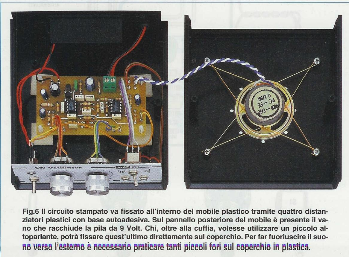
Fig.6 Il circuito stampato va fissato all'interno del mobile plastico tramite quattro distanziatori plastici con base autoadesiva. Sul pannello posteriore del mobile è presente il vano che racchiude la pila da 9 Volt. Chi, oltre alla cuffia, volesse utilizzare un piccolo altoparlante, potrà fissare quest'ultimo direttamente sul coperchio. Per far fuoriuscire il suono verso l'esterno è necessario praticare tanti piccoli fori sul coperchio in plastica.
