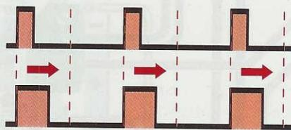
**Fig.5** Con una batteria perfettamente carica, il **Gate** del mosfet **IRF.840** (vedi **MFT1**) viene pilotato da un'onda quadra che ha un **duty-cycle** del **15%**. Più la batteria si scarica più aumenta il **duty-cycle** dell'onda quadra che pilota il **Gate**.
