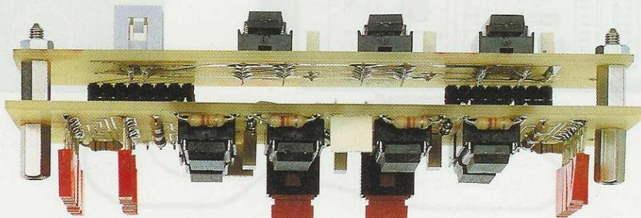
**Fig.19** In questa foto potete vedere i due circuiti stampati LX.1479/B - LX.1479/A tenuti assieme dai distanziatori metallici che troverete inseriti nel kit. Come spieghiamo nel testo, prima di saldare i terminali dei diodi led sulle piste del circuito stampato, controllate che i loro corpi entrino nelle fessure del pannello frontale.
