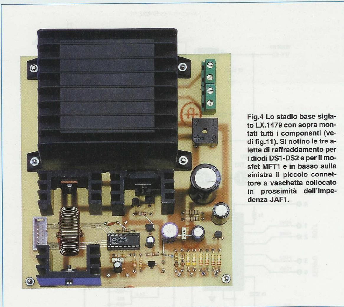
Fig.4 Lo stadio base siglato LX.1479 con sopra montati tutti i componenti (vedi fig.11). Si notino le tre alette di raffreddamento per i diodi DS1-DS2 e per il mosfet MFT1 e in basso sulla sinistra il piccolo connettore a vaschetta collocato in prossimità dell'impedenza JAF1.
