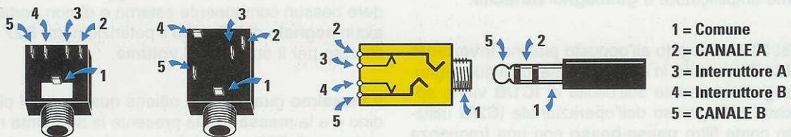
Fig.8 I cinque terminali delle prese jack femmina possono essere disposti come visibile nelle due figure poste a sinistra. Ai terminali 2-5 e 1 vanno collegati i fili che provengono dall'integrato IC3 (vedi fig.7) e dai terminali 3-4 e 1 partiranno i due fili che dovranno raggiungere l'altoparlante posto sul pannello posteriore (vedi fig.6).
