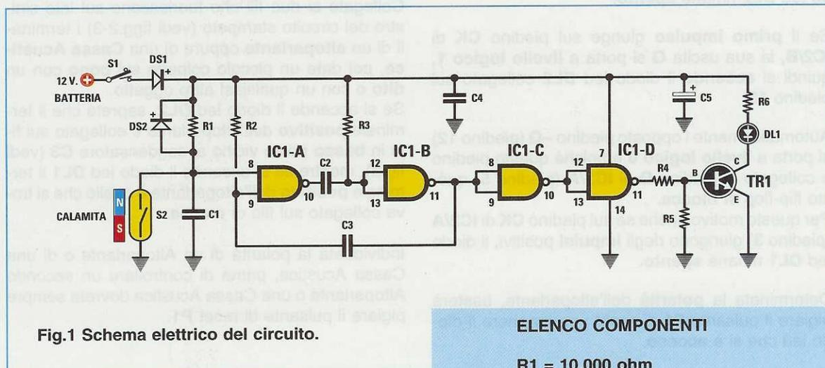
Fig.1 Schema elettrico del circuito.
