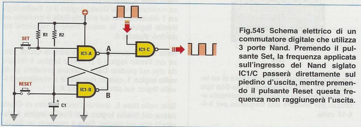
Fig.545 Schema elettrico di un commutatore digitale che utilizza 3 porte Nand. Premendo il pulsante Set, la frequenza applicata sull'ingresso **IC1/C** passerà direttamente sul piedino d'**uscita**, mentre premendo il pulsante Reset questa frequenza non raggiungerà l'**uscita**.
