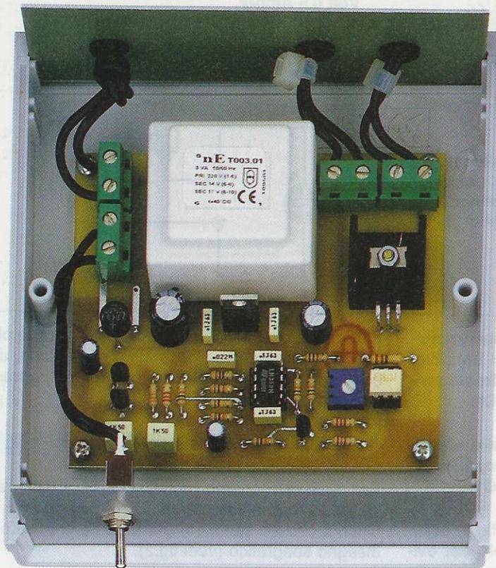
Fig.7 Sul pannello anteriore dovete praticare un foro con una punta da 7 mm per l'interruttore S1 e sul pannello posteriore 3 fori per inserire i gommini passafilo per l'ingresso del filo dei 220 volt (foro di sinistra) e quelli che vi serviranno per alimentare le lampade collegate alla morsetteria d'uscita. Il cursore del trimmer R11 andrà ruotato fino a quando non vedrete i filamenti delle lampade emettere una luce tremolante.
