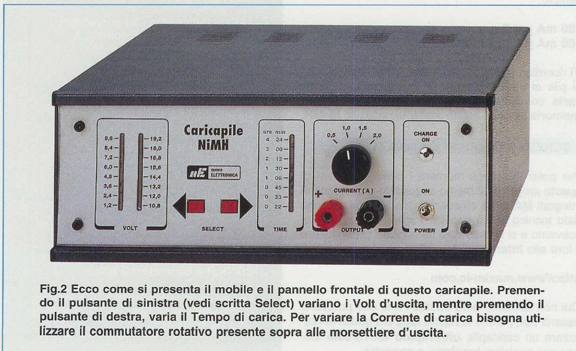
Fig.2 Ecco come si presenta il mobile e il pannello frontale di questo caricapile. Premendo il pulsante di sinistra (vedi scritta Select) variano i Volt d'uscita, mentre premendo il pulsante di destra, varia il Tempo di carica. Per variare la Corrente di carica bisogna utilizzare il commutatore rotativo presente sopra alle morsettiere d'uscita.
