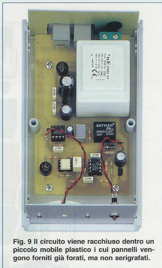
Fig. 9 Il circuito viene racchiuso dentro un piccolo mobile plastico i cui pannelli vengono forniti già forati, ma non serigrafati.
