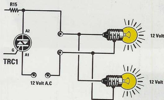
**Fig.5** Se alla morsettiera d'uscita collegate in serie due lampade da 12 V 3 Watt, per alimentarle dovete utilizzare un trasformatore in grado di erogare una tensione di 24 Volt 0,13 Amper.
