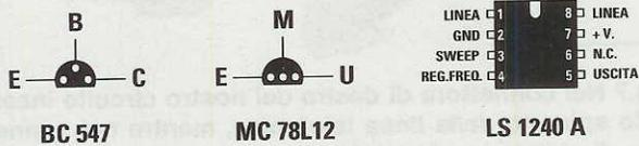
Fig.5 Connessioni del transistor BC.547 e dell'integrato stabilizzatore MC.78L12 viste da sotto e connessioni degli integrati LS.1240/A - LM.311 e del fotoaccoppiatore 4N35 viste da sopra.
