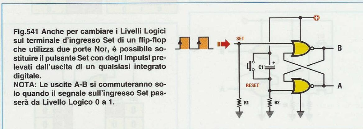
Fig.541 Anche per cambiare i Livelli Logici sul terminale d'ingresso Set di un flip-flop che utilizza due porte Nor, è possibile sostituire il pulsante Set con degli impulsi prelevati dall'uscita di un qualsiasi integrato digitale.
