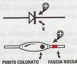
**Fig.14** In tutti i diodi per alta tensione il terminale **Catodo** dovrebbe risultare **contrassegnato** da una fascia **Rossa** oppure da un **punto Nero**. Se questi due punti di riferimento si sono cancellati, per individuare il terminale **+** passate alle figg.15-16.
