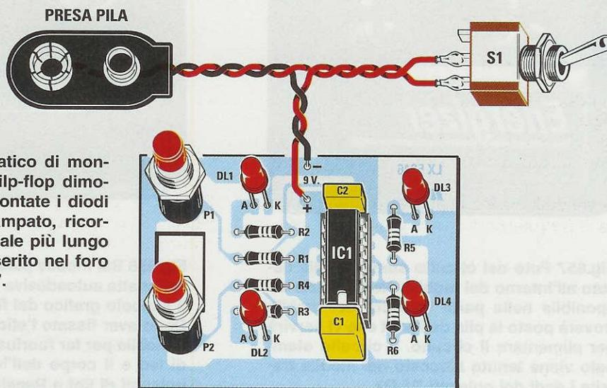
Fig.555 Schema pratico di montaggio del nostro flip-flop dimostrativo. Quando montate i diodi led sul circuito stampato, ricordatevi che il terminale più lungo (vedi fig.559) va inserito nel foro contrassegnato "A".
