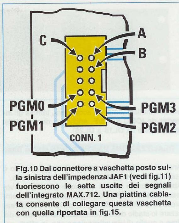
**Fig.10** Dal connettore a vaschetta posto sulla sinistra dell'impedenza **JAF1** (vedi fig.11) fuoriescono le sette uscite dei segnali dell'integrato **MAX.712**. Una piattina cablata consente di collegare questa vaschetta con quella riportata in fig.15.
