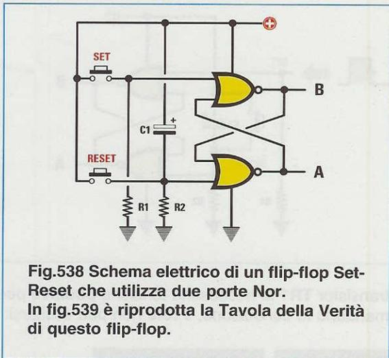
A condensatore elettrolitico **carico**, anche il piedino **Reset** si porterà a **livello logico 0**, ma i livelli logici sulle due uscite **A-B** non cambiano:
