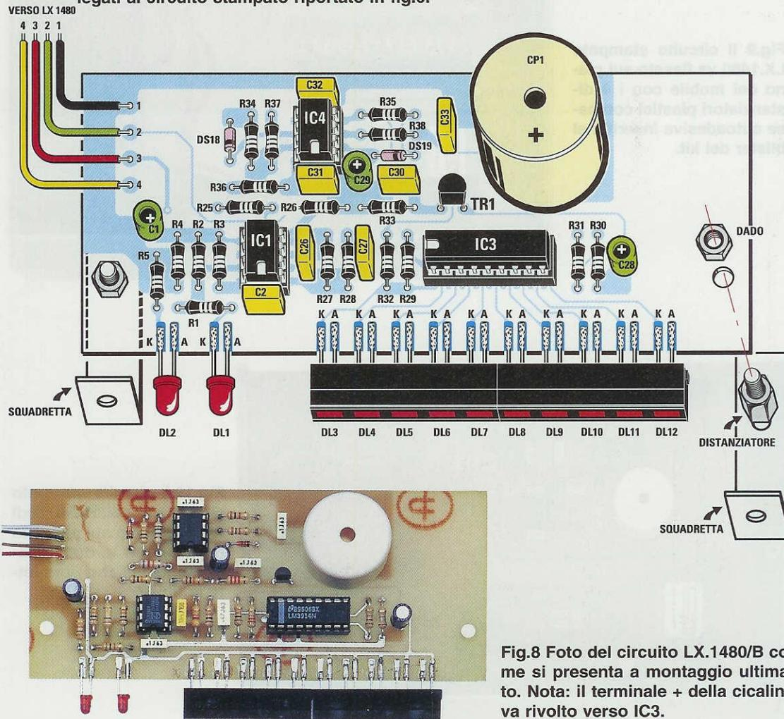
Fig.8 Foto del circuito LX.1480/B come si presenta a montaggio ultimato. Nota: il terminale + della cicalina va rivolto verso IC3.
