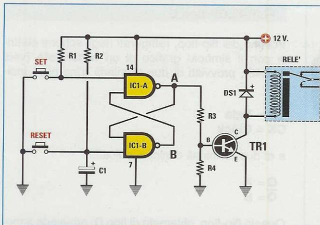
Fig.542 Con questo circuito, premendo il pulsante Set il relè si ecciterà e premendo il pulsante Reset si disecciterà.
