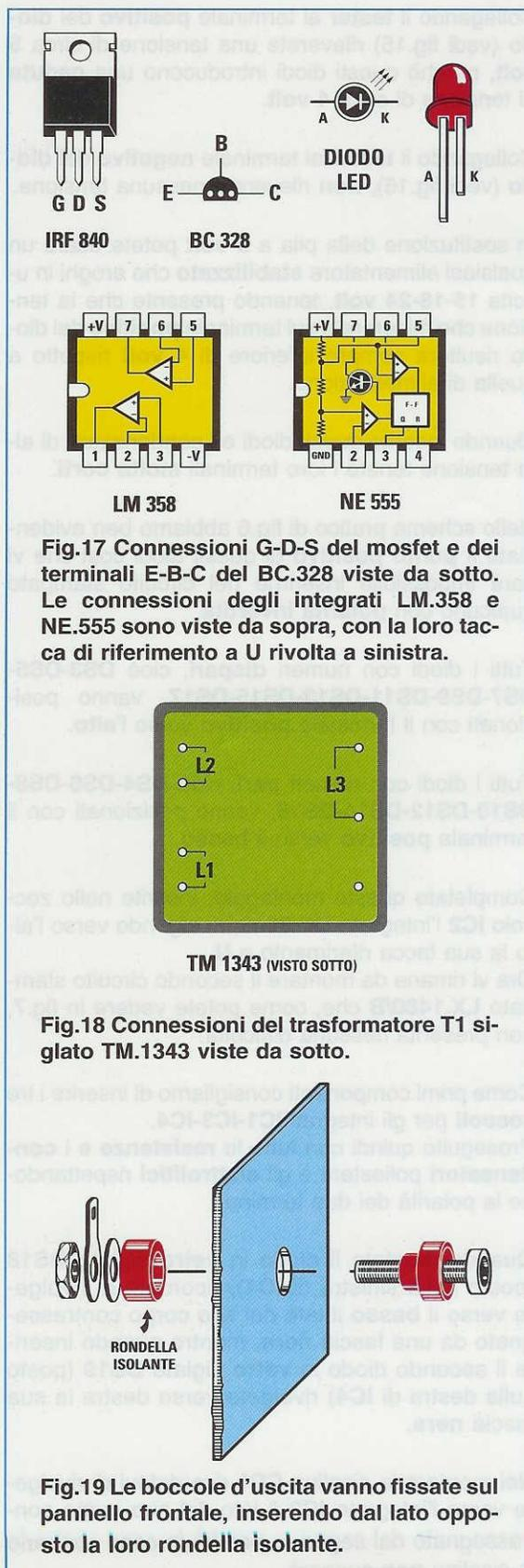
**Fig.17** Connessioni G-D-S del mosfet e dei terminali E-B-C del BC.328 viste da sotto. Le connessioni degli integrati LM.358 e NE.555 sono viste da sopra, con la loro tacca di riferimento a U rivolta a sinistra.
