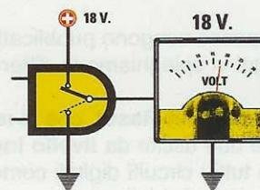
**Fig.533** Se si utilizzano degli integrati C/Mos che possono essere alimentati con tensioni variabili da 5 Volt a 18 Volt, è sottinteso che i loro Livelli Logici assumeranno un valore pari alla tensione utilizzata per la loro alimentazione.
