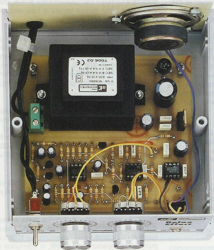
Fig.6 Il circuito stampato va fissato con 4 viti sulla base del mobile plastico, il piccolo altoparlante sul pannello posteriore, mentre la presa cuffia sul pannello anteriore.
