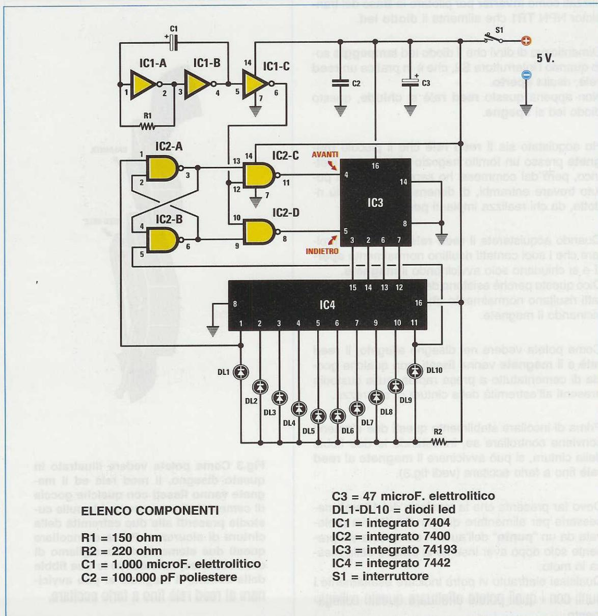
rad, mentre per aumentarla bisogna ridurre questa capacità, sostituendo il condensatore **C1** con due elettrolitici da **470 microfarad** collegati in **parallelo** in modo da ottenere **940 microfarad**, oppure con uno soltanto da **470 microfarad**.
