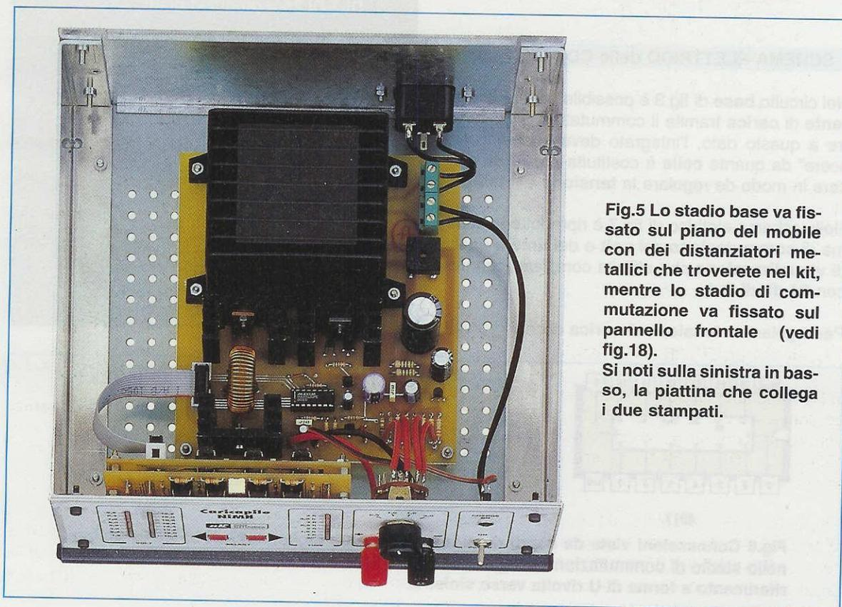
**Fig.5** Lo stadio base va fissato sul piano del mobile con dei distanziatori metallici che troverete nel kit, mentre lo stadio di commutazione va fissato sul pannello frontale (vedi fig.18).
