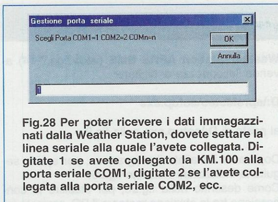
Fig.28 Per poter ricevere i dati immagazzinati dalla Weather Station, dovete settare la linea seriale alla quale l'avete collegata. Digitate 1 se avete collegato la KM.100 alla porta seriale COM1, digitate 2 se l'avete collegata alla porta seriale COM2, ecc.
