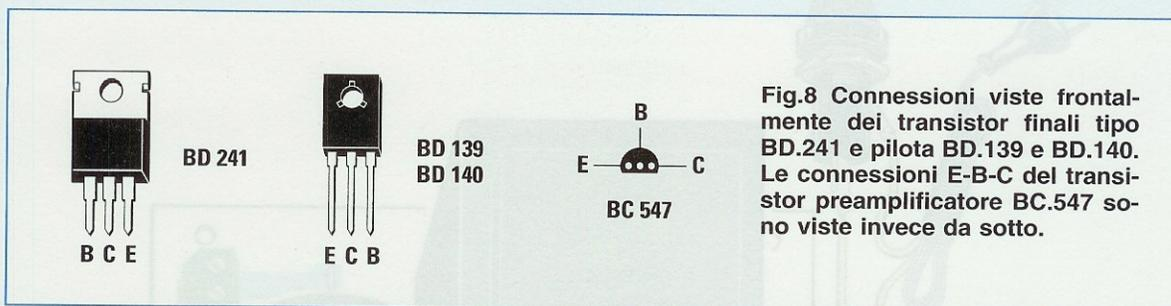
Fig.8 Connessioni viste frontalmente dei transistor finali tipo BD.241 e pilota BD.139 e BD.140. Le connessioni E-B-C del transistor preamplificatore BC.547 sono viste invece da sotto.
