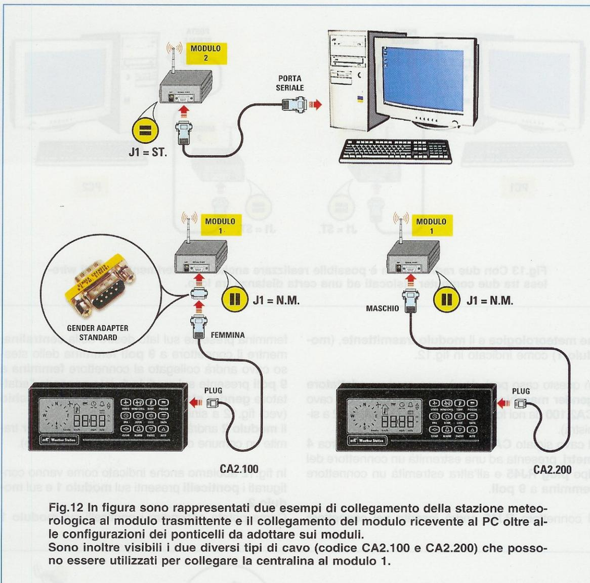
Fig.12 In figura sono rappresentati due esempi di collegamento della stazione meteorologica al modulo trasmittente e il collegamento del modulo ricevente al PC oltre alle configurazioni dei ponticelli da adottare sui moduli. Sono inoltre visibili i due diversi tipi di cavo (codice CA2.100 e CA2.200) che possono essere utilizzati per collegare la centralina al modulo 1.
