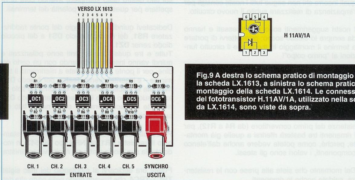
**Fig.9** A destra lo schema pratico di montaggio della scheda LX.1613, a sinistra lo schema pratico di montaggio della scheda LX.1614. Le connessioni del fototransistor H.11AV/1A, utilizzato nella scheda LX.1614, sono viste da sopra.
