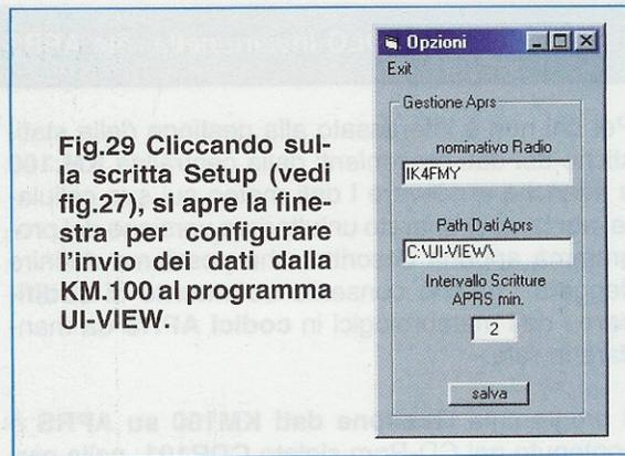
Fig.29 Cliccando sulla scritta Setup (vedi fig.27), si apre la finestra per configurare l'invio dei dati dalla KM.100 al programma UI-VIEW.
