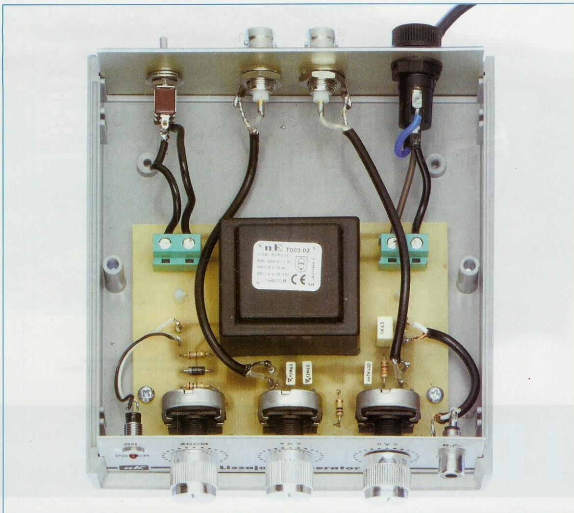
**Fig.21** Dopo aver montato tutti i componenti sul circuito stampato LX.1612, fissate quest'ultimo sulla base del mobile plastico ed eseguite tutti i collegamenti con i componenti posti sia sul pannello anteriore sia su quello posteriore.
