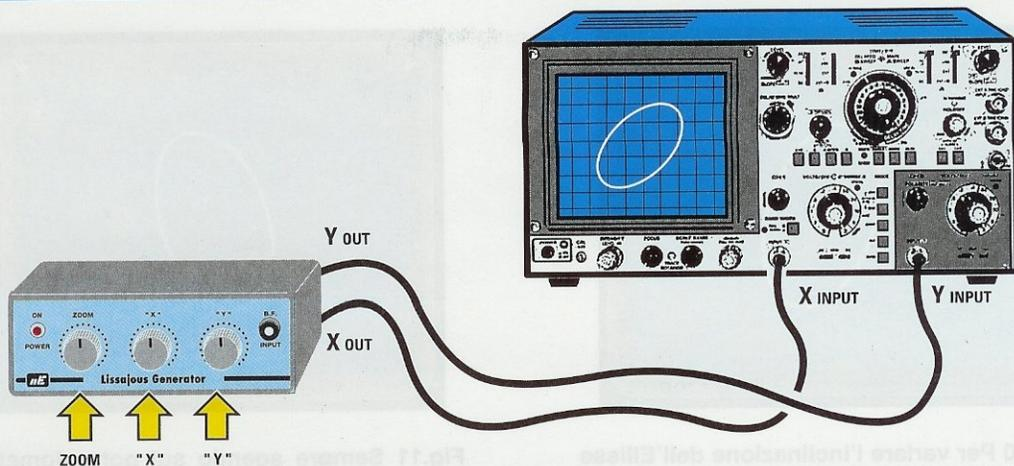
Fig.7 Per collegare i due BNC d'uscita FEMMINA posti sul retro del mobile, potete utilizzare due spezzoni di cavo coassiale lunghi circa 50 cm., provvisti alle due estremità di due BNC MASCHIO. Se in commercio non trovate questo filo, ricordate che noi ve lo possiamo fornire già cablato.
