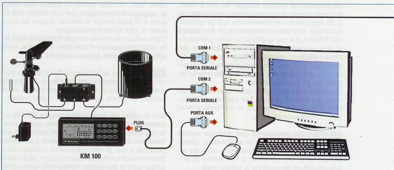
Il collegamento tra i vari apparati è visibile nello schema che abbiamo riprodotto qui sopra, in fig. 1.
