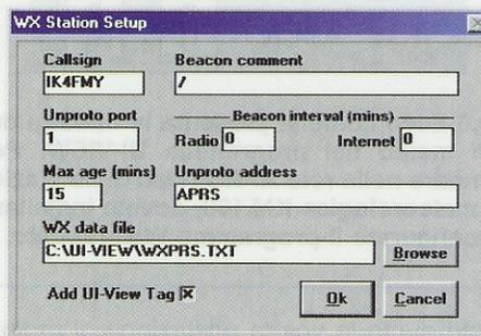
Fig.4 Per avviare la lettura dei dati meteo codificati per l'**APRS**, digitate il percorso completo del file nella casella bianca sotto la scritta **WX data file**, che nel nostro caso è: **C:\UI-VIEW\WXPRS.TXT**.
