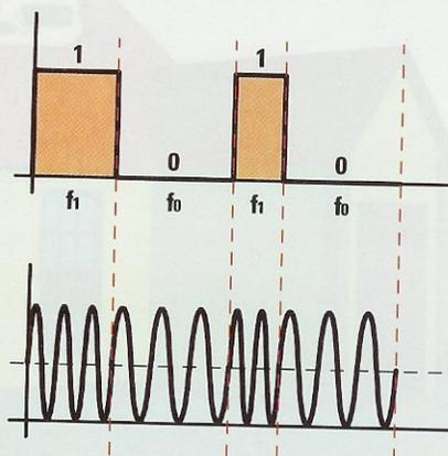
Fig.3 Il trasmettitore converte il segnale digitale in due distinti valori di frequenza, uno corrispondente al livello logico 0 ed uno corrispondente al livello logico 1.
