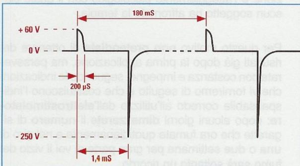
**Fig.2 Dal secondario del trasformatore TM1 (vedi fig.3) escono degli strettissimi impulsi "negativi" della durata di 1,47 millisecondi (tempo T/on) seguiti da una pausa di 180 millisecondi (tempo T/off). Gli impulsi "positivi" presenti prima degli impulsi negativi servono per evitare eventuali effetti di elettrolisi del sangue.**
