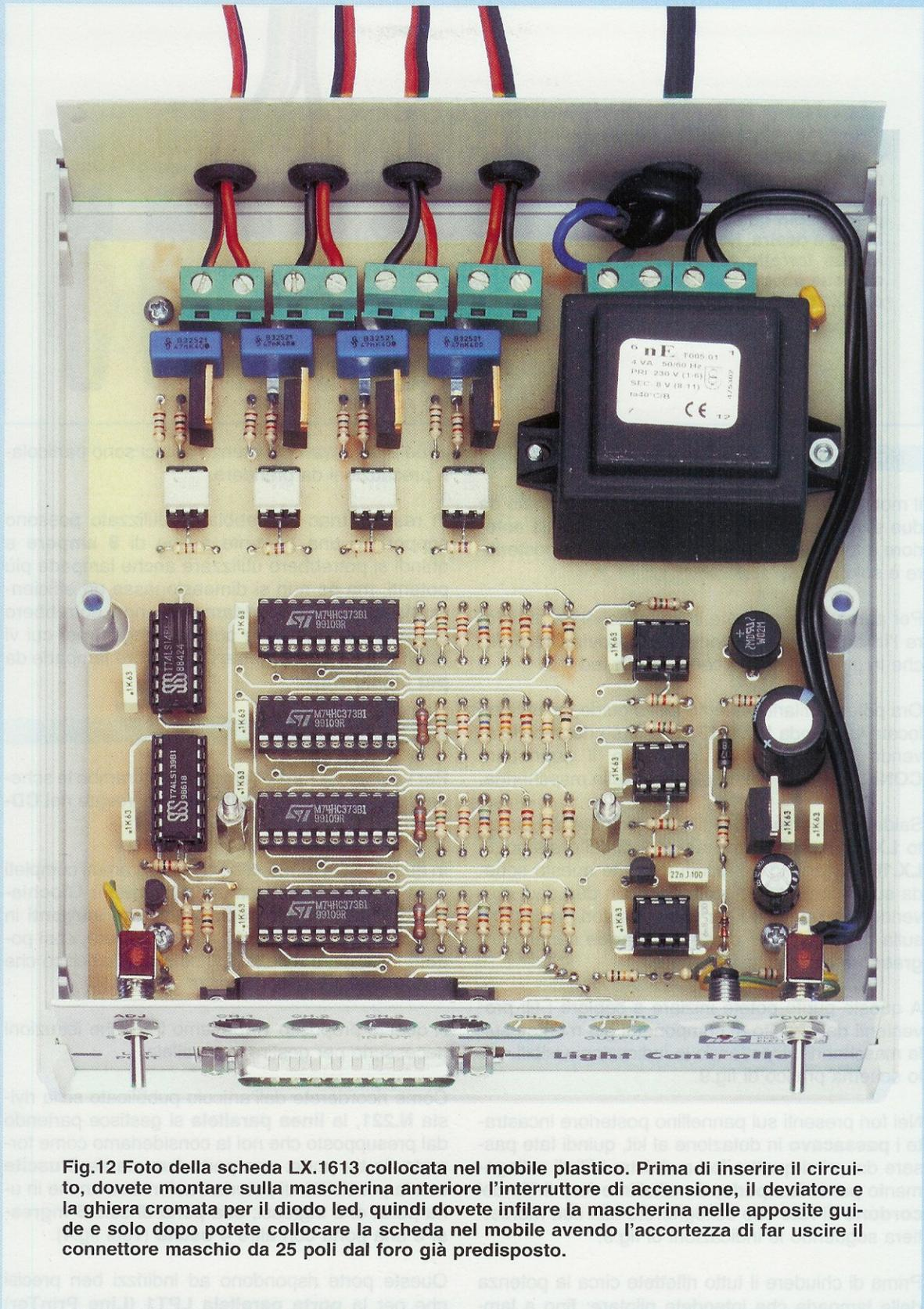
**Fig.12** Foto della scheda LX.1613 collocata nel mobile plastico. Prima di inserire il circuito, dovete montare sulla mascherina anteriore l'interruttore di accensione, il deviatore e la ghiera cromata per il diodo led, quindi dovete infilare la mascherina nelle apposite guide e solo dopo potete collocare la scheda nel mobile avendo l'accortezza di far uscire il connettore maschio da 25 poli dal foro già predisposto.
