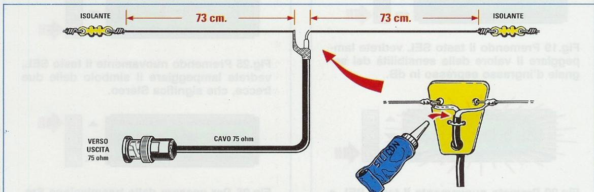
Fig.33 Se desiderate collegare a questo Eccitatore FM un Dipolo esterno per poter aumentare la sua portata, procedete come illustrato in figura.
