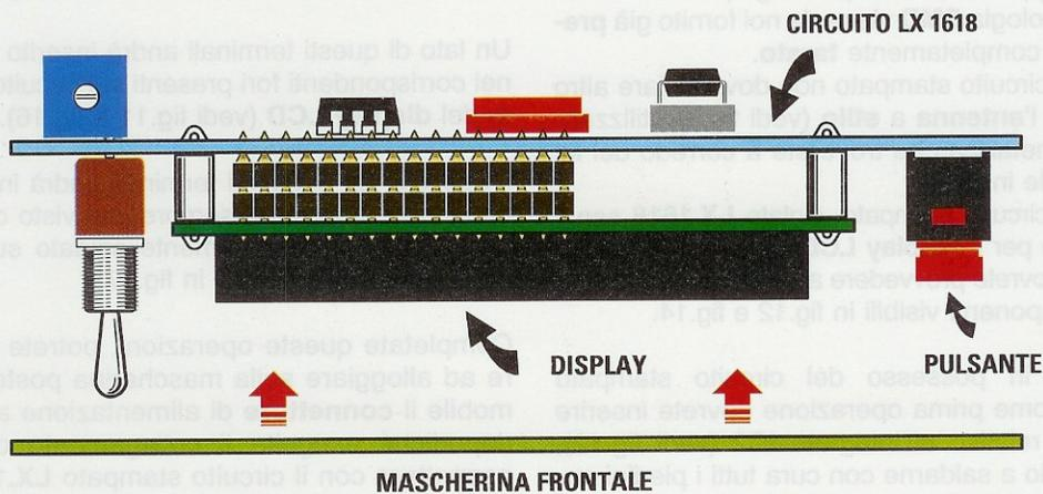
Fig.18 Il circuito stampato completo del Display andrà fissato sul pannello frontale del mobile e tenuto bloccato con il dado dell'interruttore S1. Se i perni plastici non entrarono nel Display potreste riscaldarli con la punta del saldatore.
