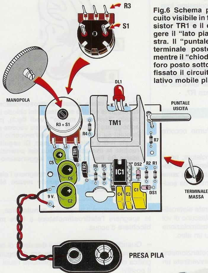
Fig.6 Schema pratico di montaggio del circuito visibile in fig.3. Quando inserirete il transistor TR1 e il darlington TR2, dovrete rivolgere il "lato piatto" del loro corpo verso destra. Il "puntale" d'uscita andrà saldato sul terminale posto sopra alla resistenza R7, mentre il "chiodo" di massa andrà inserito nel foro posto sotto la resistenza R7, dopo avere fissato il circuito stampato all'interno del relativo mobile plastico.
