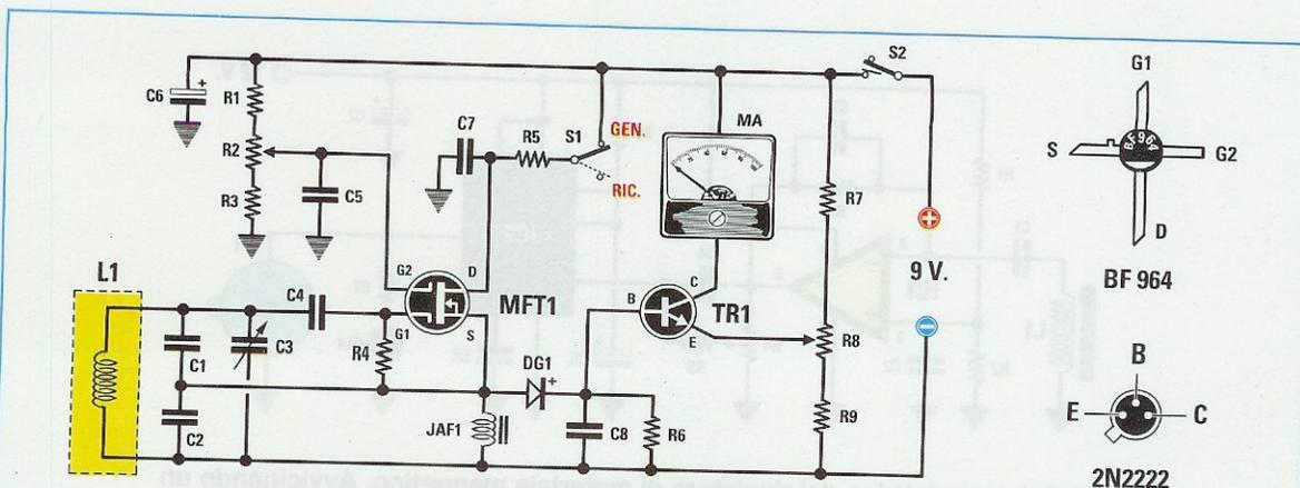
Fig.1 Qui sopra, schema elettrico del Grid-Dip-Meter e, a destra, connessioni del Mosfet BF.964 e del transistor 2N.2222 viste da sotto.
