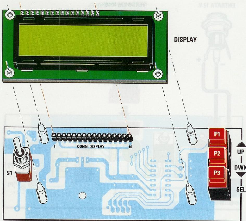
Fig.14 In questo lato del circuito stampato LX.1618 dovete inserire il Connettore femmina a 16 fori necessario per innestare il connettore maschio visibile nelle figg.16-17-18. Sulla sinistra dovete fissare l'interruttore a levetta siglato S1 e sulla destra i tre pulsanti indicati P1-P2-P3. Nei 4 fori presenti sul circuito stampato innesterete i distanziatori plastici necessari per bloccare il corpo del display.
