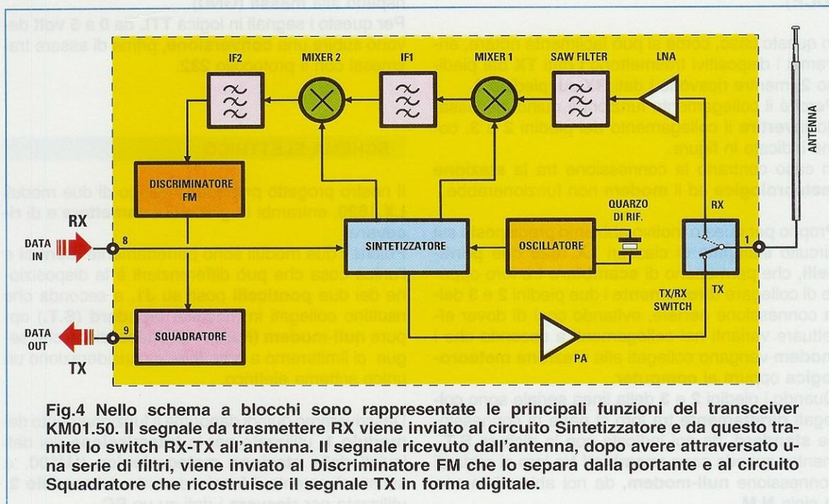
Fig.4 Nello schema a blocchi sono rappresentate le principali funzioni del transceiver KM01.50. Il segnale da trasmettere RX viene inviato al circuito Sintetizzatore e da questo tramite lo switch RX-TX all'antenna. Il segnale ricevuto dall'antenna, dopo avere attraversato una serie di filtri, viene inviato al Discriminatore FM che lo separa dalla portante e al circuito Squadratore che ricostruisce il segnale TX in forma digitale.
