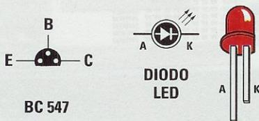
Fig.3 Connessioni del transistor NPN BC.547 viste da sotto con la parte piatta del corpo rivolta verso il basso. Quando collegate i diodi led, ricordate che il terminale più lungo è l'Anodo.
