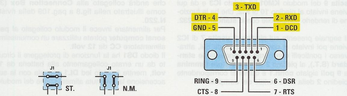
Fig.8 In figura sono rappresentate le configurazioni dei 2 ponticelli da inserire sul connettore J1, corrispondenti al collegamento seriale di tipo standard (S.T.) e al collegamento seriale di tipo Null-Modem (N.M.). A fianco è rappresentata la configurazione del connettore femmina a 9 pin utilizzato per il collegamento seriale standard.
