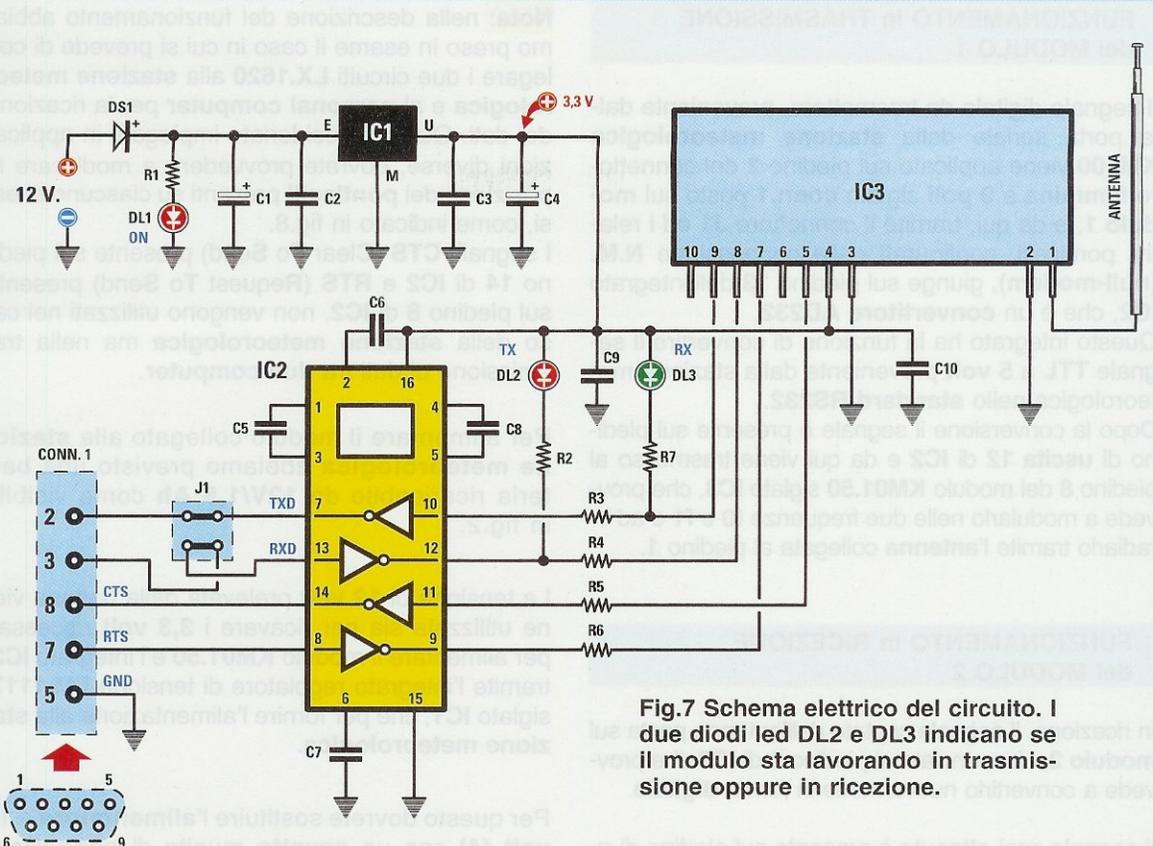
Fig.7 Schema elettrico del circuito. I due diodi led DL2 e DL3 indicano se il modulo sta lavorando in trasmissione oppure in ricezione.
