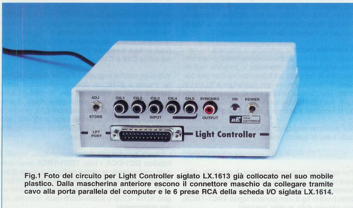
Fig.1 Foto del circuito per Light Controller siglato LX.1613 già collocato nel suo mobile plastico. Dalla mascherina anteriore escono il connettore maschio da collegare tramite cavo alla porta parallela del computer e le 6 prese RCA della scheda I/O siglata LX.1614.
