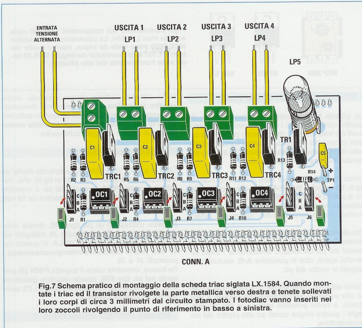
Fig.7 Schema pratico di montaggio della scheda triac siglata LX.1584. Quando montate i triac ed il transistor rivolgete la parte metallica verso destra e tenete sollevati i loro corpi a circa 3 millimetri dal circuito stampato. I fotodiac vanno inseriti nei loro zoccoli rivolgendo il punto di riferimento in basso a sinistra.
