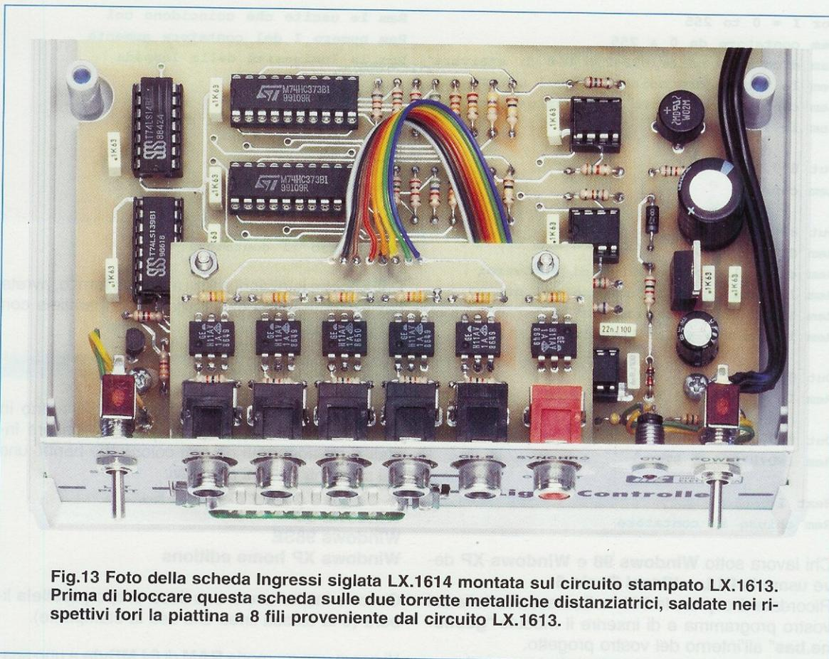
**Fig.13** Foto della scheda Ingressi siglata LX.1614 montata sul circuito stampato LX.1613. Prima di bloccare questa scheda sulle due torrette metalliche distanziatrici, saldate nei rispettivi fori la piattina a 8 fili proveniente dal circuito LX.1613.
