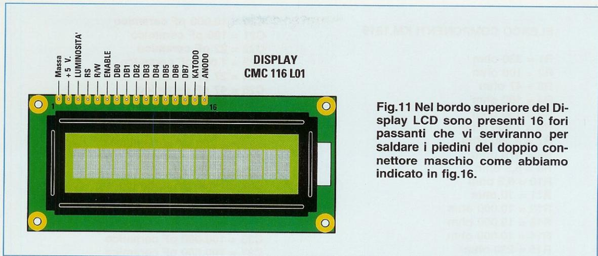
Fig.11 Nel bordo superiore del Display LCD sono presenti 16 fori passanti che vi serviranno per saldare i piedini del doppio connettore maschio come abbiamo indicato in fig.16.
