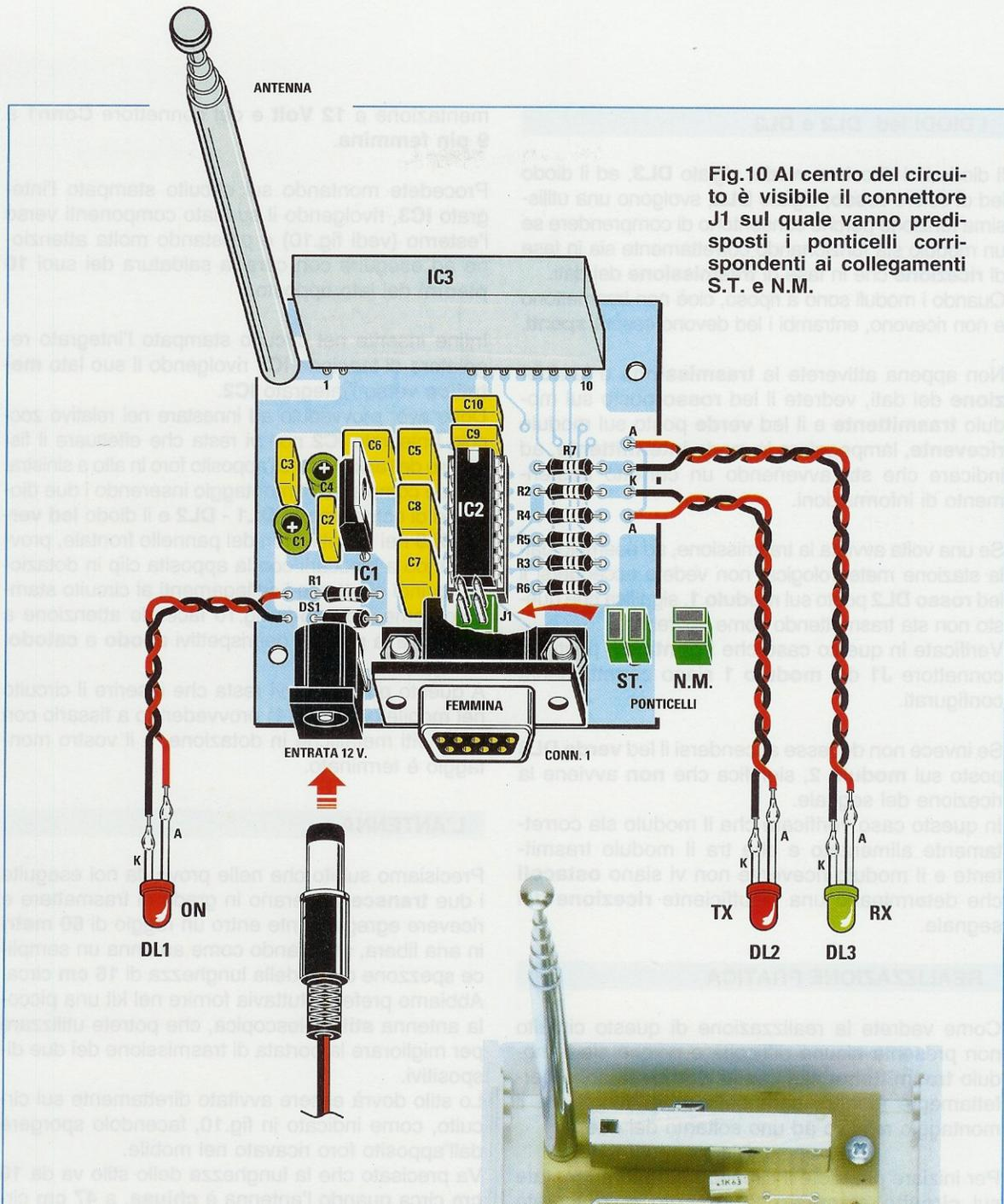
Fig.10 Al centro del circuito è visibile il connettore J1 sul quale vanno predisposti i ponticelli corrispondenti ai collegamenti S.T. e N.M.
