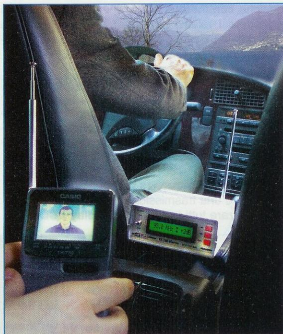
**Fig.5** Se collegate la presa audio di un piccolo televisore portatile all'Eccitatore FM, potrete utilizzare l'impianto stereo della vostra auto o del vostro camper per potenziarne la riproduzione sonora.
