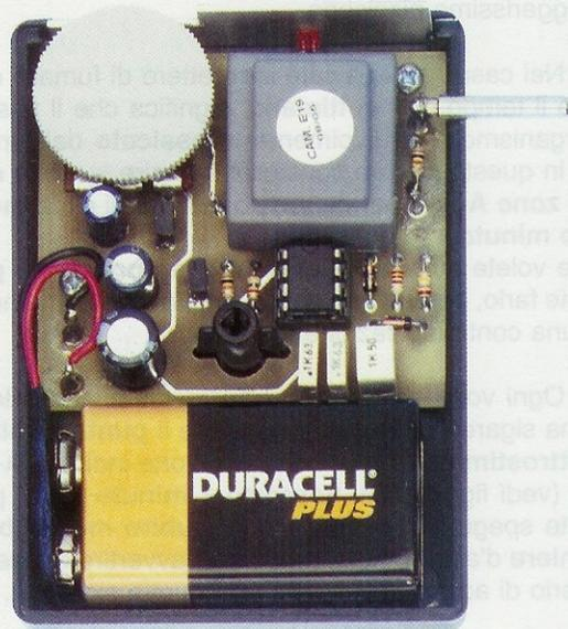
la da **9 volt** ruotando la manopola a disco in modo da far scattare l'interruttore **S1**, vedrete subito **lampeggiare** il diodo led a conferma che non avete commesso alcun errore nel vostro montaggio.
