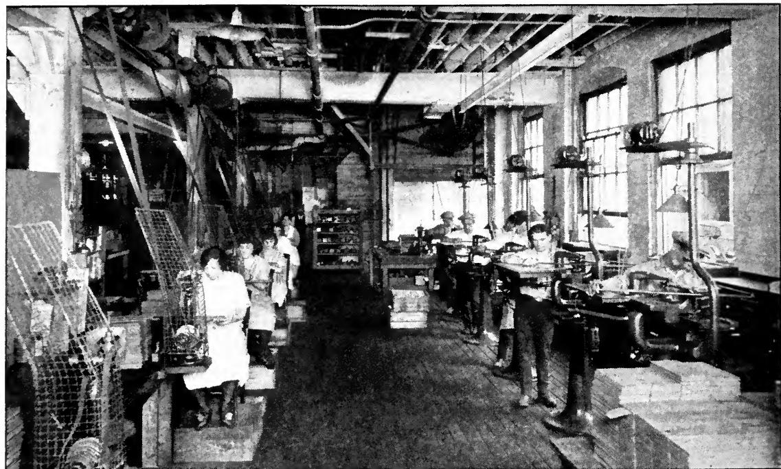
ENGRAVING AND FINISHING PANELS FOR FOUR-TUBE RECEIVERS
