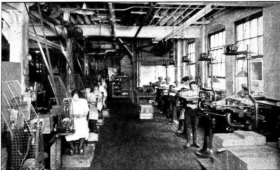
ENGRAVING AND FINISHING PANELS FOR FOUR-TUBE RECEIVERS
