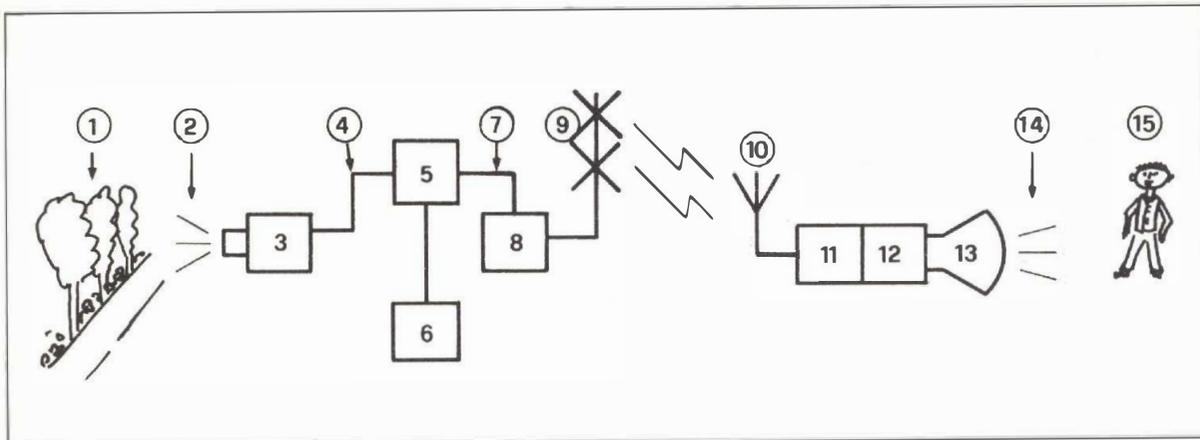
*Rappresentazione schematica del procedimento di trasmissione e visualizzazione dell'informazione in colore. 1, soggetto; 2, informazione ottica; 3, codificatore; 4, informazione elettrica; 5, codificatore; 6, generatore di segnali di sincronismo; 7, segnale video composto in colore; 8, trasmettitore; 9, antenna trasmittente; 10, antenna ricevente; 11, 12, 13, televisore; 11, amplificazione del segnale; 12, decodificazione; 13, cinescopio a colori; 14, informazione ottica; 15, telespettatore.*
