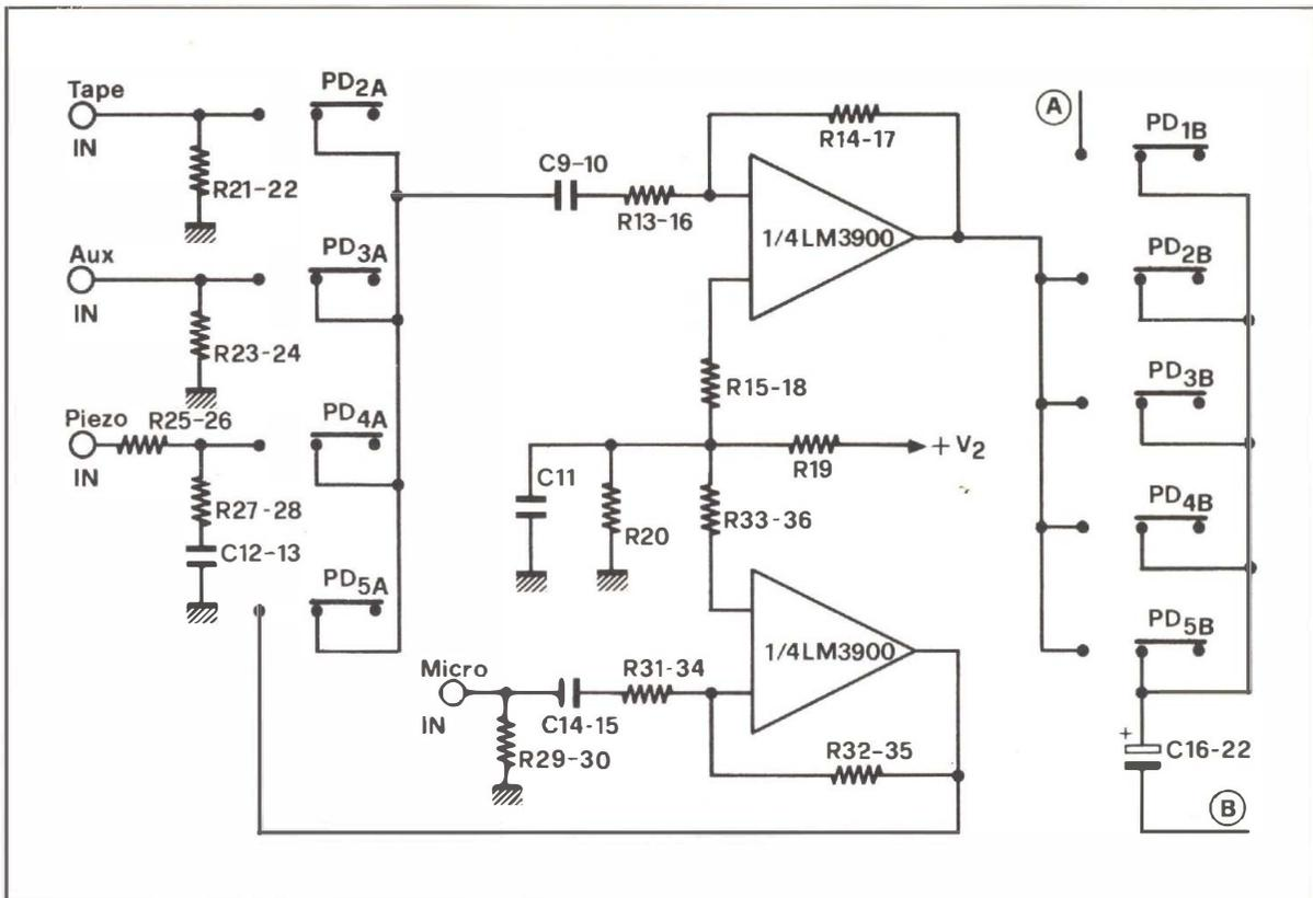
come si tratti di un amplificatore operativo del tipo « differential input/single output » munito di due terminali (pin 9,10) ai quali è possibile collegare una rete esterna per la compensazione in frequenza.
