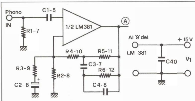
*Schema elettrico della sezione di preamplificazione inerente all'ingresso phono: utilizza un LM 381. Essendo l'amplificatore stereofonico occorrono due stadi di questo tipo perfettamente simmetrici: la doppia numerazione ai componenti caratterizza questo fatto.*
