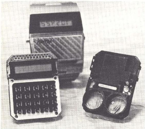
usare un display a cristalli liquidi. Oltre ad un display continuo di sei cifre per ore/minuti/secondi, l'unità è dotata di un calendario mese/data, un indicatore AM/PM e di luce per la lettura al buio. Funzionamento come calcolatore, impiega la logica algebrica.
