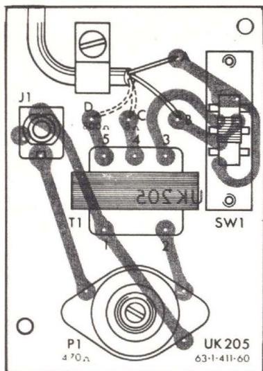
*Piano generale per l'allestimento del dispositivo. I componenti da saldare alla basetta sono in numero limitato e nessuno di questi è particolarmente sensibile al calore, anche una persona alle prime armi può realizzare l'apparecchio con la garanzia di un sicuro successo.*
