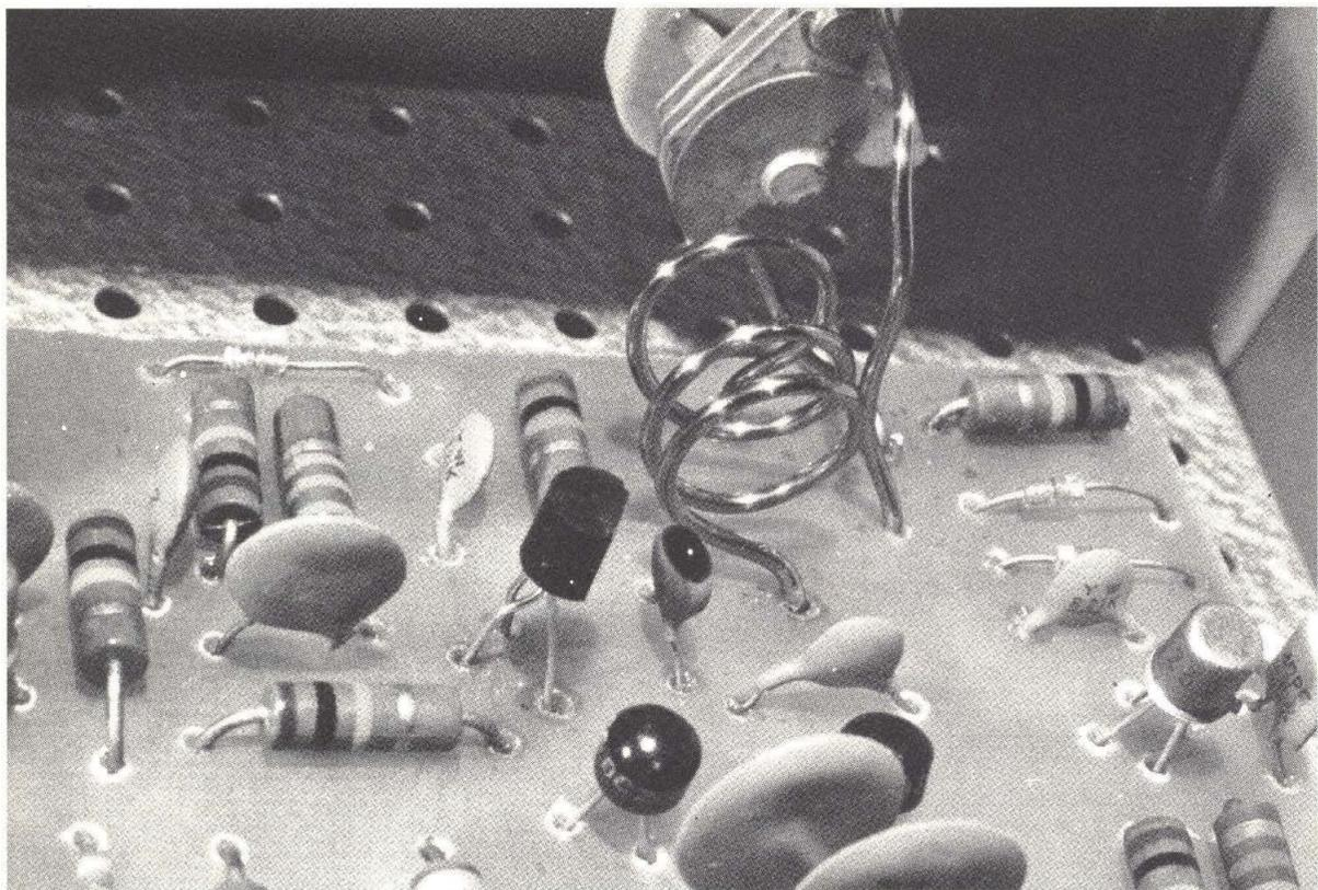
reattivo che fa capo al transistor T2, un elemento NPN del tipo BF199. Anche questo transistor è montato nella configurazione a base comune; per i segnali alternati infatti, la base è cortocircuitata a massa dal condensatore C6.
