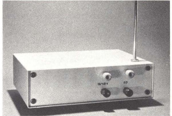
l'altoparlante e la presa per l'alimentazione esterna. L'antenna, se montata direttamente sul contenitore come nel nostro prototipo, dovrà essere isolata elettricamente dal contenitore per evitare che il segnale a radiofrequenza venga cortocircuitato a massa tramite il contenitore. Il nostro prototipo utilizza una piccola antenna a stilo; un'antenna montata sul tetto consente di migliorare la sensibilità del ricevitore ma non in misura da com-
