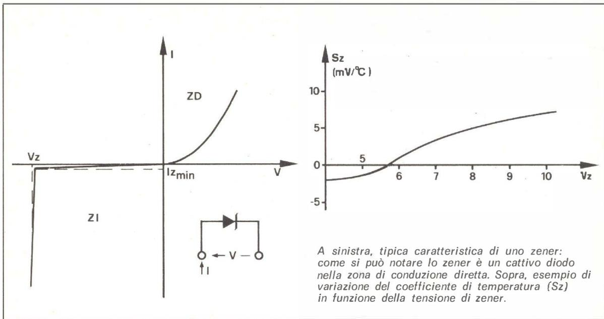
A sinistra, tipica caratteristica di uno zener: come si può notare lo zener è un cattivo diodo nella zona di conduzione diretta. Sopra, esempio di variazione del coefficiente di temperatura ( $S_z$ ) in funzione della tensione di zener.
