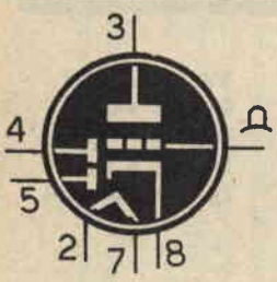
12Q7 DOPPIO DIODO TRIODO RIV. AMPL. BF (zoccolo octal)
