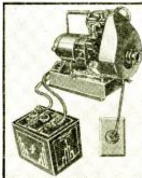
A 300-W. power plant. (1109)
