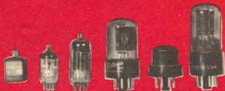
Elementi attivi di un voltmetro elettronico. I modelli comuni generalmente usano una serie comprendente (da sinistra a destra): un raddrizzatore al selenio per l'alimentazione da 50 mA, una 6AL5 rettificatrice per le misure c.c. e una 12AU7 per il ponte. Un'altra serie comprende una 6X3 raddrizzatrice, una 6HG rettificatrice, una 6SN7 per il ponte
