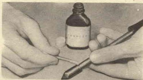
**S**e il vostro saldatore ha la punta avvitata o ha una vite di pressione che tiene a posto la punta stessa, controllate che l'ossidazione non la blocchi. Se ciò è avvenuto, non tentate di svitare le parti con le pinze, poiché danneggereste la punta. Prendete invece un po' di cotone o un pennellino, intingetelo in ammoniacca e applicatelo alla punta com'è illustrato nella foto: in pochi minuti la punta sarà sbloccata.
