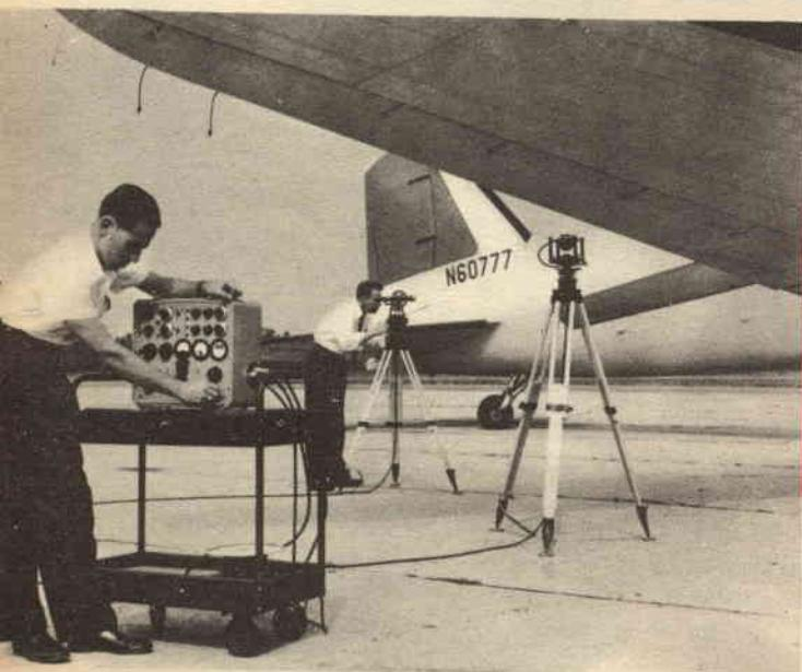
Alcuni ingegneri stanno facendo « ruotare il mondo » intorno ad un aereo fermo, per tarare con precisione il sistema di bussola dell'aereo stesso e compensarne gli errori. Questo metodo permette a due uomini di controllare e di regolare la bussola di un missile o di un aeroplano in 2 ore, mentre prima la stessa operazione richiedeva l'opera di una squadra e una giornata di lavoro.
