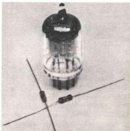
Due diodi economici sono in grado di sostituire una valvola 6AL5; si possono risparmiare così energia dei filamenti e spazio.
