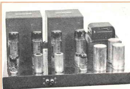
**AF/60** DOPPIA UNITA DI POTENZA PER STEREOFONIA - 30+30 watt nominali - 50+50 watt di punta - risposta da 20 a 30 mila c/s + — 0,5 dB - distorsione massima inferiore all'1% - impedenze di uscita da 4 a 16 ohm - fasatura automatica degli altoparlanti - 8 tubi + 4 raddrizzatori al silicio + 1 raddrizzatore al selenio.
