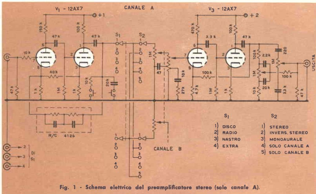
un margine trascurabile e nel contempo assicurare una notevole stabilità di funzionamento. I due gruppi RC inseriti tra l'uscita della seconda sezione di V1 ed il catodo della prima sezione consentono di ottenere l'equalizzazione adatta per l'ascolto dei dischi incisi con il noto e ormai comune sistema RIAA. Completa lo stadio un filtro antifruscio collegato tra l'uscita della seconda sezione di V1 e la massa.
