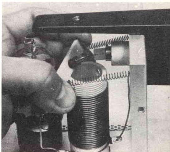
La sostituzione della cella nello Ionovac richiede solo pochi minuti. Per semplificare questa operazione, il costruttore ha sistemato la cella a quarzo su un supporto ceramico che viene tenuto fermo da molle.
