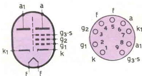
amplificatrice a frequenza intermedia ed è caratterizzata da un'elevata transconduttanza ( $7.800 \mu\text{A}/\text{V}$ , con una corrente anodica di  $12,5 \text{ mA}$ , ad una tensione anodica di  $125 \text{ V}$ ) e da una bassa capacità anodo-griglia controllo ( $0,015 \text{ pF max}$ ). La sezione diodo è adatta come rivelatrice del segnale video.
