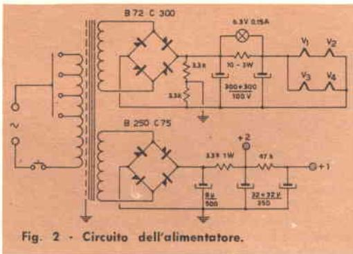
Fig. 2 - Circuito dell'alimentatore.
