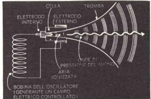
**L'aria ionizzata nella cella a quarzo è il solo elemento generatore del suono nello Ionovac. Una tromba esponenziale amplifica la componente audio del segnale a RF modulato, che viene applicato alla cella a quarzo.**
