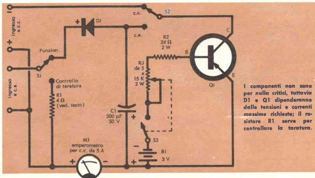
I componenti non sono per nulla critici, tuttavia D1 e Q1 dipenderanno dalle tensioni e correnti massime richieste; il resistore R1 serve per controllare la taratura.
