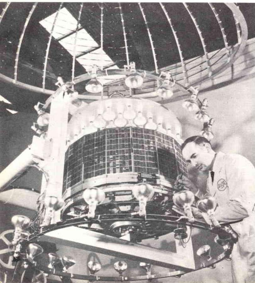
Il sistema di orientamento magnetico sotto prova, presso il Centro Spaziale della RCA a Princeton (New Jersey, U.S.A.). Le lampade che si vedono sopra e intorno al satellite sono usate per controllare il funzionamento delle pile solari che circondano il satellite stesso.
