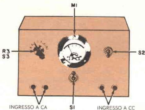
Configurazione del pannello frontale suggerita per il controllo elettronico per CC e CA; si possono sistemare i componenti in qualsiasi scatola metallica di dimensioni adatte.
