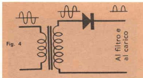
**Raddrizzatore ad una semionda** - Il circuito di *fig. 4*, chiamato raddrizzatore ad una semionda, è il più semplice circuito possibile di raddrizzatore, ma raramente è anche il più efficiente; in esso infatti metà della potenza in corrente alternata non viene usata. Invece, aggiungendovi tre dio-
