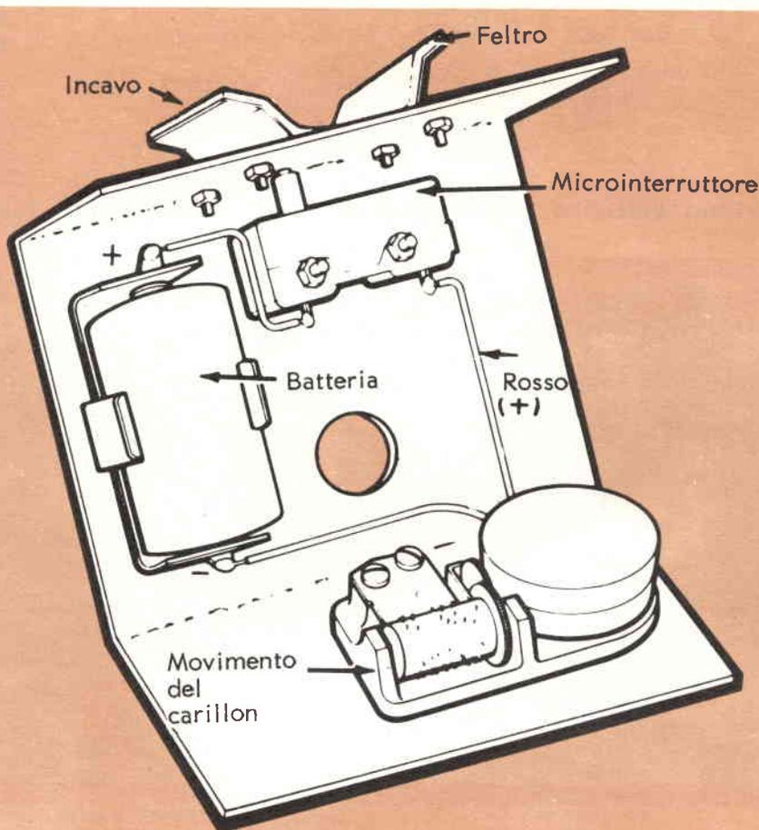
La disposizione dei componenti è semplice e chiara. Il feltro posto sulle staffe di sostegno del microfono evita che le vibrazioni degli ingranaggi si trasmettano al ricevitore. Incollate quattro piedini di gomma al fondo della scatola in modo da proteggere il mobile su cui questa si appoggia. Lubrificate, se necessario, gli ingranaggi.
