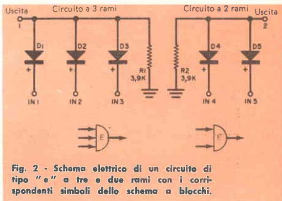
Fig. 2 - Schema elettrico di un circuito di tipo "e" a tre e due rami con i corrispondenti simboli dello schema a blocchi.
