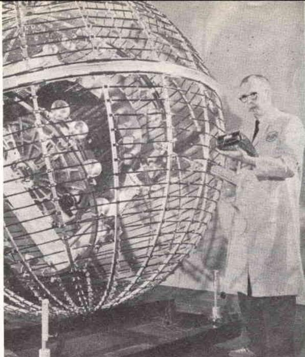
Una gabbia sferica, che riproduce campi magnetici simili a quelli della terra, è stata usata negli esperimenti effettuati prima del lancio del satellite. Nella foto un tecnico della RCA misura il campo magnetico entro la gabbia, preparandosi a far ruotare il satellite sui suoi supporti per studiare il sistema di orientamento.
