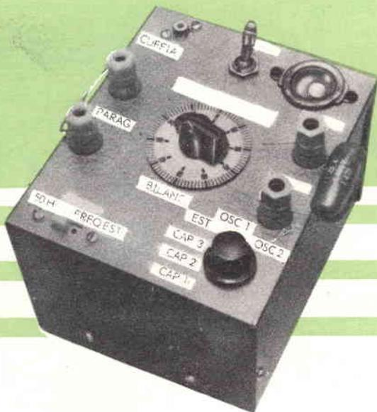
**E**cco un generatore audio, un ponte per resistenza-capacità ed un indicatore di sintonia e modulazione racchiusi in un solo strumento. Questo tester universale di dimensioni ridotte occuperà poco spazio sul vostro banco di lavoro e vi farà risparmiare parecchio tempo nel montaggio e nel controllo di apparecchi autocostruiti. Grazie a questo strumento, potrete facilmente misurare la capacità di condensatori da 10 pF fino a 40  $\mu$ F funzionanti con
