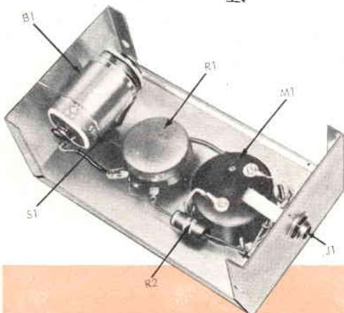
I collegamenti del misuratore di umidità sono molto facili; assicuratevi tuttavia di osservare le polarità esatte nel collegare lo strumento M1 e la batteria B1.
