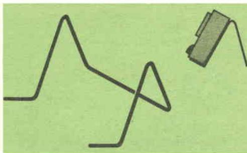
Un conveniente appoggio per uno strumento multiplo o per un voltmetro elettronico si può facilmente formare mediante un robusto filo metallico ricoperto. Foggiate il filo in modo tale da potervi appoggiare contro lo strumento e ricopritene le estremità mediante nastro di plastica in modo da evitare che esse raschino o comunque danneggino lo strumento. Questo appoggio sosterrà lo strumento con buona stabilità e con una pendenza adatta per una facile lettura.
