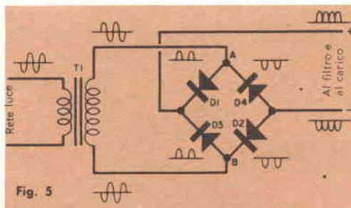
Quando la tensione al punto A di *fig. 5* è positiva, la tensione al punto B sarà negativa perché la fonte di energia è, come abbiamo detto, alternata. Gli elettroni scrono dal punto B attraverso il diodo D2 per giungere al filtro ed al circuito di utilizzazione, mentre sono bloccati da D3 e D4 in quanto la resistenza inversa di questi diodi è elevata. Dal carico e dal filtro gli elettroni ritornano indietro attraverso il diodo D1 per giungere nuovamente al punto A.
