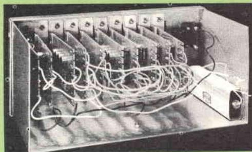
Vista esterna ed interna di un'economica calcolatrice binaria portatile costruita con elementi DigiBit. Per le interconnessioni fra i vari elementi sono utilizzati connettori ad attacco rapido che non necessitano di saldatura.
