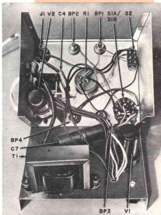
Vista della custodia in alluminio con il telaio a parte; i controlli dell'apparecchio sono montati sulla parte superiore della scatola, mentre la valvola V1, il trasformatore T1 e la maggior parte dei piccoli componenti sono sistemati sul telaio.
