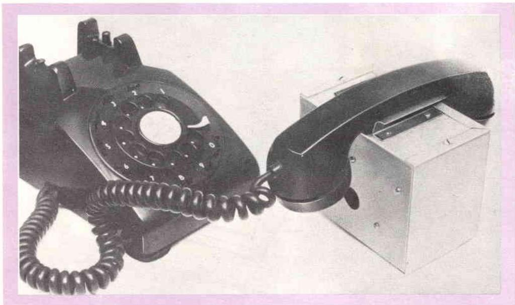
Un microinterruttore posto dentro la scatola controlla il movimento del carillon, mantenendolo in funzione finché non si solleva il microtelefono.
