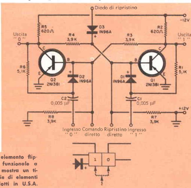
Fig. 1 - Circuito elettrico di un elemento flip-flop tipo DigiBit e suo schema funzionale a blocchi (a destra). La foto sopra mostra un tipico elemento flip-flop di una serie di elementi digitali, di costo moderato, prodotti in U.S.A.
