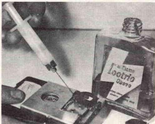
Se occorre un liquido per pulire un controllo di volume e non se ne ha a disposizione, può servire allo scopo una delle lozioni alcoliche che si usano prima di radersi. Queste lozioni servono quanto i normali preparati di tipo commerciale e hanno anche il vantaggio di essere profumate. Il miglior modo per applicare la lozione al controllo rumoroso è di usare una siringa per iniezioni, una pompetta contagocce od una vecchia penna stilografica.
