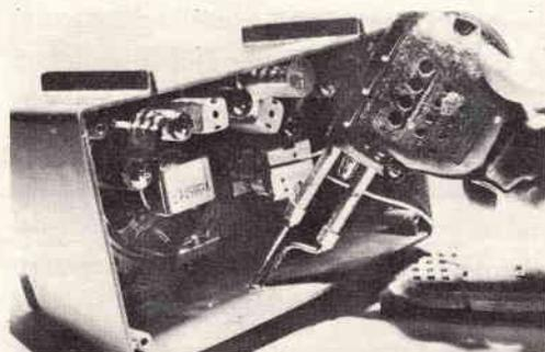
potete riparare i mobili radio in plastica che siano fessurati o incrinati incollando insieme i pezzi mediante un comune saldatore. Lavorando dall'interno del mobile fate sciogliere i margini delle incrinature e riuniteli poi fra loro in numerosi punti. Volendo, in un secondo tempo potete ricoprire questi punti di unione con nastro adesivo.
