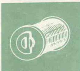
6. Sulle bobine di relé elettromagnetici per corrente continua si trova di solito un anello a forma di D.
