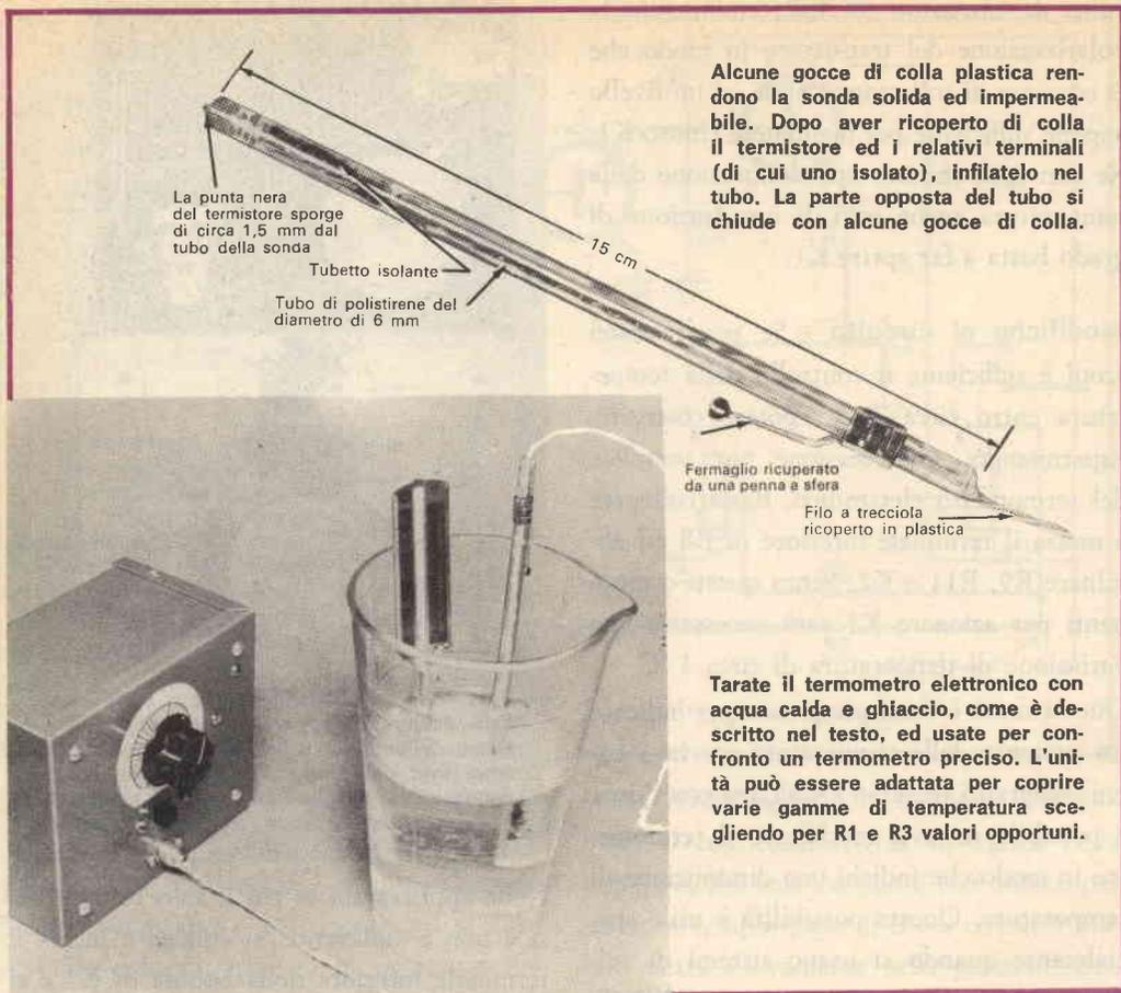
Alcune gocce di colla plastica rendono la sonda solida ed impermeabile. Dopo aver ricoperto di colla il termistore ed i relativi terminali (di cui uno isolato), infilatelo nel tubo. La parte opposta del tubo si chiude con alcune gocce di colla.
