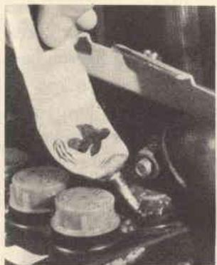
Per le forti variazioni di calore, intorno ai tappi ed ai terminali degli accumulatori si possono produrre incrinature sottili come un capello dalle quali possono fuoriuscire vapori ed acidi che corrodono le connessioni e fanno diminuire in modo anormale il livello dell'elettrolito. Per prevenire questi danni e prolungare la vita degli accumulatori si possono sigillare le fessure con cementante plastico in vendita a poco prezzo in tubetti presso tutte le drogherie.
